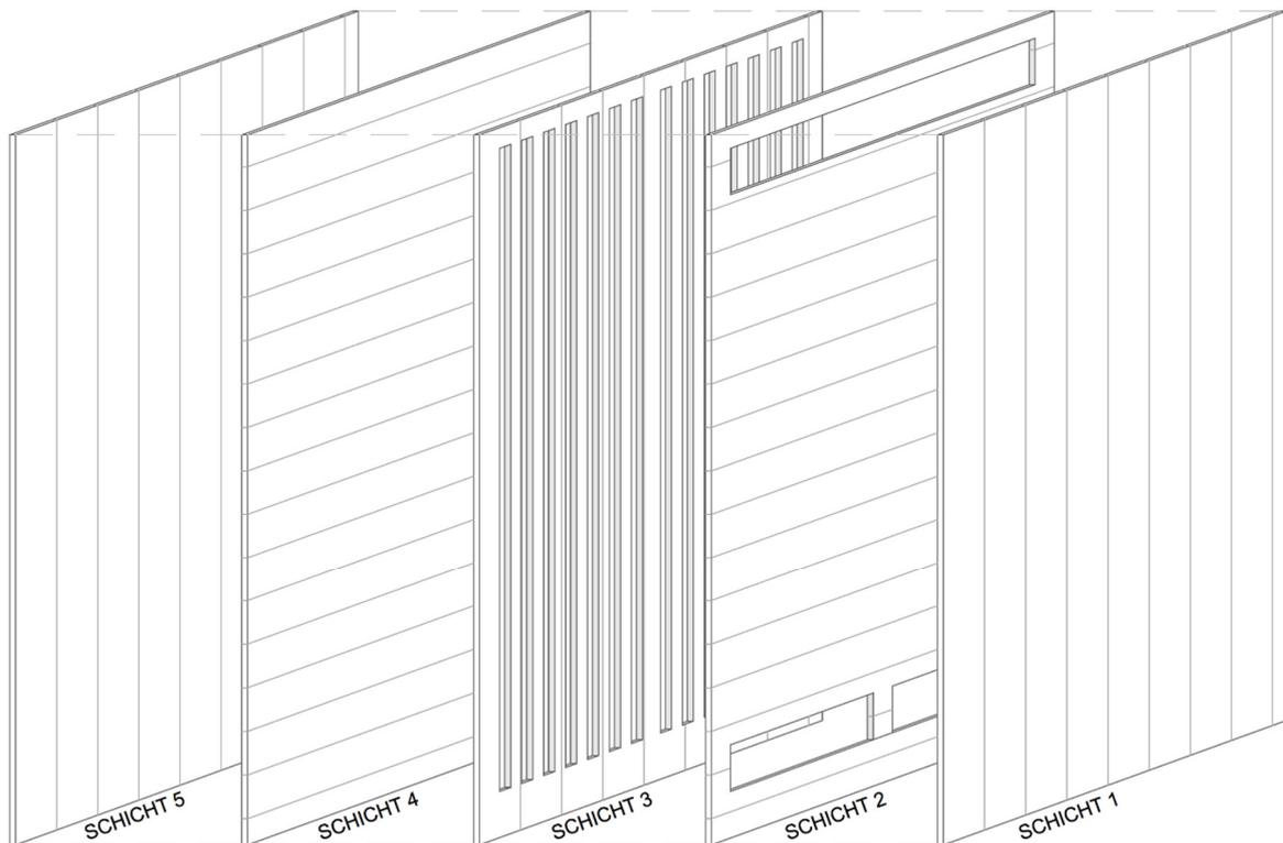
Abbildung 135: Prototyp A mit der Luftführenden Schicht in Brettlamellenlage drei
