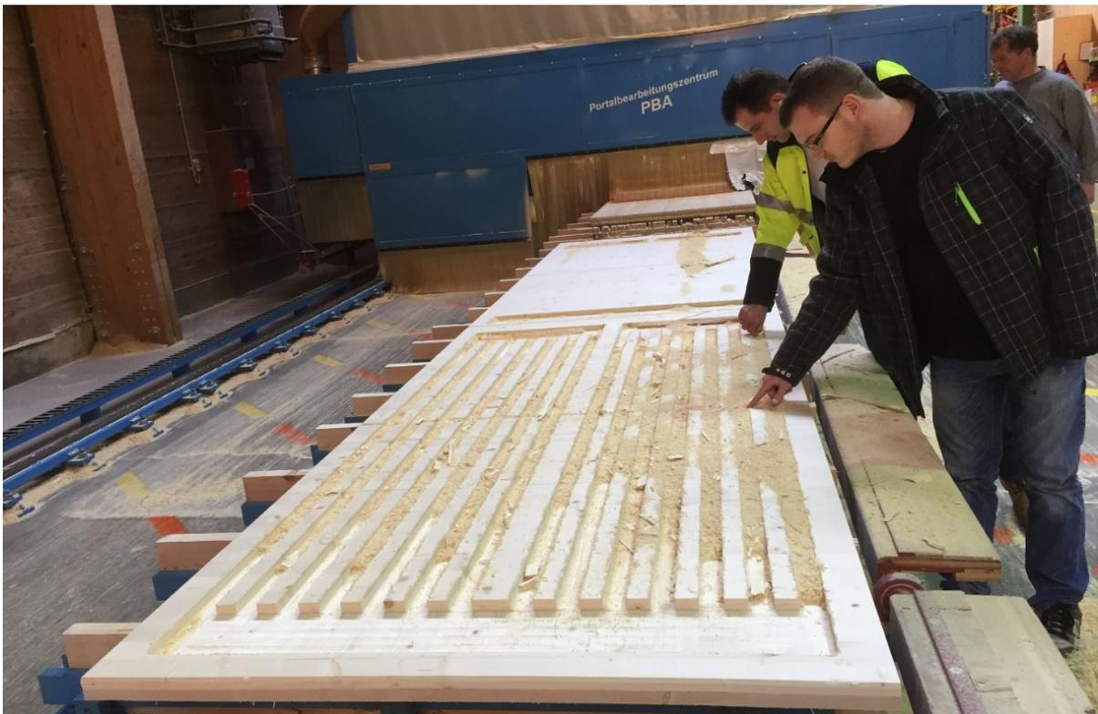
Abbildung 143: Das Fräsen der Kanäle in Schicht zwei hat auch quer zur Faserrichtung dort problemlos funktioniert wo die Lamellen schmalseitenverleimt sind. Als problematisch hat sich der nicht schmalseitenverleimte Stoß zwischen den Massivholzplatten herausgestellt. Siehe Abbildung 145.
