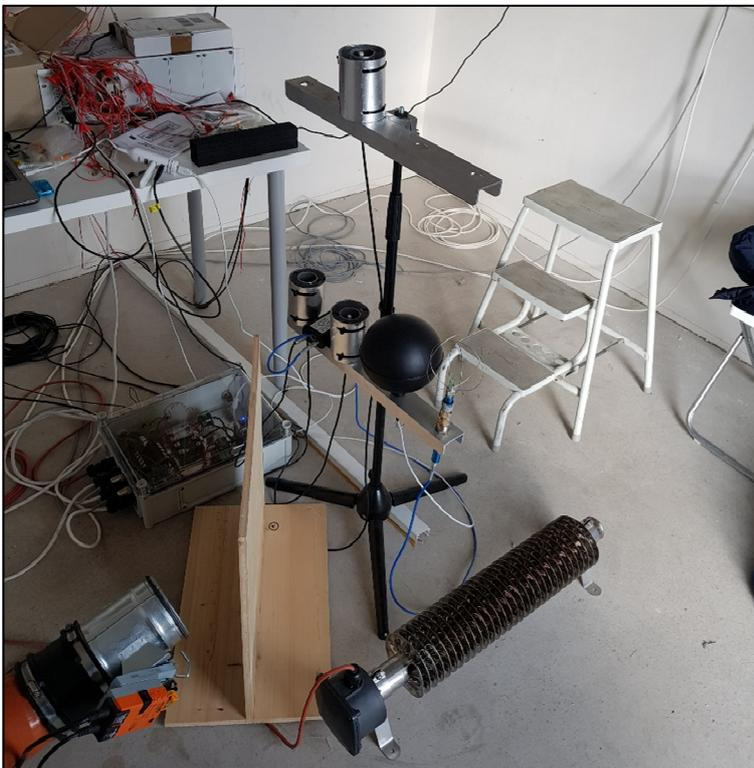
Abbildung 21: Behaglichkeitsmessstand
