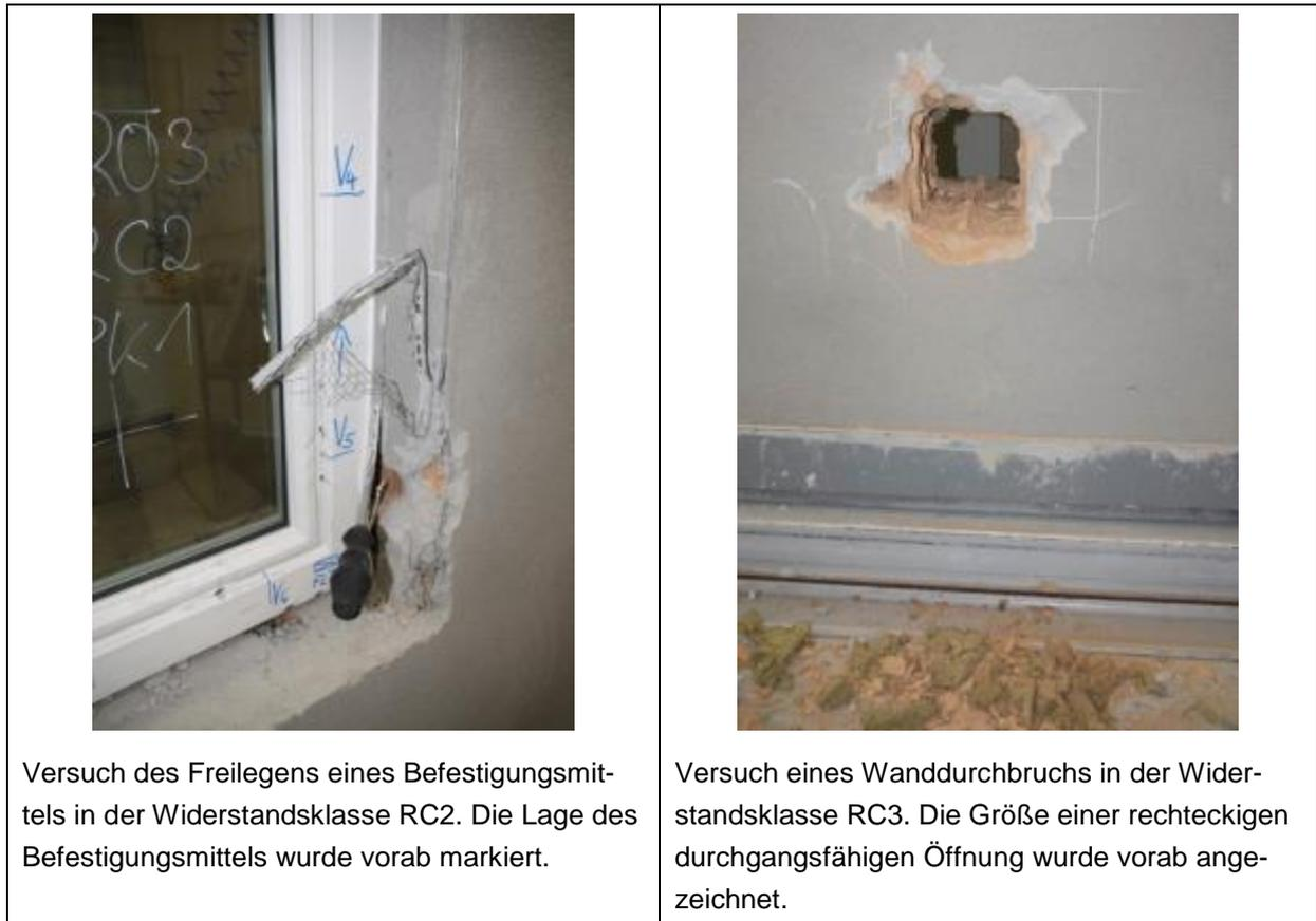
**Abbildung 6** Beispiele von erweiterten Angriffen angelehnt an die manuelle Prüfung nach DIN EN 1630. Links, Angriff auf ein Befestigungsmittel, rechts auf die Wandfläche.
