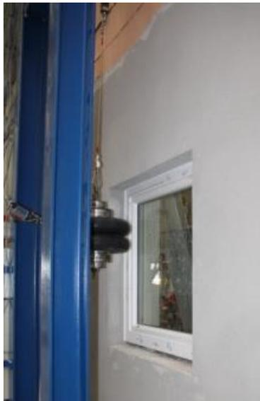
**Abbildung 4** Zwillingssreifen vor einem Probekörper bei der dynamischen Prüfung
