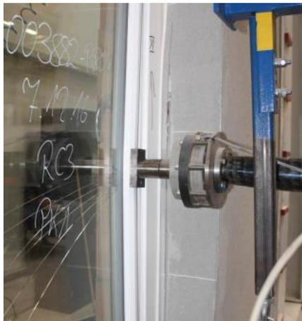
**Abbildung 3** Verformung des Probekörpers unter der Last bei der statischen Prüfung
