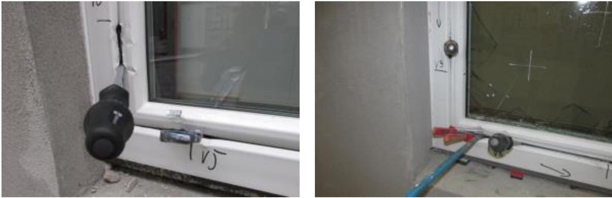
**Abbildung 5** Zwischen Blend- und Flügelrahmen gesetzte (Hebel-)Werkzeuge bei der manuellen Prüfung nach DIN EN 1630 in der Widerstandsklasse RC2 (links) und RC3 (rechts).
