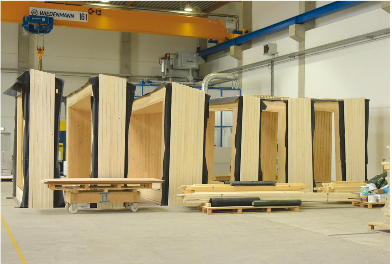
Abb. 27: Sechs fertige Module für den Demonstrator, in ihrer Aufbaureihenfolge aneinandergereiht. Die Aufteilung richtet sich auch nach den maximalen Lasten für die involvierten Kräne und Gabelstapler, sowie die verfügbaren Lastwagen für den Transport.
