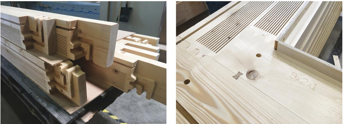
Abb. 15: Fertige Balken und ein Mock-Up der Konstruktion mit einem bei einer Schreinerei gefertigten Eckdetail. Die Verbindung wird nur über eine Verzahnung und die Schwalben-Schwanz-Verbindungen hergestellt.
