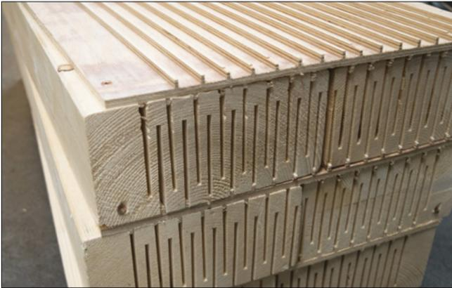
Abb. 5: Physischer Prototyp eines Wandsystems, das von gefrästen Schlüsselbrettern gekrümmt werden könnte. Die Balken erhalten durch die Schlitzung eine hohe Biegefähigkeit.
