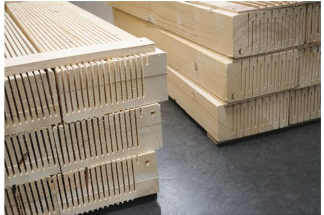
Abb. 12: Erste Prototypen, die eine parametrisierte Verbindung mit Winkeln zwischen den einzelnen Balken testen.
