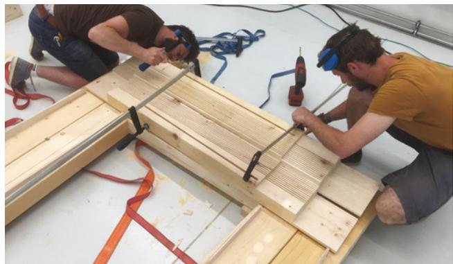
Abb. 34: Zusammenbau eines ersten Prototypen, der einen vollen Rahmen ausbildet.
