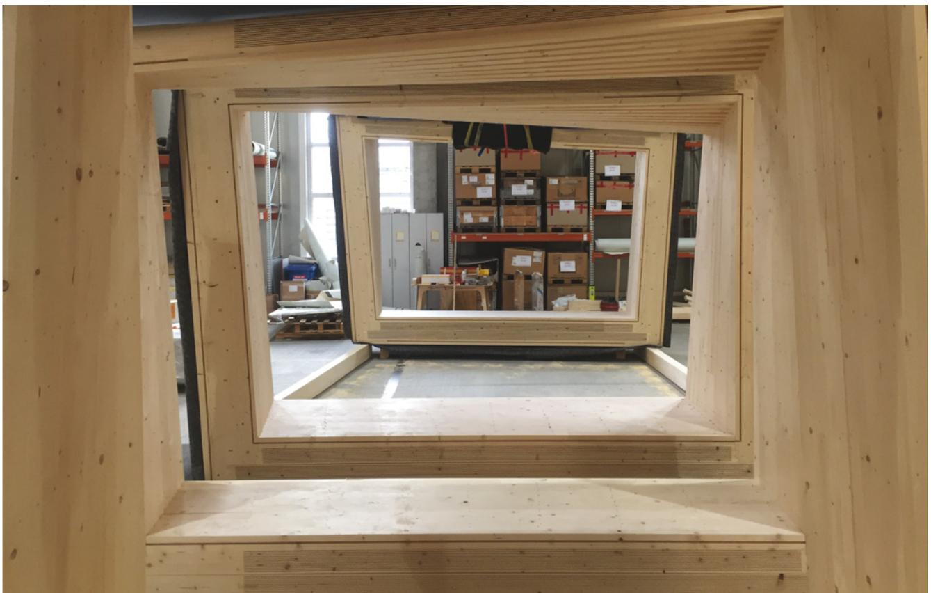
Abb. 29 und 30: Blick durch fertige Module, die nach der Vorfertigung aufgestellt wurden. Die komplexen Regelflächen an den Wänden und der Decke sind hier bereits sichtbar.
