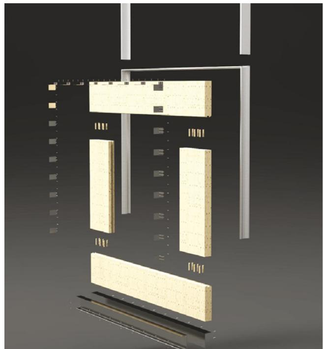
Abb. 21: Explosionszeichnung der Fensterrahmenkonstruktion.
