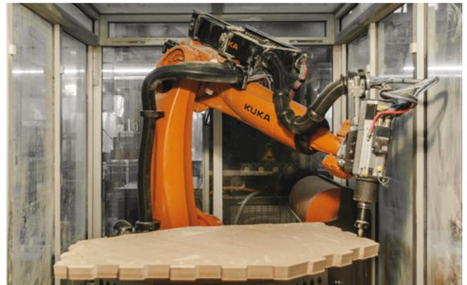
Abb. 3: Robotische Fertigung am Forschungsprojekt "Robotik im Holzbau".
