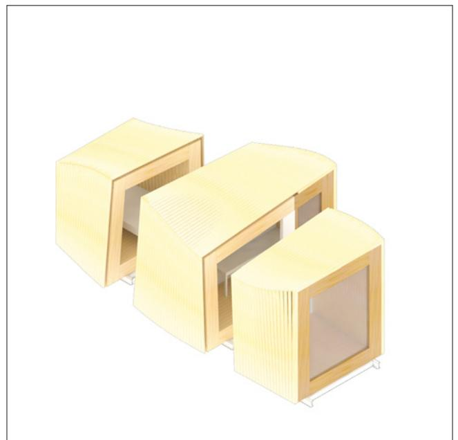
Abb. 28: Konzept und Visualisierung für den Transport und Aufbau der Module. In der Theorie sind die maximalen Maße eines Moduls bei dieser Methode in der Höhe und Länge stark beschränkt, nicht aber in der Breite. Je nach Transportmöglichkeit kann ein Gebäudemodul die Maße eines Schiffcontainers besitzen. Durch die massive Konstruktion ist das Gewicht der Module allerdings entscheidender.
