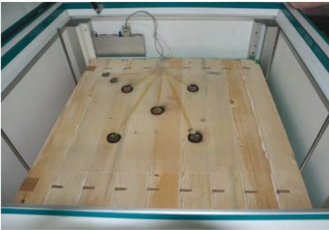
Abb. 19: Prototyp an der MFPA in Weimar zur Messung der Wärmeleitfähigkeit.
