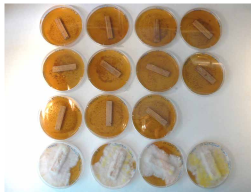
Abb. 2: Befund eines Vitalitätstest: oben und Mitte – keine Pilzauskeimung bei behandelten Proben, unten kräftige Auskeimung bei unbehandelten Kontrollen
