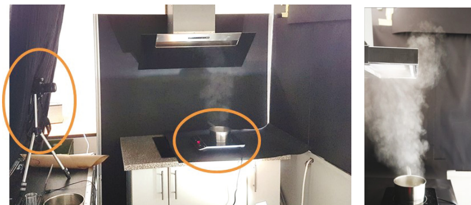
Abbildung 29: Grundsätzlicher Messaufbau der Untersuchung mit Digitalkamera sowie Kochtopf und Kochfeld (rechts). Fotoaufnahme der Dunstabzugshaube während Untersuchung (links).
