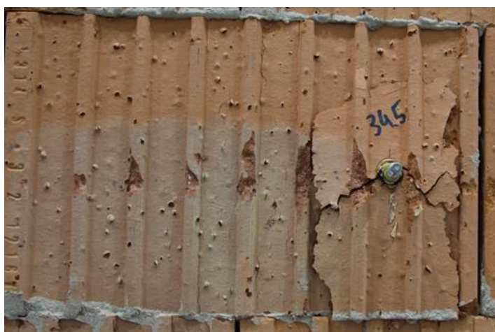
Abbildung 8-45: Versagensbild Stufentest PFZ T24 – 1 Steg Test 5
