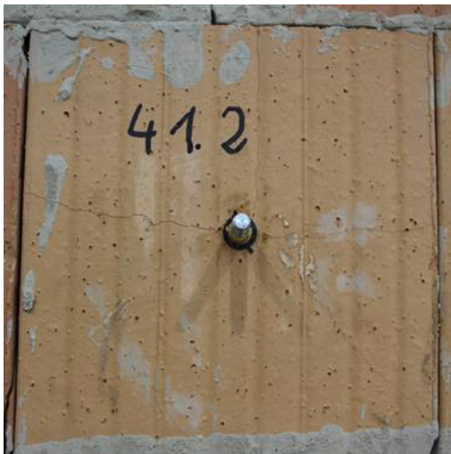
Abbildung 8-11: Versagensbild Ref T8 24 – 2 Stege – Test 2
