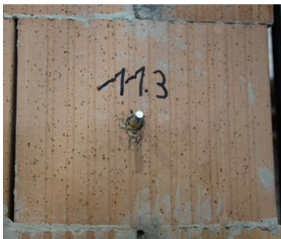
Abbildung 8-9: Versagensbild Ref Plan-T12 – viele Stege – Test 2
