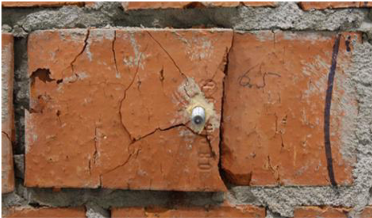
Abbildung 8-34: Versagensbild Stufentest Vollziegel – Mz-2DF, Läufer Test 5
