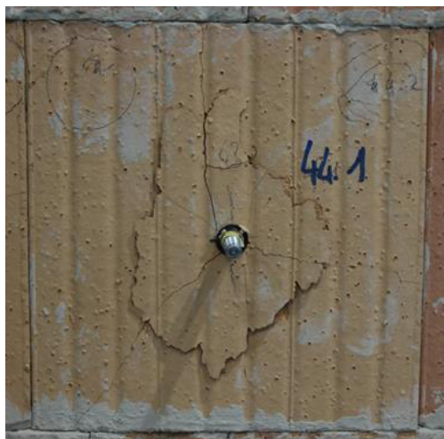
Abbildung 8-38: Versagensbild Stufentest T8 24 – 2 Stege Test 1 & 2
