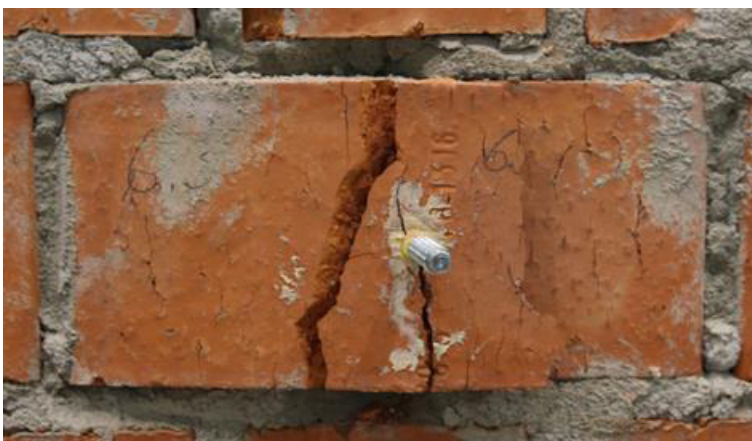
Abbildung 8-32: Versagensbild Stufentest Vollziegel – Mz-2DF, Läufer Test 3
