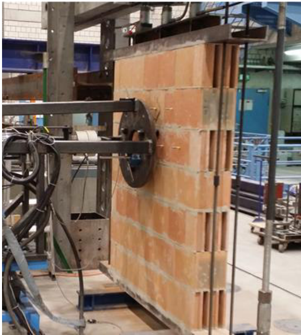
Abbildung 3-6: Aufbau Stufentests TU Kaiserslautern
