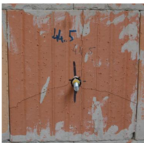
Abbildung 8-40: Versagensbild Stufentest T8 24 – 2 Stege Test 5
