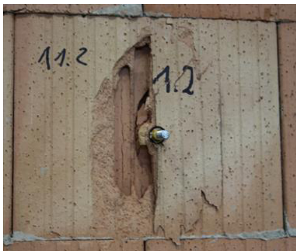
Abbildung 8-8: Versagensbild Ref Plan-T12 – viele Stege – Test 2
