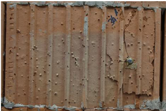
Abbildung 8-41: Versagensbild Stufentest PFZ T24 – 1 Steg Test 1
