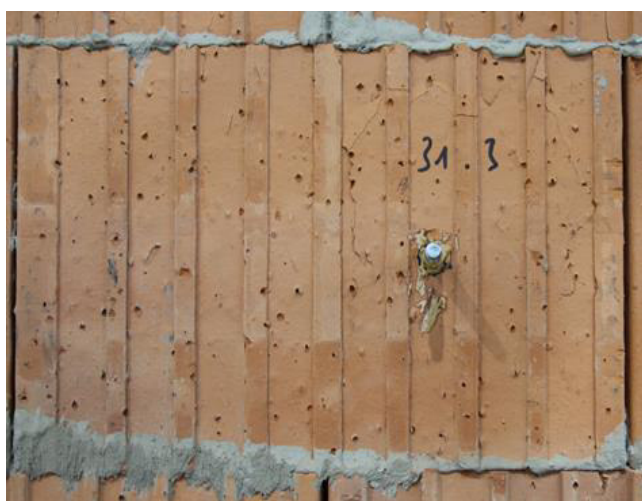
Abbildung 8-15: Versagensbild Ref PFZ-T24 – 1 Steg – Test 3
