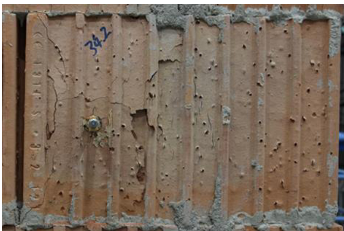
Abbildung 8-42: Versagensbild Stufentest PFZ T24 – 1 Steg Test 2
