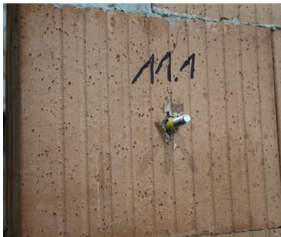
Abbildung 8-7: Versagensbild Ref Plan-T12 – viele Stege – Test 1
