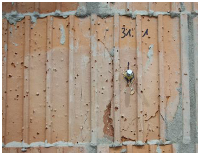
Abbildung 8-13: Versagensbild Ref PFZ-T24 – 1 Steg – Test 1
