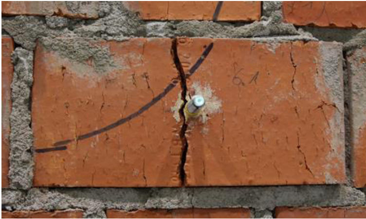
Abbildung 8-30: Versagensbild Stufentest Vollziegel – Mz-2DF, Läufer Test 1
