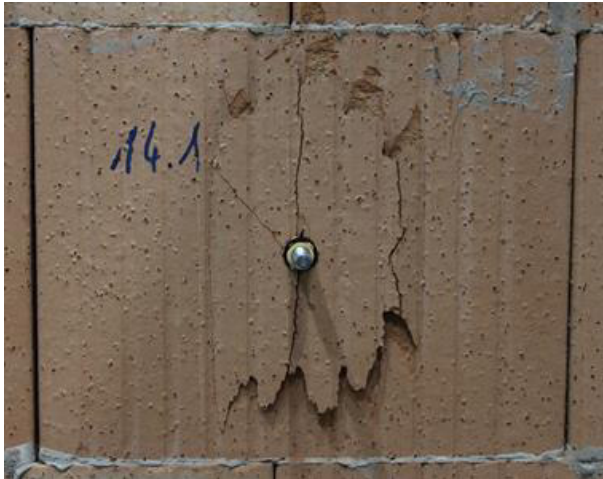
Abbildung 8-35: Versagensbild Stufentest Plan-T12 – viele Stege Test 1 & 2
