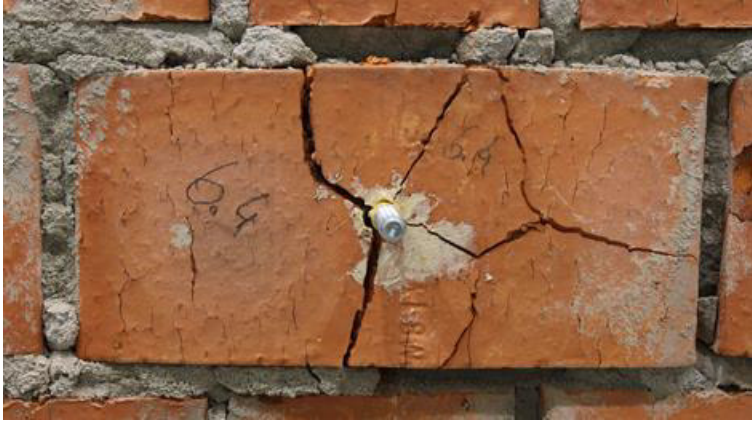
Abbildung 8-33: Versagensbild Stufentest Vollziegel – Mz-2DF, Läufer Test 4
