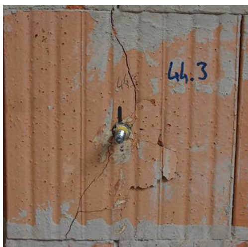
Abbildung 8-39: Versagensbild Stufentest T8 24 – 2 Stege Test 3 & 4
