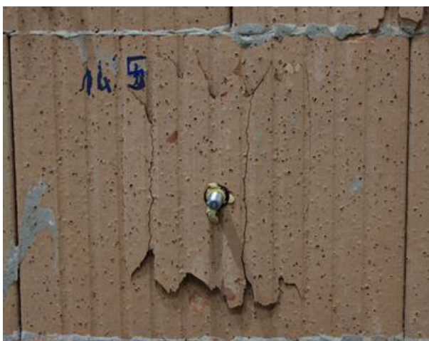
Abbildung 8-37: Versagensbild Stufentest Plan-T12 – viele Stege Test 5
