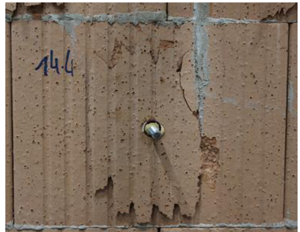
Abbildung 8-36: Versagensbild Stufentest Plan-T12 – viele Stege Test 3 & 4
