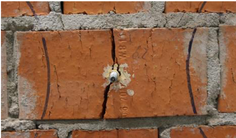
Abbildung 8-31: Versagensbild Stufentest Vollziegel – Mz-2DF, Läufer Test 2
