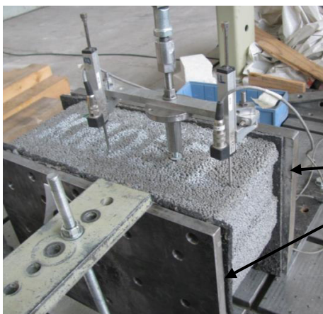
Abbildung 3-3 Detail der Versuchseinrichtung (Metallplatten zur Abspannung)
