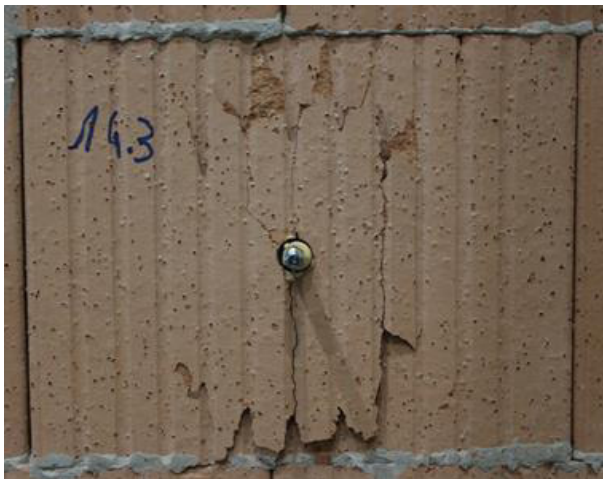
Abbildung 8-36: Versagensbild Stufentest Plan-T12 – viele Stege Test 3 & 4
