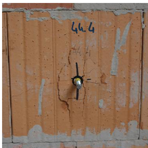
Abbildung 8-39: Versagensbild Stufentest T8 24 – 2 Stege Test 3 & 4
