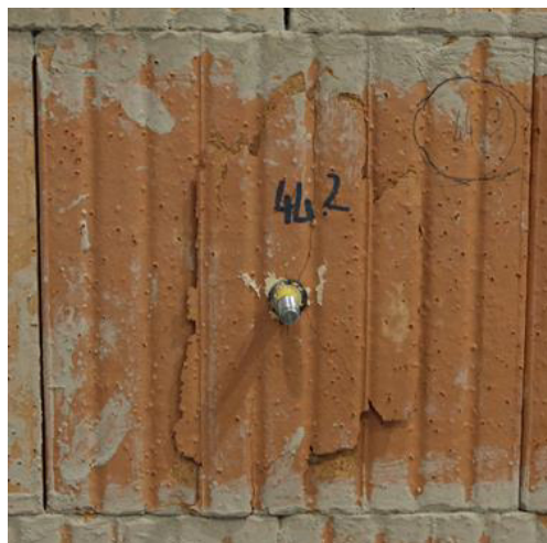
Abbildung 8-38: Versagensbild Stufentest T8 24 – 2 Stege Test 1 & 2
