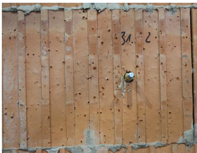
Abbildung 8-14: Versagensbild Ref PFZ-T24 – 1 Steg – Test 2
