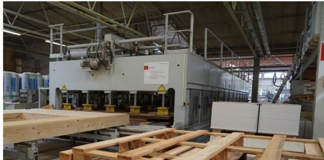
Abbildung 109: Presse zur Aushärtung des Klebers für einen dauerhaften Verbund zwischen Rahmen und OSB-Platten
