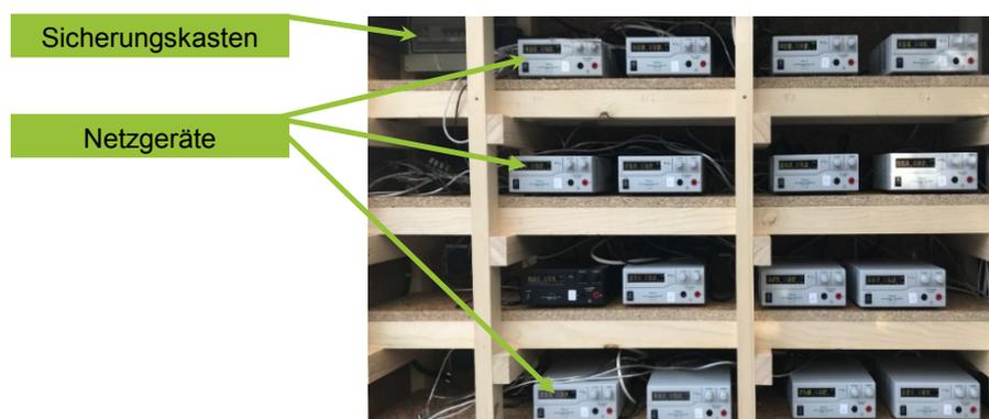
Abbildung 87: Versorgungsanbau mit Netzgeräten und Sicherungskasten
