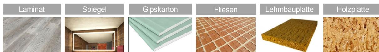
Abbildung 10: Überblick der ausgewählte Basiswerkstoffe zum additiven Auftrag elektrisch leitender Strukturen für Flächenheizsegmente im häuslichen Umfeld
