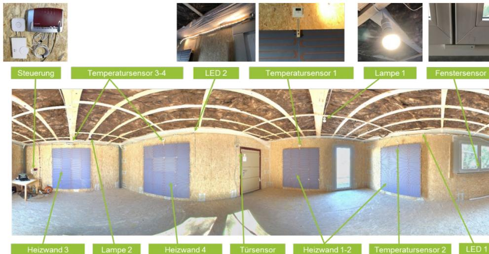
Abbildung 90: Darstellung der verbauten Komponenten im Demonstrationshaus im Überblick
