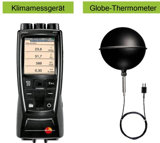
Abbildung 91: Klimamessgerät testo 480 und Globe-Thermometer zur Erfassung der Strahlungswärme [20]
