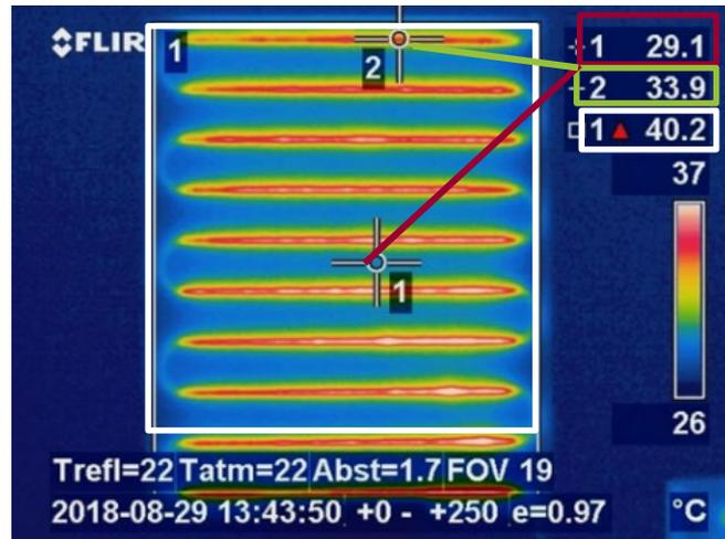
Abbildung 41: Aufnahme mittels Wärmebildkamera einer 40 x 50 cm<sup>2</sup> Platte bei 40 °C Höchsttemperatur innerhalb der gesamten Platte, 33,9 °C im Messpunkt 2 auf der Leiterbahn und 29,1 °C im Messpunkt 1 zwischen zwei Heizstrukturen
