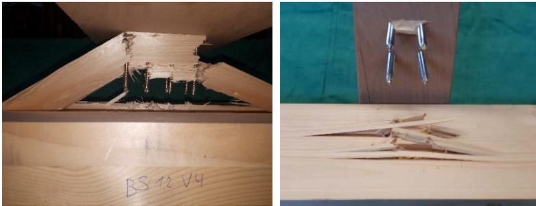
Bild 4-6 kombiniertes Auszieh-Blockscherungsversagen im Prüfkörper BS 1.2 V4 (links) und kombiniertes Auszieh- und Reihenscherungsversagen im Prüfkörper BS 2.1 V3 (rechts)
