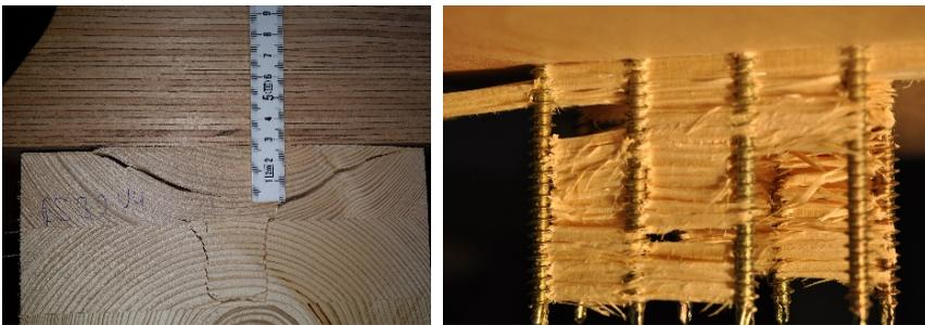
Bild 4-7 Blockscherungsversagen im Prüfkörper BS 3.2 V4 (links) und Reihenscherungsversagen im Prüfkörper BS 1.2 V1 (rechts)
