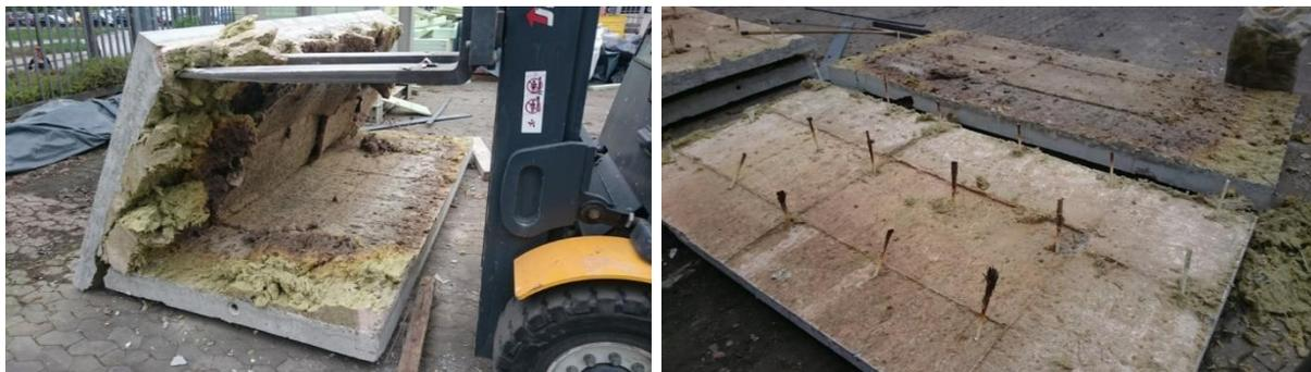
Abbildung 20: Ausbau der Sandwichwand (links) zur Untersuchung der Kernschicht des Brandversuches 3, thermische Beschädigungen der GFK-Verbindungsmittel (rechts)
