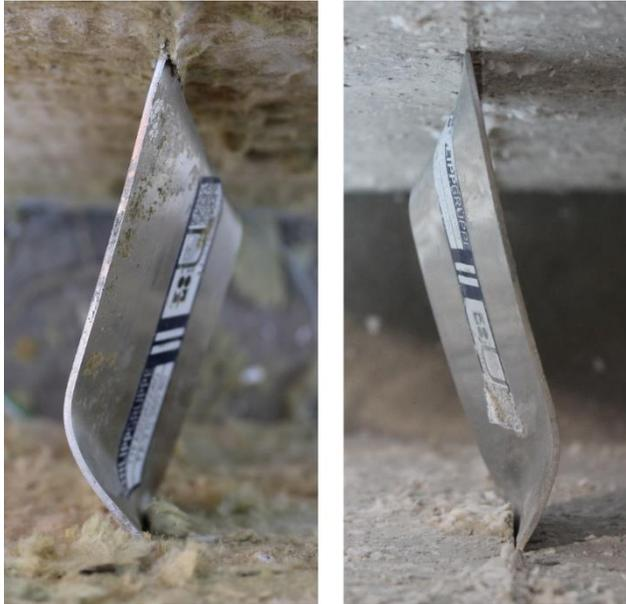
Abbildung 35: Charakteristisches Versagensbild eines Flachankers; im EPS Versuch E-F-84 (links) und in der Mineralwolle Versuch M-F-R1 (rechts)
