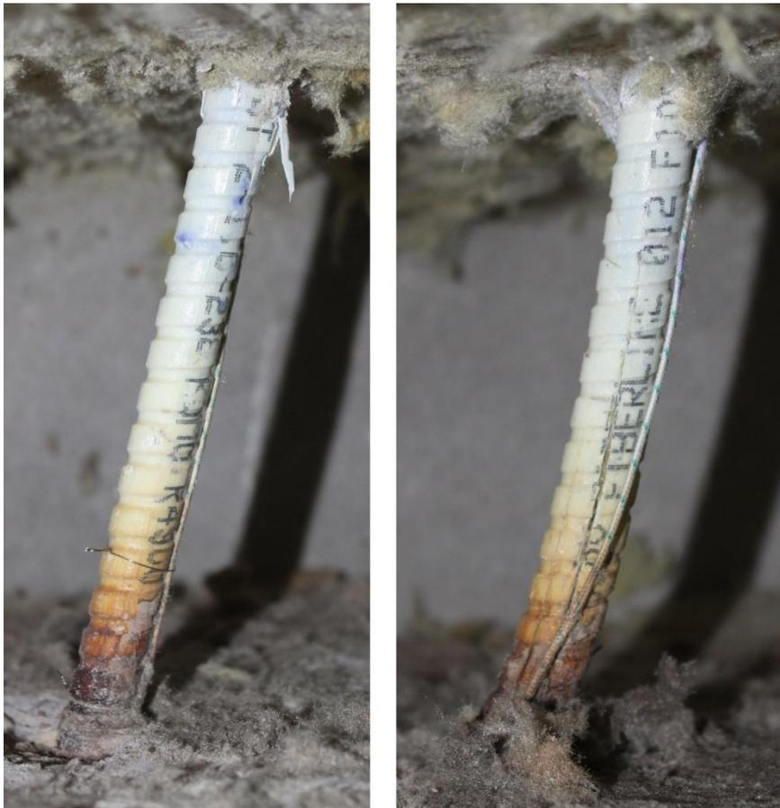
Abbildung 37: Versagensbild der GFK-Verbindungsmitel nach dem Abkühlen des Versuchskörpers (M-P-178). Die Stäbe sind teilweise verkohlt und die Längsrisse konzentrieren sich im unteren Bereich.
