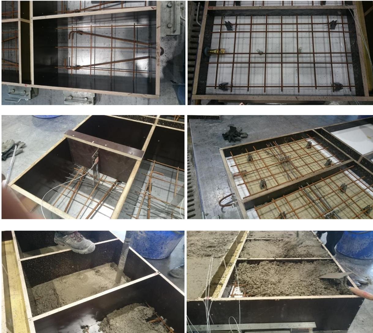
Abbildung 30: Herstellung der Versuchskörper; verschiedene Stadien
