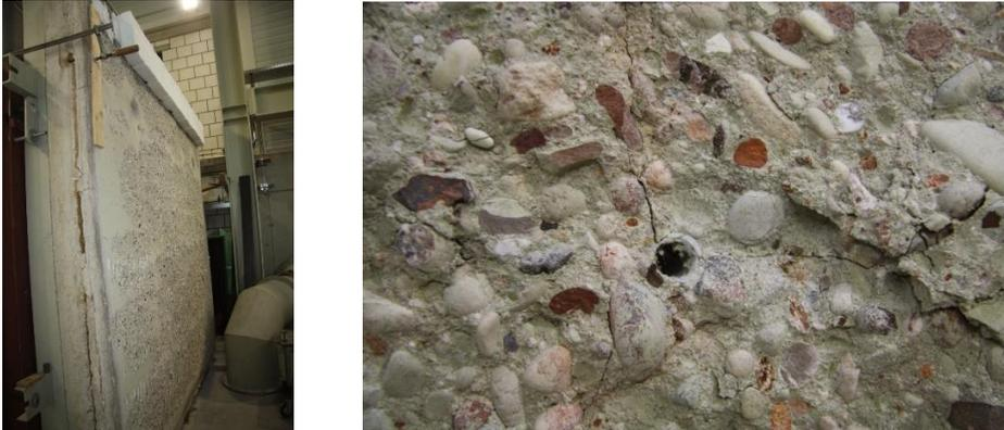
Abbildung 24: Verwölbte Vorsatzschale nach dem Brand (links) und Fehlstelle durch ein geschmolzenes Verbindungsmittel (rechts) beim Versuch 2
