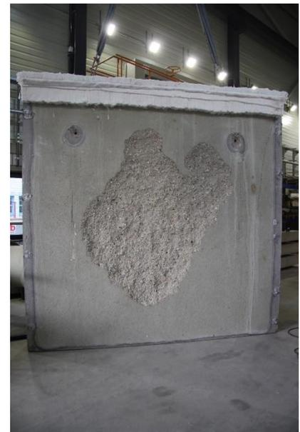
Abbildung A 2: Beflammte Seite nach der Abkühlung
