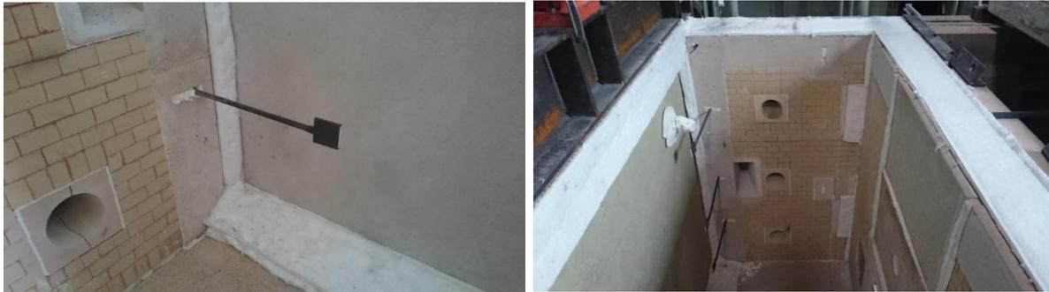
Abbildung 10: Innenraum des Brandofens, Abdichtung und Ofen-Thermoelemente (Versuch 1)
