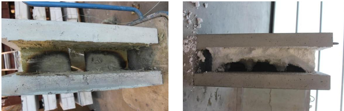
Abbildung 39: Thermische Beschädigung des Dämmstoffes nach dem Abkühlen des Versuchskörpers; Längsschnitt durch den Versuchskörper M-F-437 (links) und Versuchskörper E-P-129 (rechts)
