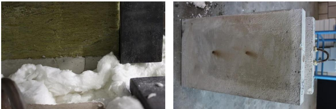
Abbildung 34: Risse in der unteren Betonschale, exemplarisch für Versuch M-F-512 (links). Spuren der GFK Verbindungsmitel auf der unteren Seite der beflaminten Schale des Versuchs E-P-129 (rechts)
