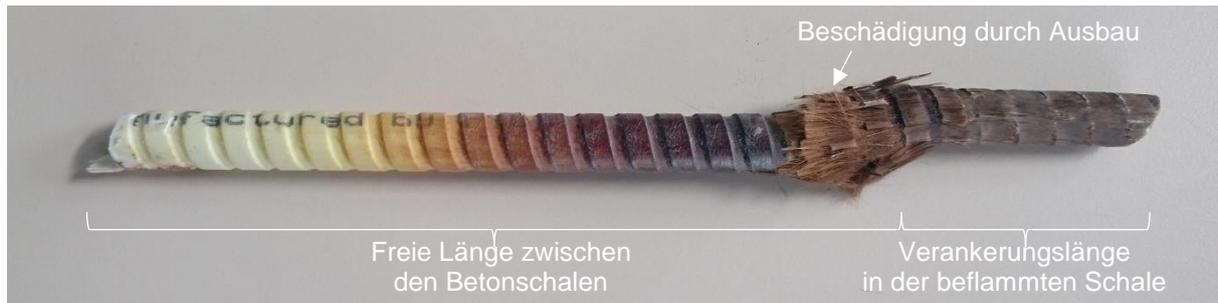
Abbildung 21: Ausgebautes Verbindungsmittel aus Versuchskörper 3 nach dem Brandversuch
