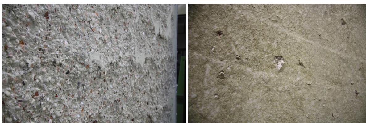
Abbildung 23: Beflammte Betonoberfläche nach dem Brand und Betonabplatzung (links) und ohne Betonabplatzung (rechts)
