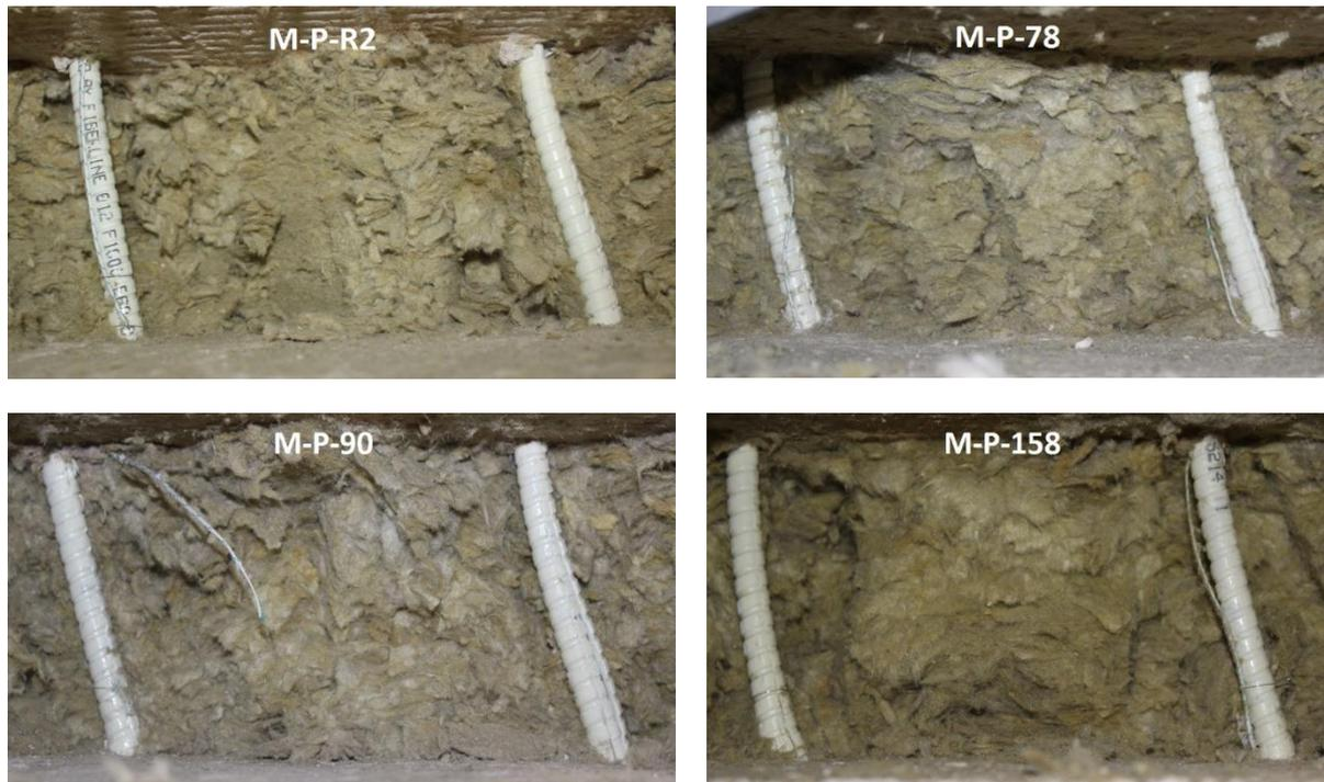
Abbildung 36: Vergleich der Versagensbilder verformter GFK-Verbindungsmitel direkt nach dem Schubversuch
