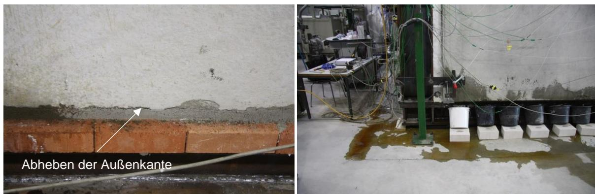
Abbildung 16: Prüfbeobachtungen; Verdrehen an der unteren Kante (Versuch 2) (links) und Austritt von Wasserdampf (Versuch 1) (rechts)
