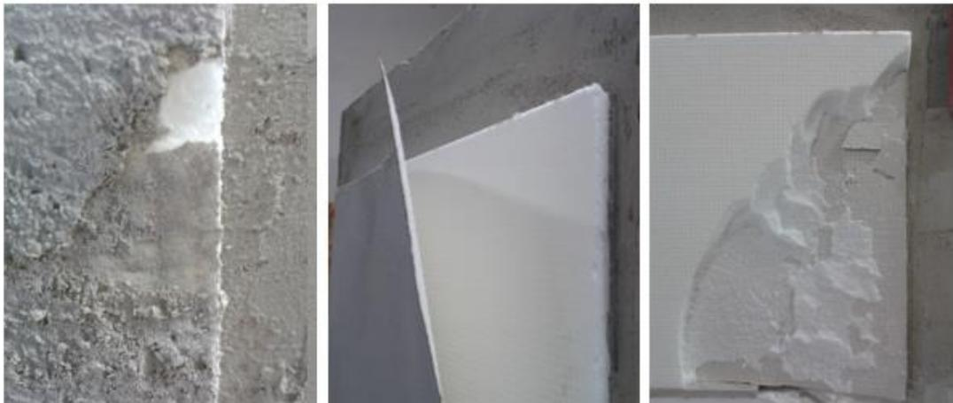
**Abbildung 63** Merkmale des selektiven Rückbaus für Material A.4. Links: Ablöseversuch der oberen Mörtelschicht vom der Vlies-Deckschicht mit Materialverlust, Ansicht von vorne auf die Wand. Mitte: Abziehen der Deckschicht mit oberer Mörtelschicht. Rechts: stückweises Abstoßen des Materials nach abgelöster Deckschicht und Verbleiben der unteren Deckschicht an der Wand.
