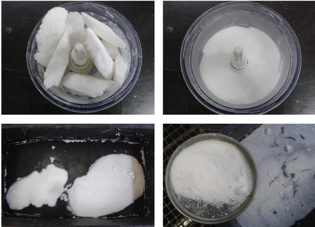
**Abbildung 68** Zerkleinerung und Sedimentation der Bruchstücke von A.4. Oben links: Bruchstücke im Multizerkleinerer vor Zerkleinerung. Oben rechts: Zerkleinerte Bruchstücke. Unten links: Zerkleinertes Material auf Wasserbad. Unten rechts: nach durchmischen des schwimmenden Materials ist keine Benetzung vorhanden, Abschöpfen mit Sieb funktioniert sehr gut.
