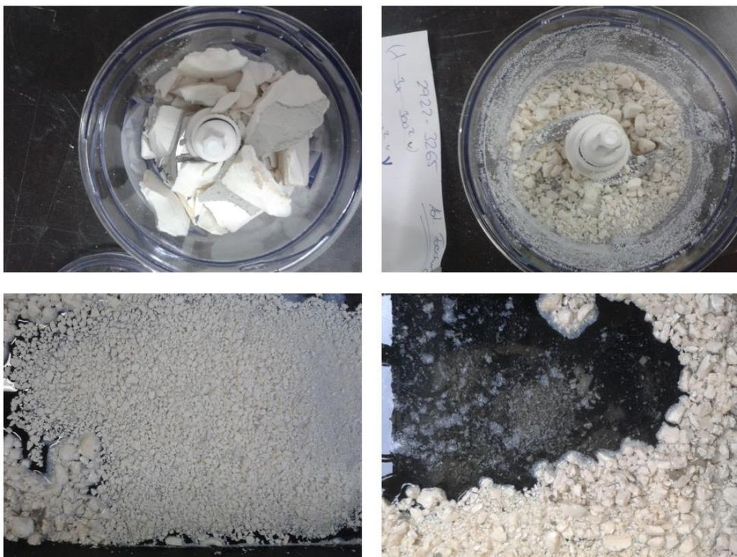
**Abbildung 67 Zerkleinerung und Sedimentation der Bruchstücke von A.2. Oben links: Bruchstücke im Multizerkleinerer vor Zerkleinerung. Oben rechts: Zerkleinerte Bruchstücke. Unten links: Zerkleinerte Bruchstücke auf Wasserbad. Unten rechts: nach durchmischen des schwimmenden Materials sind am Boden der Wanne sedimentierte Partikel sichtbar.**
