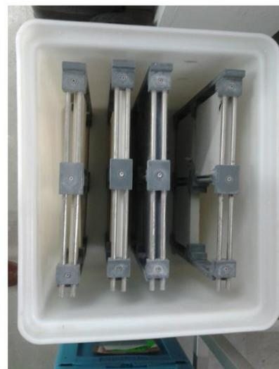
**Abbildung 27 Zyklus zur Frost-Tauwechsel-Beanspruchung und Einbau der Proben in die Halterungen**
