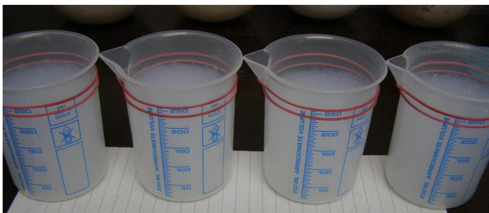
Abbildung 58 Probengefäße zur Durchführung der Tests zur Ermittlung der Stampfdichte
