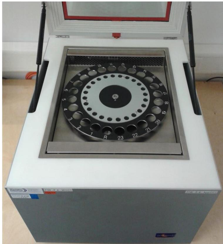
**Abbildung 25 Sorptionsanalysegerät zur Bestimmung der Sorptionsisothermen mit drehbarem Multi-Probenteller zur Wägeposition im hier Bild bei Probe R**
