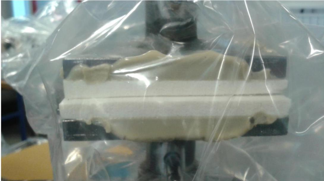
**Abbildung 42 Probekörper in der Zugprüfmaschine mit Versagen des Materials in Probenmitte**
