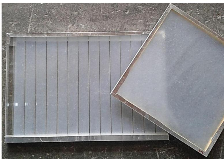
**Abbildung 29** Probekörper zum Einbau in das Q-UV Schnellbewitterungsgerät. Links: PMMA-Steckplatte mit Aerogelgranulat gefüllt. Rechts: Aerogel im Scheibenzwischenraum von Fensterglas
