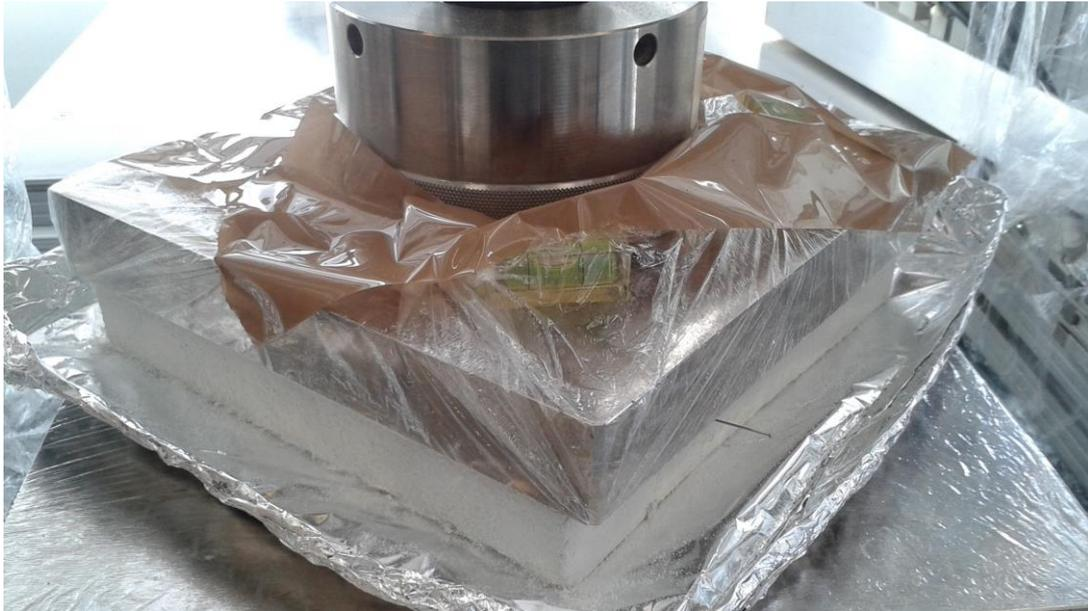
**Abbildung 44** Probe während der Prüfung des Verhaltens bei Druckbeanspruchung
