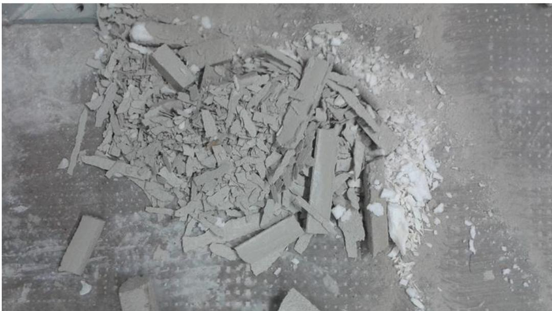
**Abbildung 65** Restmaterial aus Armierungsmörtel und Dämmstoff der drei verwendeten Produkte, das keinen weiteren Trenn- und Aufbereitungsverfahren unterzogen wird.
