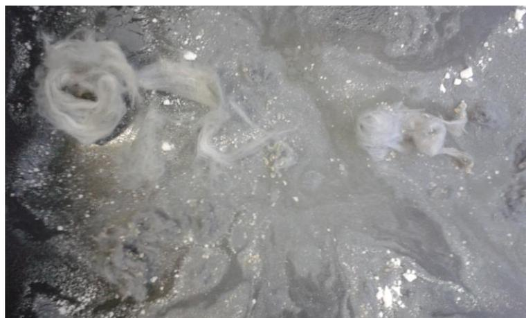
**Abbildung 69** Sedimentation der Bestandteile von A.3. Aerogelpartikel und Faseranteil schwimmen auf dem Wasser und benetzen sich nicht
