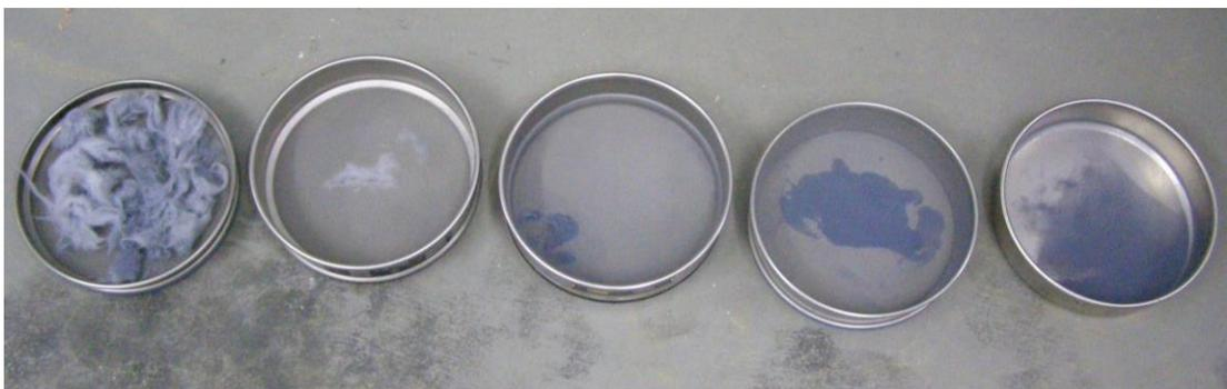
**Abbildung 72 Siebrückstände der Probe A.3 nach Rütteldauer von 10 Minuten: Abnehmende Maschenweite der Siebe von links nach rechts, ganz rechts Auffangschale**
