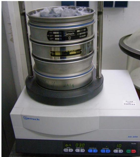
**Abbildung 70 Versuchsaufbau der Siebanalyse zur Trennung der Fasern von den nanoporösen Partikeln**
