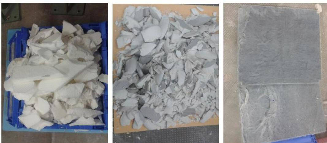
**Abbildung 66** Materialfraktionen nach dem selektiven Rückbau. Links: A.4. Mitte: A.2. Rechts: A.3.
