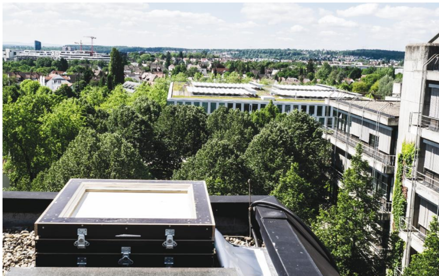
Abbildung 4.14: Prüfkasten des Dachprüfstandes, Pfaffenwandring 7, Stuttgart
