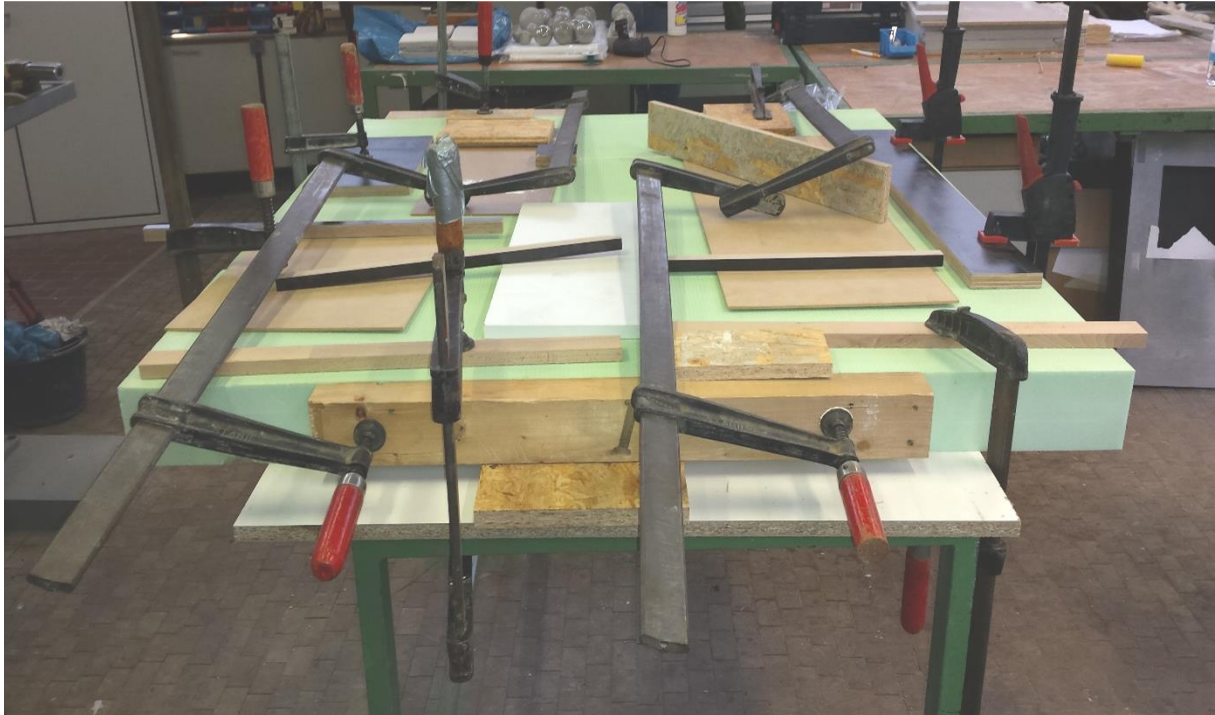
Abbildung 4.4: Referenzprobekörper während des Aushärtens des Klebstoffes
