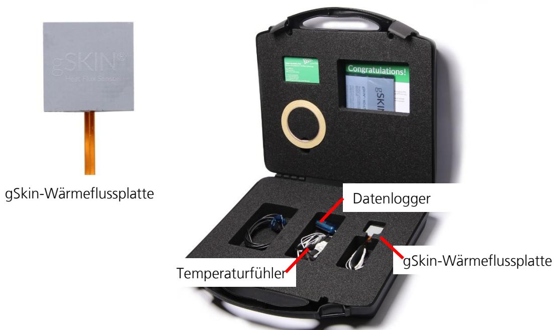
Abbildung 9.1: Koffer mit greenTEG-gSKIN KIT-2615C-Komponenten, bestehend aus Datenlogger, Sensoren und Zubehör (Quelle: greenTEG AG)
