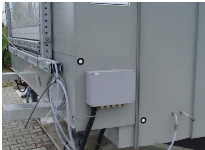
Bild 26: Druckluftversorgung für die Membrankissen. Aktuell ist ein zweilagiges Kissen installiert, das nur eine der beiden verfügbaren Druckluftversorgungen benötigt.
