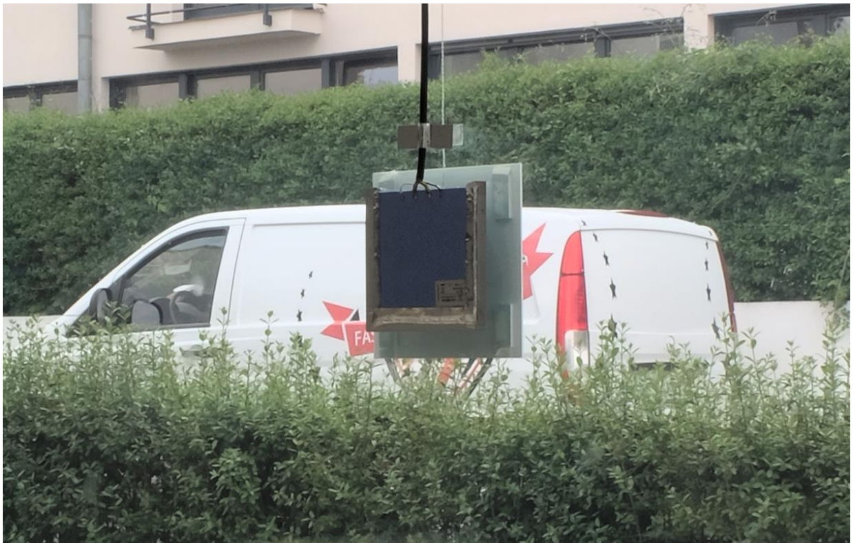
Abbildung 4.35: Detailansicht einer Wärmeflussplatte mit äußerem Strahlungsschirm
