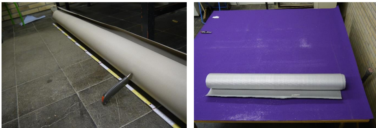
Abbildung 4.9: Membranrolle vor dem Grobzuschnitt (linkes Bild), vorkonfektionierte Probe nach dem Grobzuschnitt (rechtes Bild)
