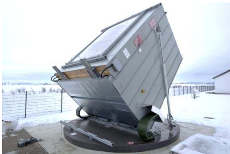
Bild 24: Kalorimetrischer Fassaden- und Dachprüfstand in geneigtem Zustand.
