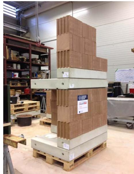
**Abb. 20** Zusammensetzen und Arretieren der Einzelelemente zum Modell-Rohbau
