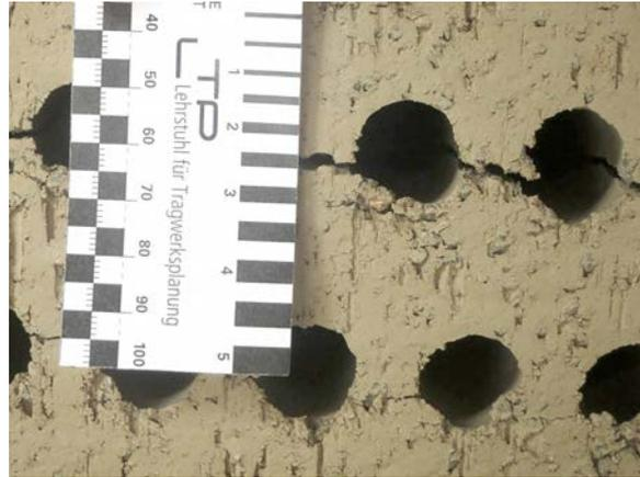
**Abb. 12** Längsmittiger Schwindriss durch Trocknung – an jedem Stein der Charge
