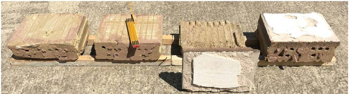
**Abb. 11** Steinproben aus der Prüfung – zwei ofenseitige Steine mit Putz und zwei Steinhälften der nichtbefeuerten Seite
