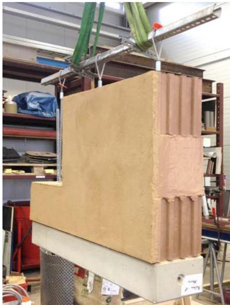
**Abb. 19** Hebeversuch Wandelement – Vermeidung von Spannungen im Mauerwerk Variante I: Hebe-traverse – keine auftretenden Querkräfte
