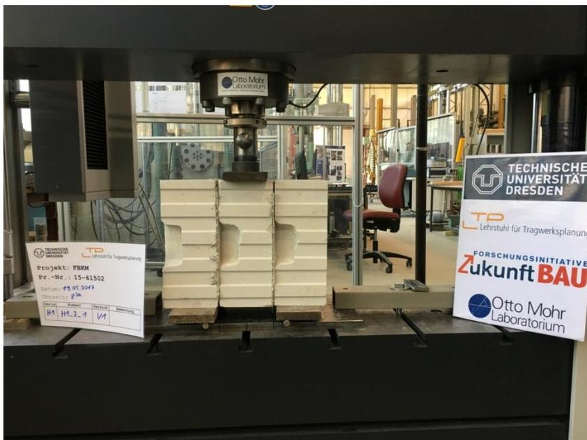
Bild 7 Versuchsaufbau mit 3 Steinen nach DIN EN 1052-3, Verfahren B, Typ I, vor dem Versuch
