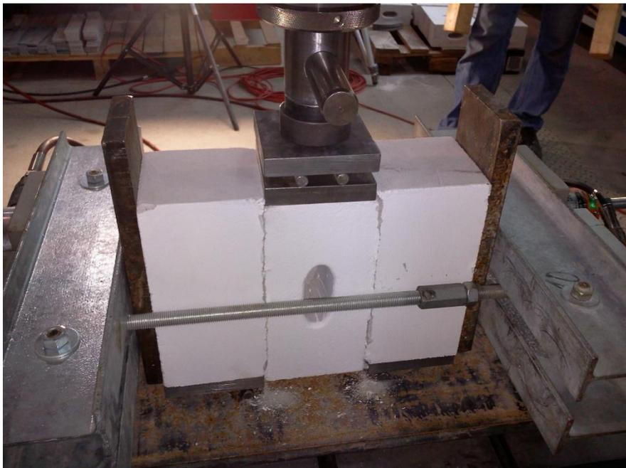
Bild 83 Dreisteinkörper 2DF mit Seitenlast, Abscheren mittlerer Stein
