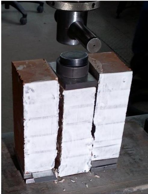
Bild 78 Prüfkörper mit 3 x NF nach dem Bruch
