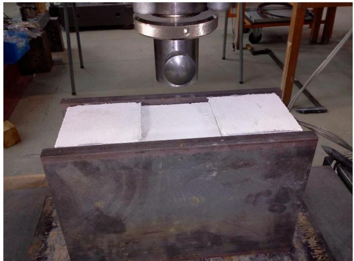
*Bild 81 Dreisteinkörper mit auf den äußeren Steinen geklebten Stahlblechen, vereinfachte Lasteinleitung ohne Rolle ; rechts: Abscheren des mittleren Steines, die Klebefuge ist unversehrt*
