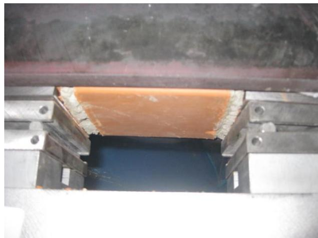
*Bild 88* Prüfkörper mit aufgeklebten Stahllaschen - Bruch
