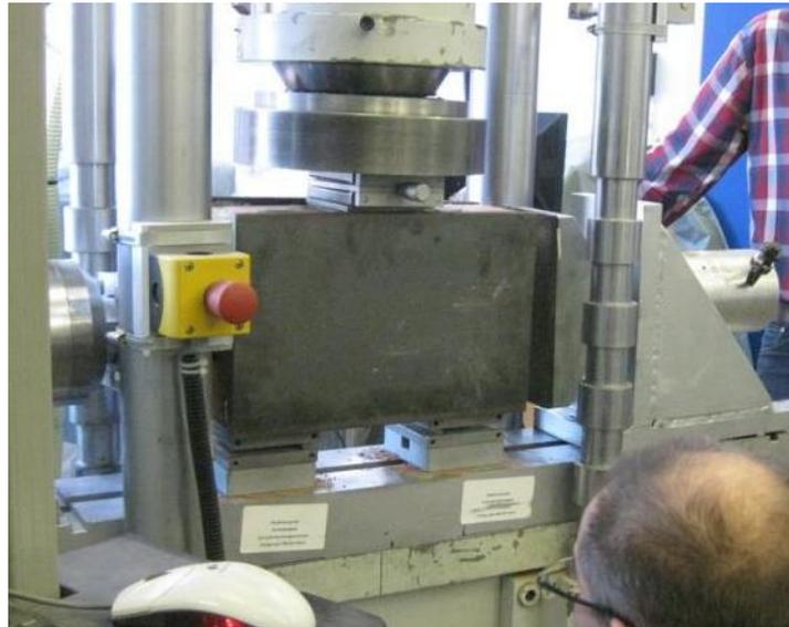
*Bild 87* Prüfkörper mit aufgeklebten Stahllaschen
