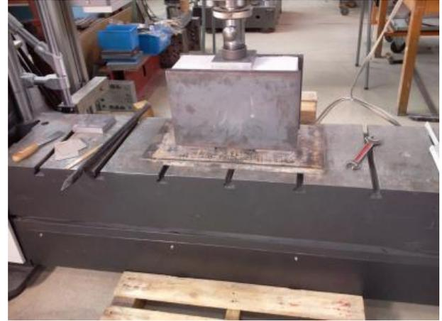
Bild 10 Phantom-Prüfkörper mit Zug- und Druckgeschirr (li.) und Prüfkörper mit aufgeklebten Stahlplatten (re.)
