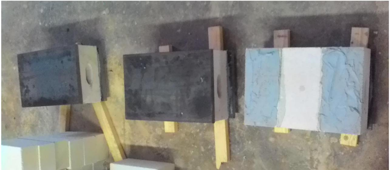
*Bild 80 Herstellung Dreisteinkörper mit auf den äußeren Steinen geklebten Stahlblechen*
