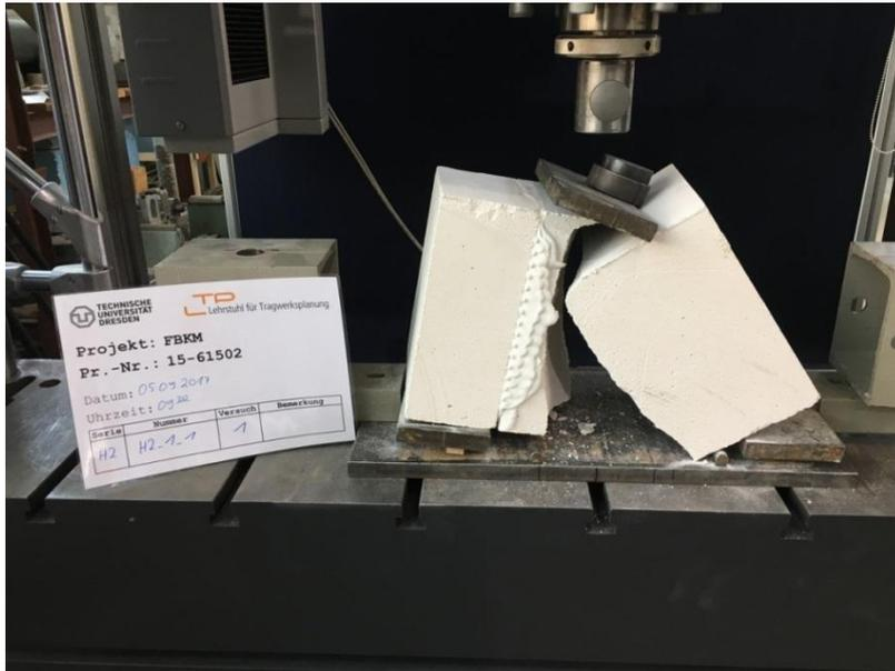
Bild 6 Verfahren B, Typ II mit Porenbeton und Dünnbettmörtel (mit Textil in der Lagerfuge) – Bruch des größeren Steines in der Mitte des Versuchskörpers (Das Wegrollen der Lagerplatte unten ist deutlich zu erkennen)
