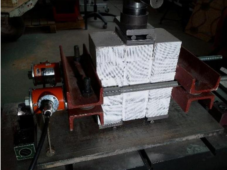
*Bild 71 Dreisteinkörper NF mit Seitenlast*
