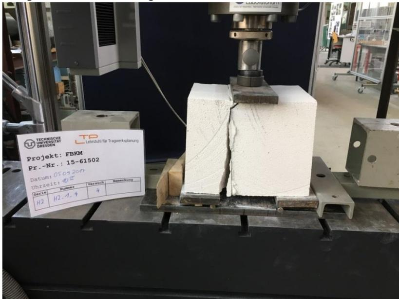
Bild 5 Versuch nach DIN EN 1052-3 Verfahren B, Typ II mit Porenbeton und Dünnbettmörtel (ohne Textil in der Lagerfuge) – Bruch des Steins nahe der Fuge (OML Institut für Massivbau der TU Dresden)
