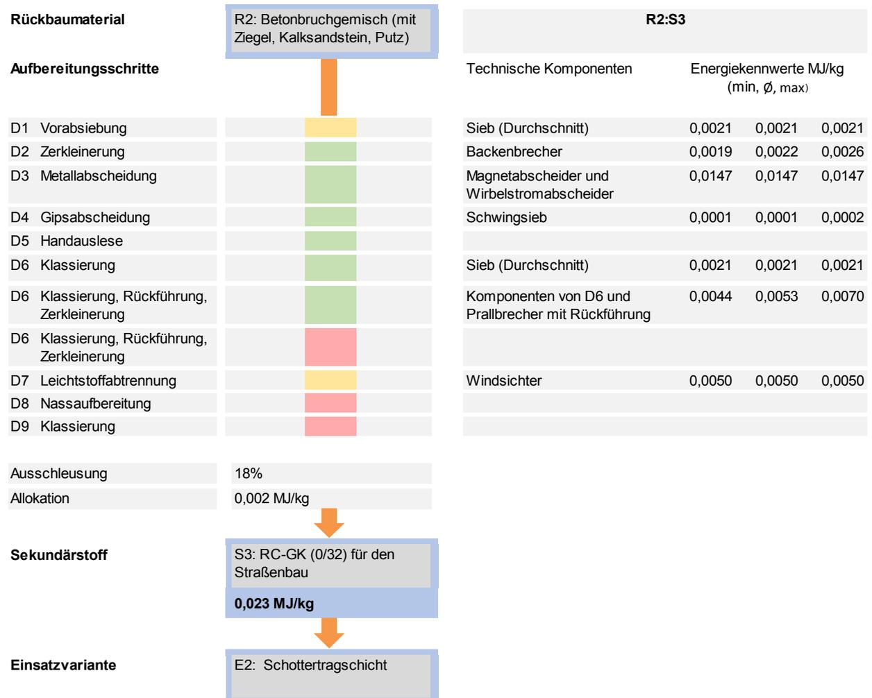
**Abbildung 3-8:** Aufbereitung des Rückbaumaterials bis zum Sekundärstoff (Prozesskette R2-S3-E2, Bauproduktgruppe Beton) (Quelle: eigene Darstellung).
