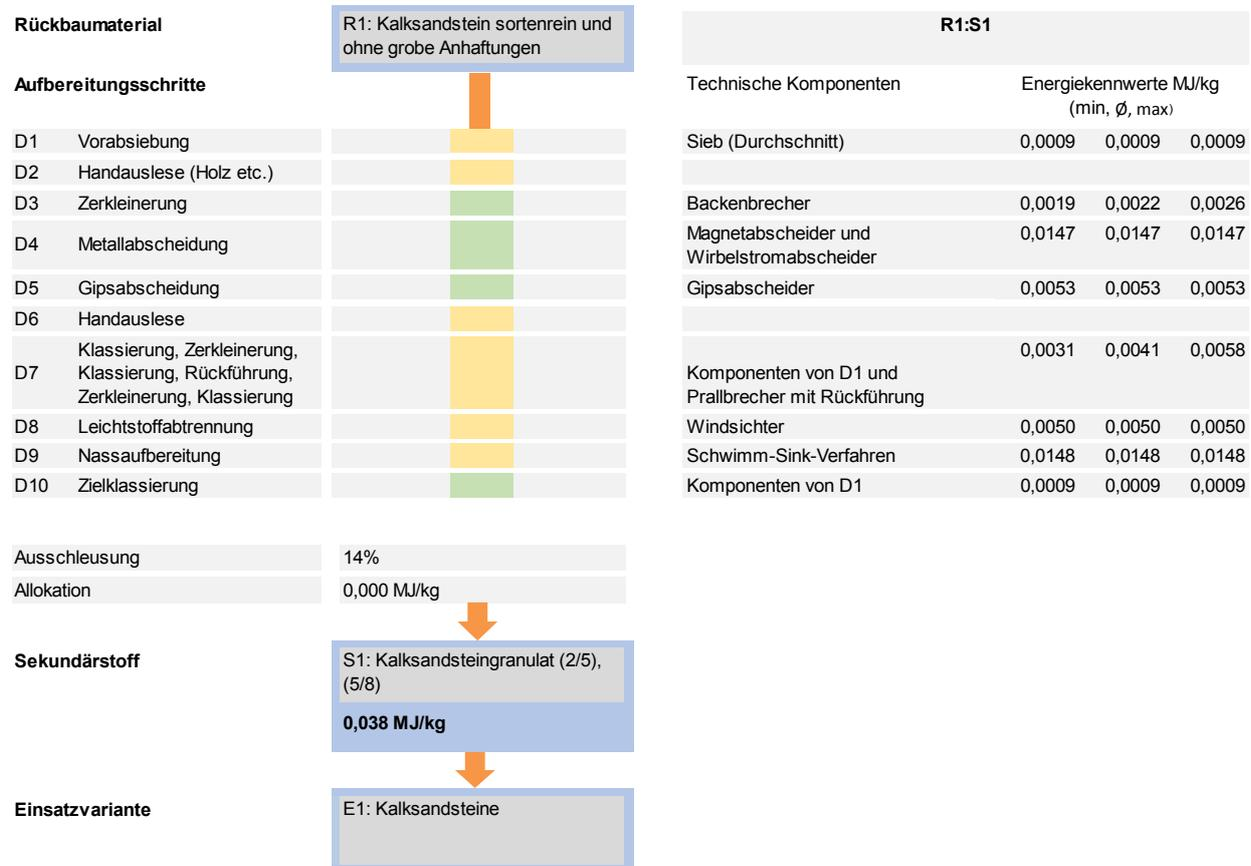
**Abbildung 3-31:** Aufbereitung des Rückbaumaterials bis zum Sekundärstoff der (Prozesskette R1-S1-E1, Bauproduktgruppe Kalksandstein) (Quelle: eigene Darstellung).
