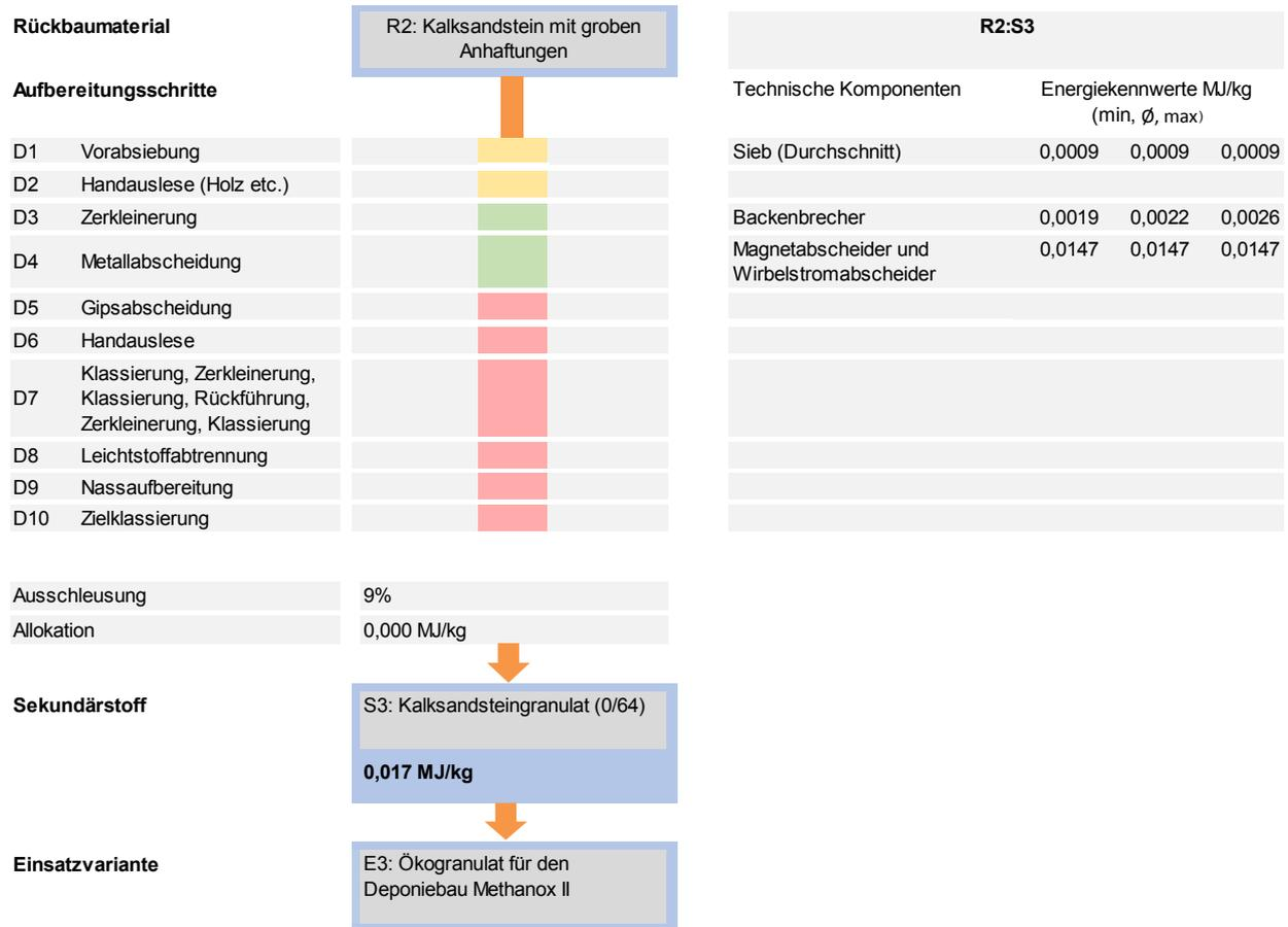
**Abbildung 3-37:** Aufbereitung des Rückbaumaterials bis zum Sekundärstoff der (Prozesskette R2-S3-E3, Bauproduktgruppe Kalksandstein) (Quelle: eigene Darstellung).
