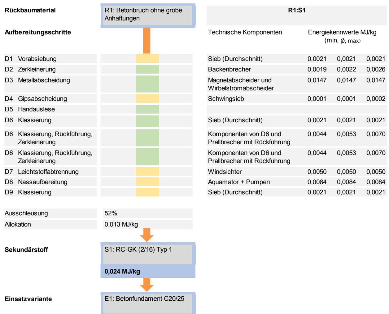
**Abbildung 3-2:** Aufbereitung des Rückbaumaterials bis zum Sekundärstoff (Prozesskette R1-S1-E1, Bauproduktgruppe Beton) (Quelle: eigene Darstellung).
