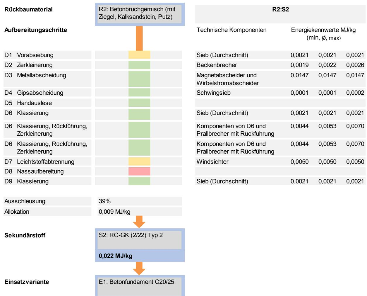
Abbildung 3-5: Aufbereitung des Rückbaumaterials bis zum Sekundärstoff (Prozesskette R2-S2-E1, Bauproduktgruppe Beton) (Quelle: eigene Darstellung).
