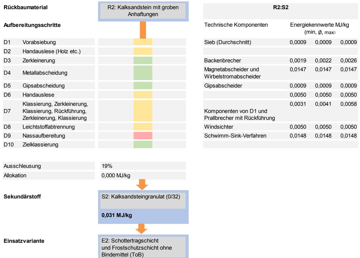
**Abbildung 3-34:** Aufbereitung des Rückbaumaterials bis zum Sekundärstoff der (Prozesskette R2-S2-E2, Bauproduktgruppe Kalksandstein) (Quelle: eigene Darstellung).
