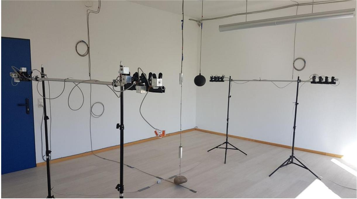
**Abb. 50 Anordnung der 16 IR-Sensoren in Laborraum T3**
