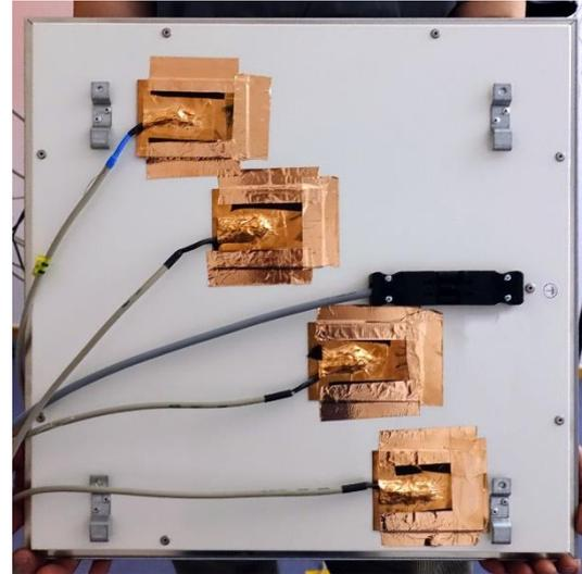
**Abb. 102 Temperatursensoren Vorderseite**    **Abb. 103 Temperatursensoren Rückseite**
