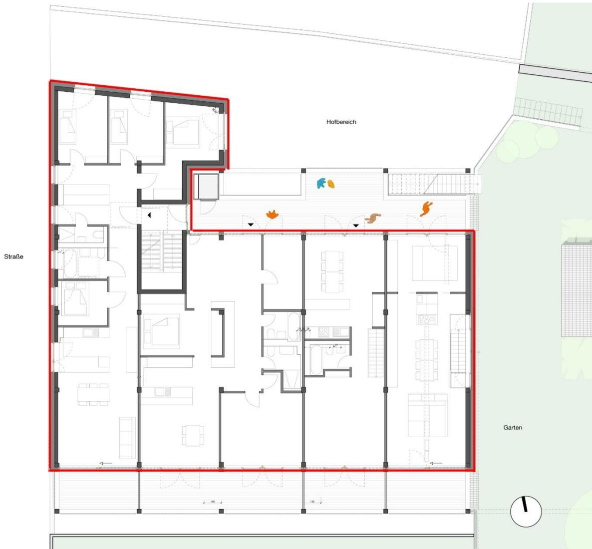
Abb. 12 Grundriss K76 Thermische Hülle [werk.um architekten, darmstadt]
