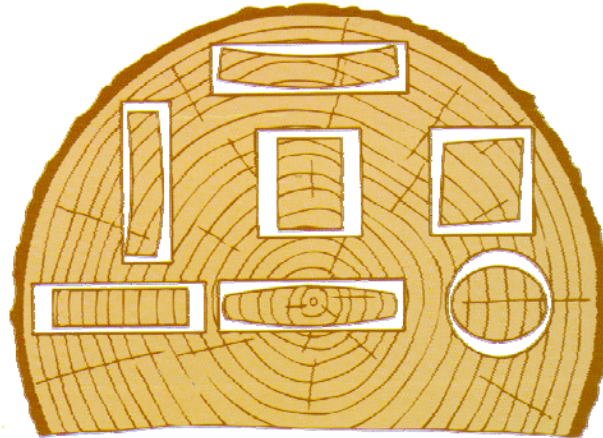
Bild 3: Schwindverformungen abhängig von Querschnittsform und Einschnitt
