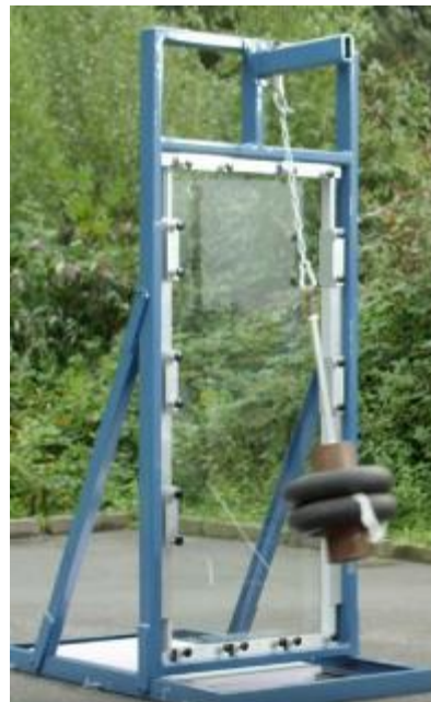
Abbildung 2-2 Schematische (links) und exemplarische (rechts) Darstellung des Pendelschlagversuchs
