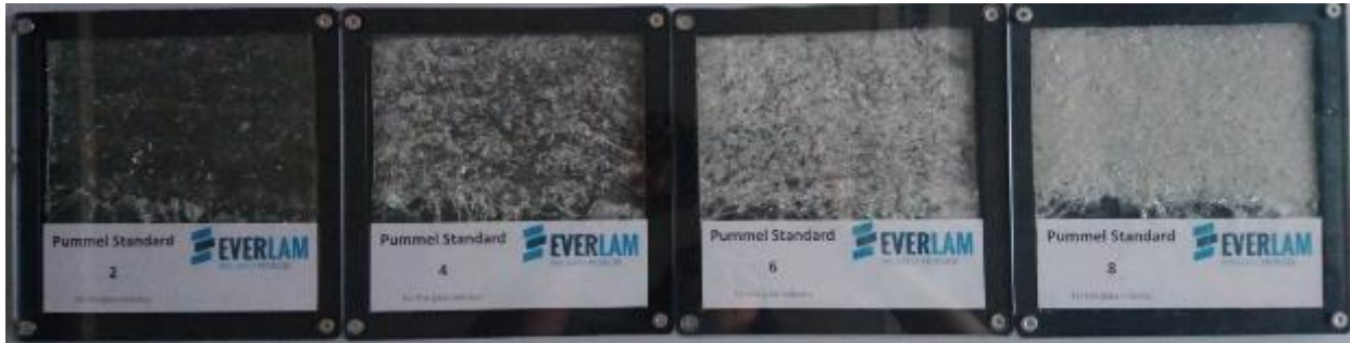
Abbildung 3-17 Referenzmuster Everlam, Pummel 2, Pummel 4, Pummel 6 und Pummel 8. Die Probenabmessungen betragen 15x15cm
