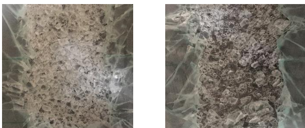
Abbildung 5-3 Beispielhafte Pummelergebnisse für EVA (links) und SentryGlas (rechts)
