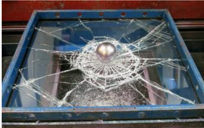
Abbildung 2-1 Exemplarischer Aufbau eines Kugelfallversuchs
