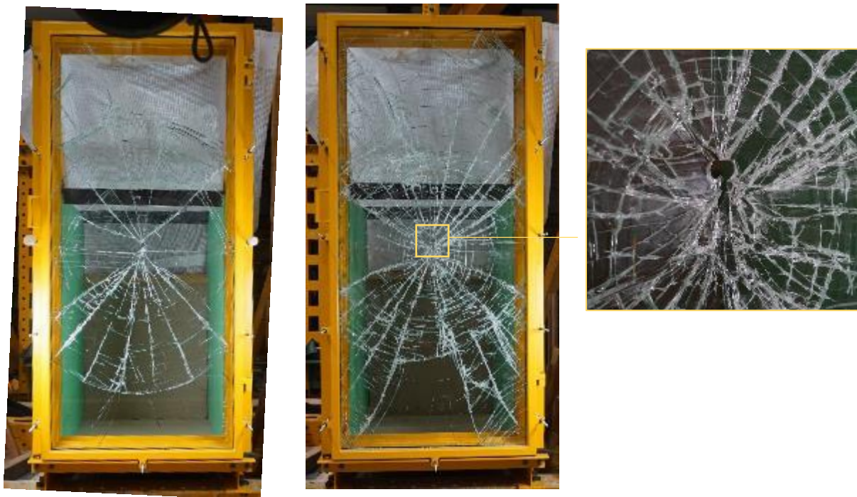
Abbildung 4-36 Bruchbilder nach Pendelschlag, links: 450 mm Fallhöhe, rechts: 1200 mm Fallhöhe
