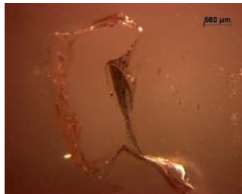
Abbildung 4-17 Blasen und Risse der Zwischenschicht mit hohem Haftgrad im Bereich des Versatzes nach dem Versuch
