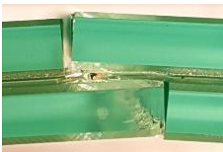
Abbildung 4-14 TCB-Versuch mit versetztem Riss (links), Delamination im Überlappungsbereich der Risse (rechts)
