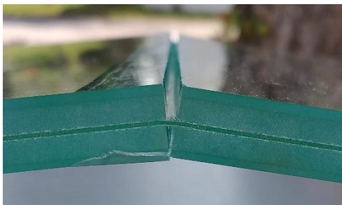
Abbildung 5-4 koinzidenter Bruch, maschinell erzeugt
