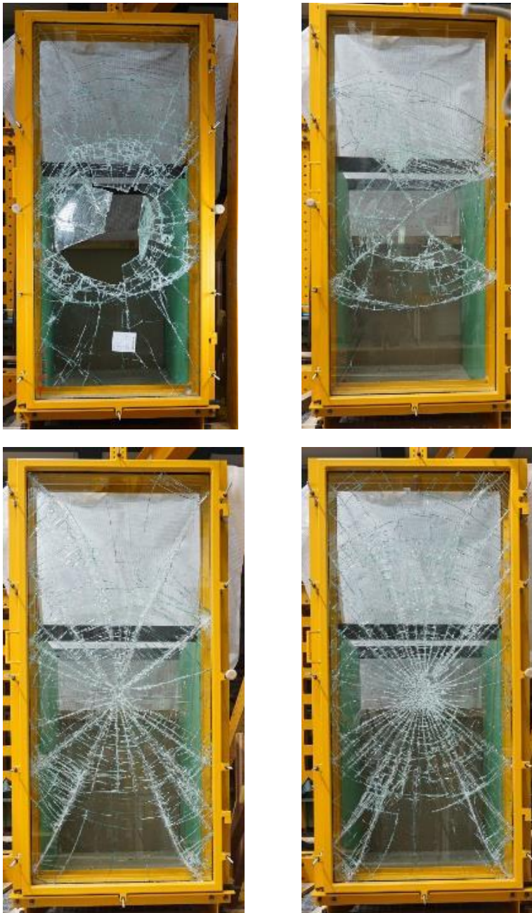
Abbildung 5-11 Bruchbilder oben: EV200 nach Pendelschlag, links: 1200 mm Fallhöhe, rechts: 450 mm Fallhöhe; Bruchbilder unten: SentryGlas nach Pendelschlag, Fallhöhe jeweils 1200 mm
