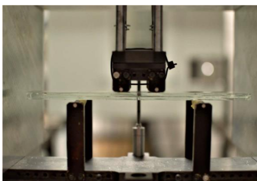
Abbildung 4-24 links: Probe im 4-Punktbiegeversuch, rechts: Skizze mit Abmessungen
