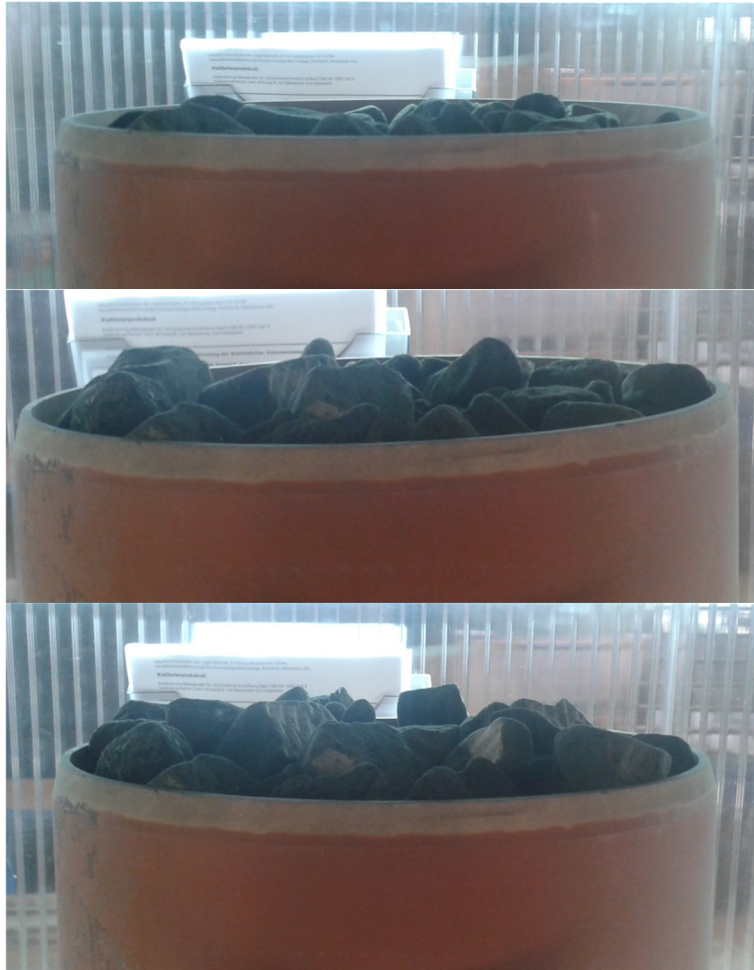
Bild 8: Untersuchte Füllstände, oben: Befüllung ohne Überstand, Mitte: ausgeglichene normale Befüllung, unten: überfüllt mit nahezu keinen Lücken.
