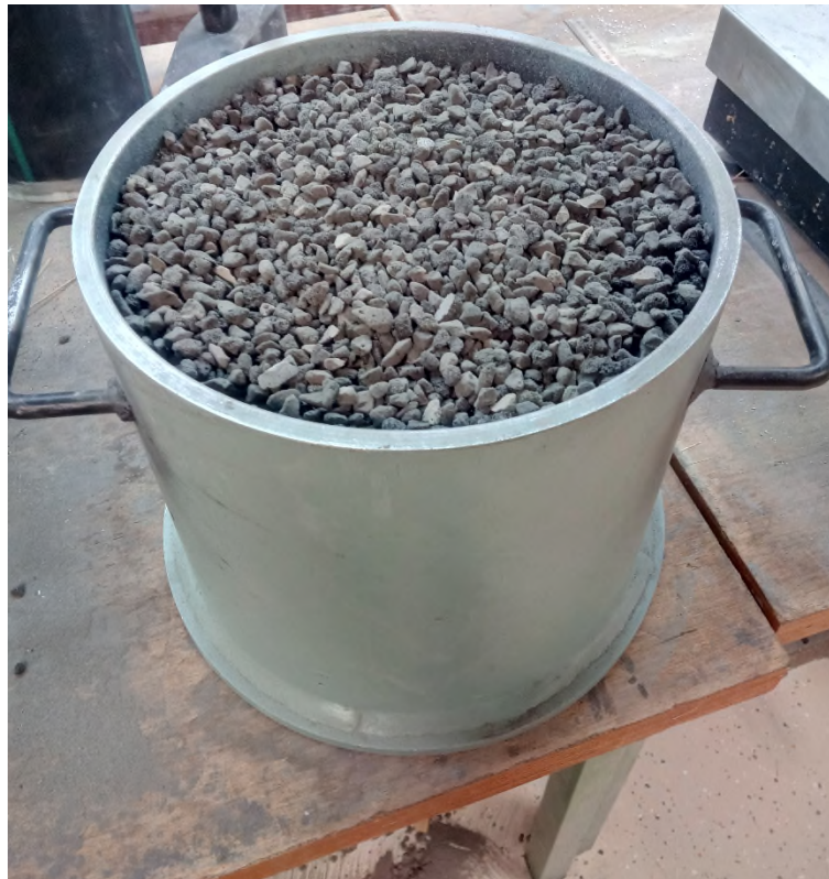
Bild 19: Zylindrischer Prüfrahen für Druckspannungsmessungen nach DIN EN 826.
