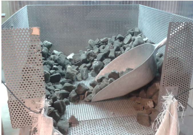
Bild 5: Abtrennen von Sand durch einen Kasten aus Lochblech.
