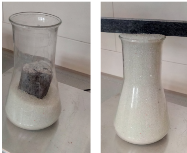
Bild 13: Volumenbestimmung im Sandersatzverfahren.
