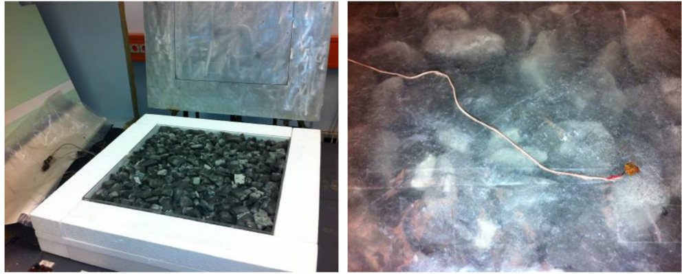
Bild 23: links: Einbau Prüfraumen im Plattengerät, rechts: Positionierung der Thermoelemente.
