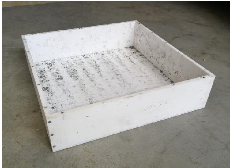
Bild 24: Neue Prüfraumen aus temperaturstabilem Material, Innenabmessungen: 600 x 600 x 150 mm.
