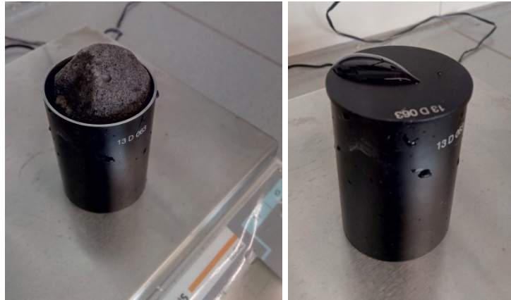
Bild 15: Zylindrische Pyknometer mit Schaumglasschotter Probe.
