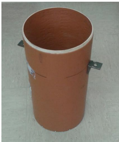
Bild 6: Beispiel für einen Prüfzylinder zur Schüttdichtebestimmung.
