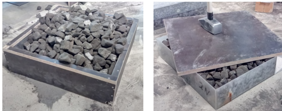
Bild 22: Verdichtung der Schüttung im Prüfraumen.
