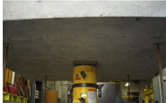
Abbildung 2.10: Versuchsaufbau der durchgeführten Durchstanzversuche [33]
