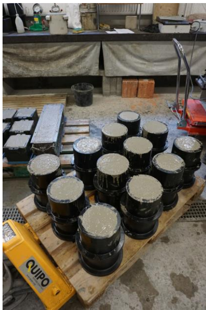
g) Betonprüfkörper - Zylinder
