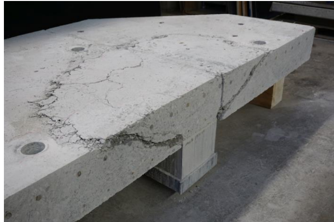
Abbildung 3.19: Stanzkegel im Sägeschnitt am Stützenanschnitt (hier Versuch M3-25-1.23)
