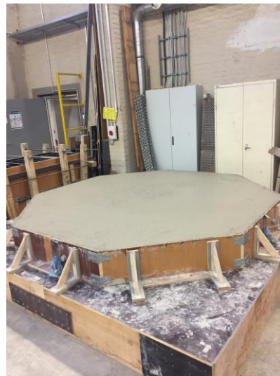
f) Betonierter Versuchskörper
