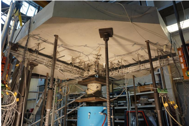
Abbildung 3.13: Übersicht Versuchskörperuntersicht mit fertig eingerichteter Messtechnik [42]
