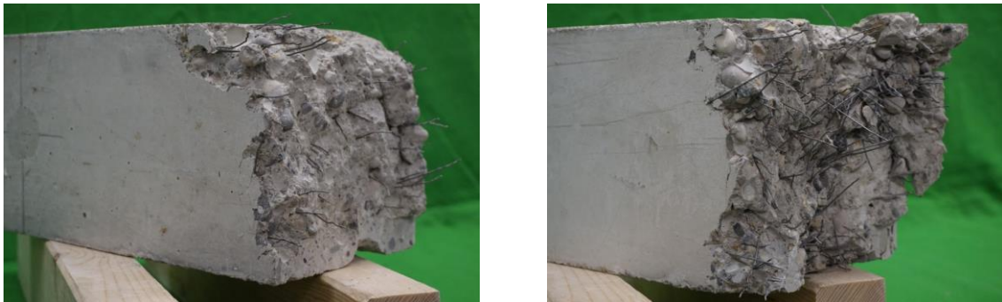
Abbildung 2.1: Bruchquerschnitt eines Biegezugbalkens bei 0,5 Vol.-% (links) und 1,0 Vol.-% (rechts)
