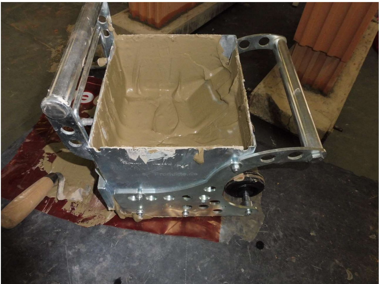
Bild 27: Mörtelauftrag des Dünnbettmörtels ZP99 mit Mörtelwalze (mit Ziegeln T18)
