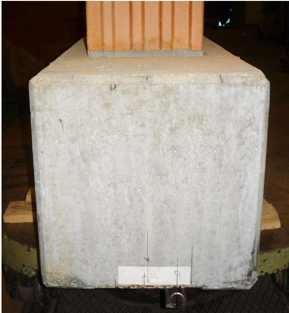
Bild 5: Ansicht des alternativ verwendeten Betonträgers (Träger 2, Höhe rd. 40 cm)
