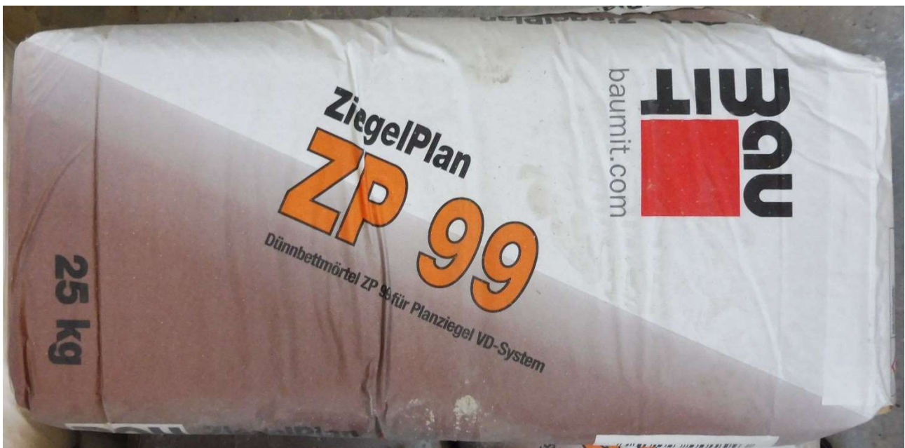
Bild 26: Verwendeter Dünnbettmörtel ZP99 (mit Ziegeln T18)
