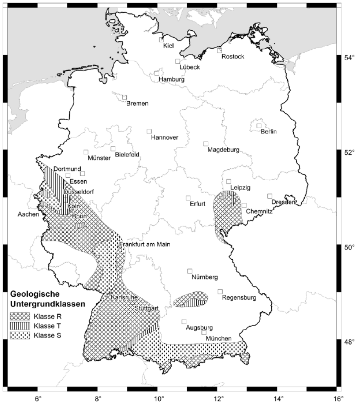
Abbildung 3-4: Schematische Darstellung der geologischen Untergrundklassen im Bereich der Konturlinie von S_{aP,R} \leq 0,6 \text{ m/s}^2
