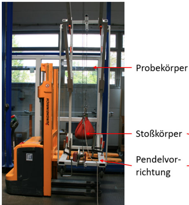
Abbildung 25 Fotografie der verwendeten Vorrichtung zur Durchführung der dynamischen Belastung.
