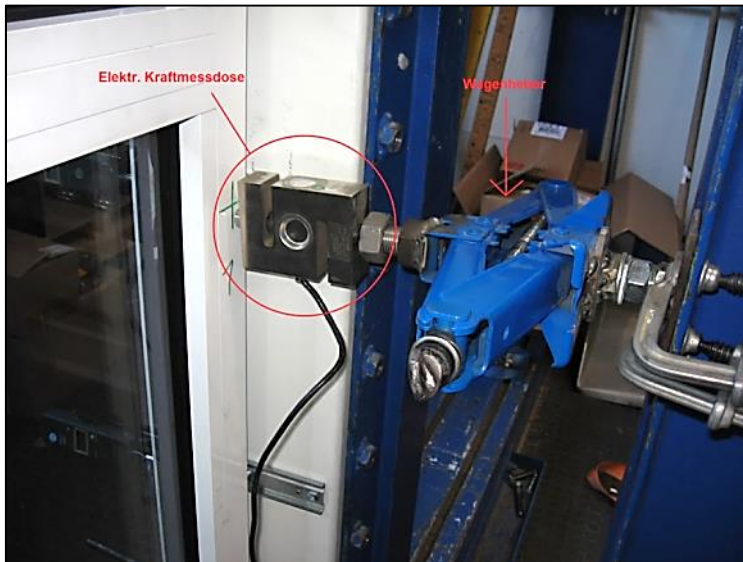
Abbildung 19 Einleitung der Kraft mit Wagenheber und Messung der Kraft mit Kraftmessdose auf der Anprallseite
