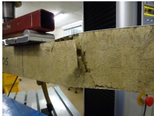
Abb. 3.15: Versagensbild Schubbruch S-05
