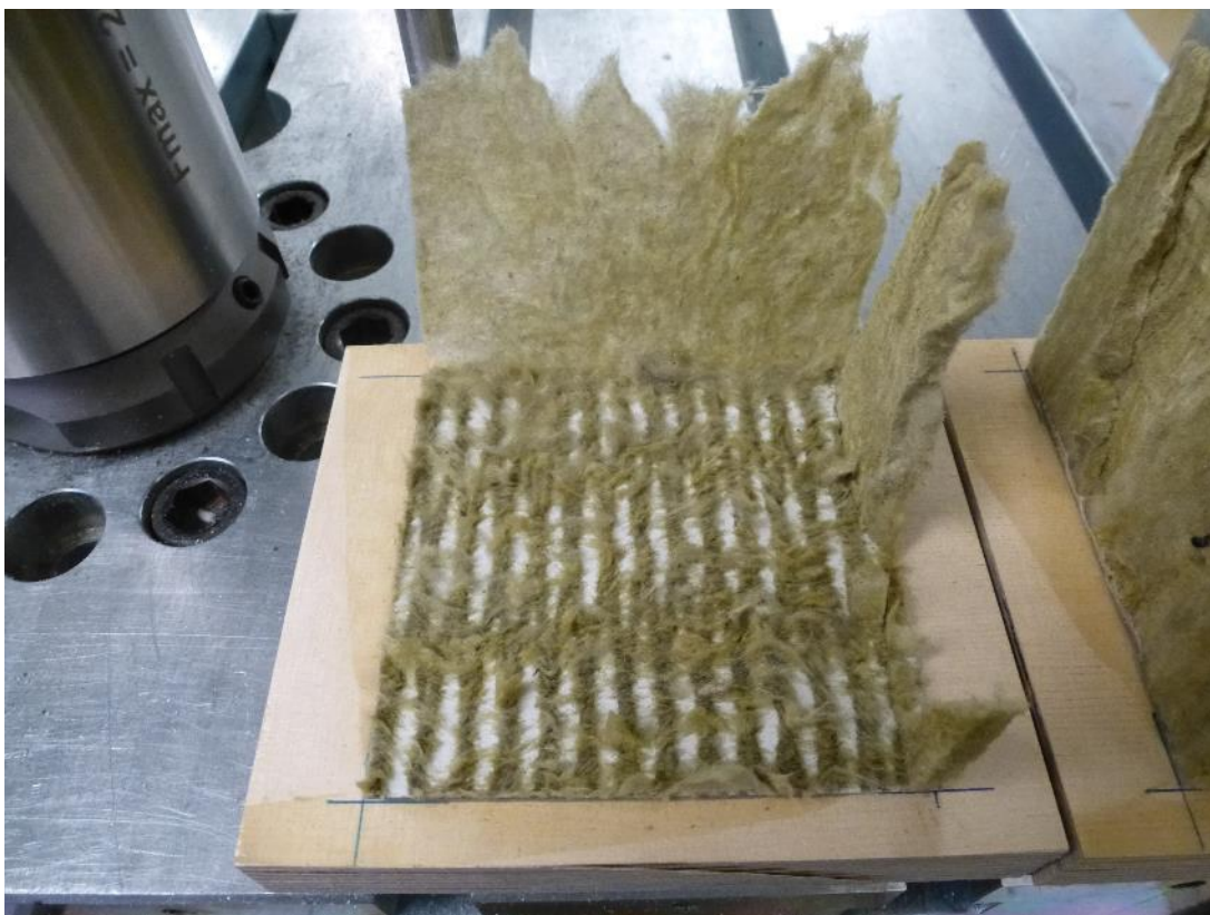
Abb. 3.10: Versagensbild Querzug 80°C Versuch QZ-80-04
