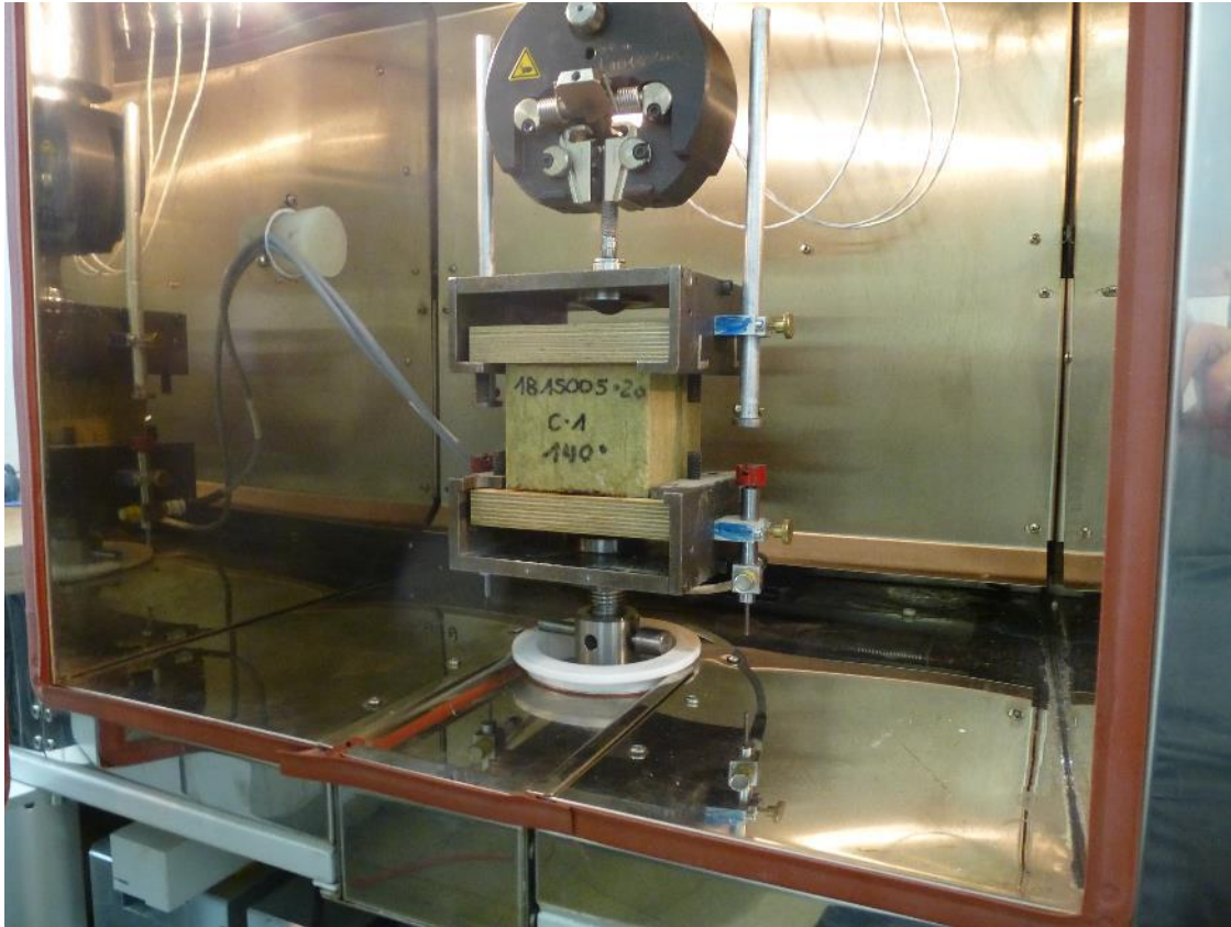
Abb. 3.11: Querzugversuche 140°C senkrecht zur Deckschicht
