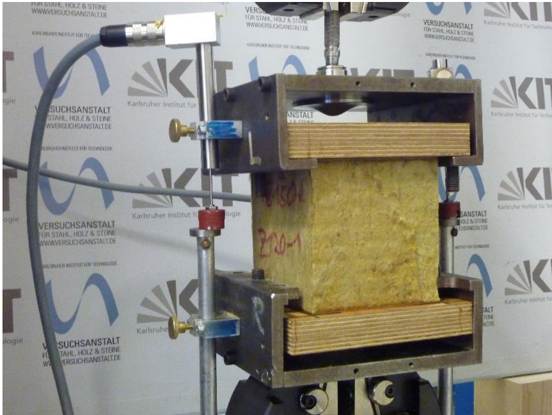
Abb. 4.8: Querzugversuche 140°C senkrecht zur Deckschicht
