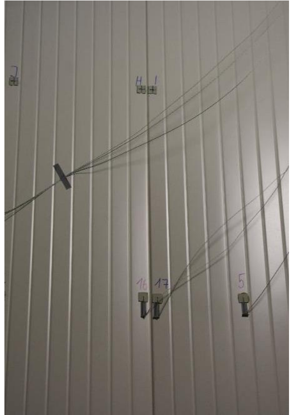
Abb. 13.8: Fuge bei Mst. 16/17 weitet sich (33')
