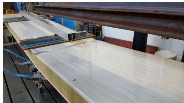
Abb. 2.19: Versagen durch Knittern in Feldmitte V3pos
