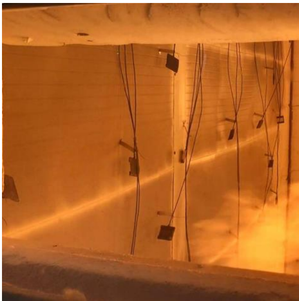
Abb. 8.3: Ablösen der Deckschichten (1')
