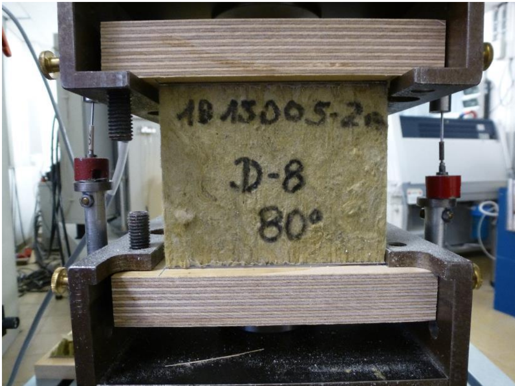
Abb. 3.9: Querzugversuche 80°C senkrecht zur Deckschicht
