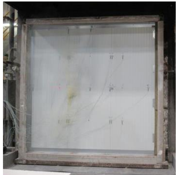
Abb. 14.4: Mittlerer Rauchaustritt (gelber Rauch) aus der Fuge zwischen den Mst. 13/14 und Mst. 18/19 (3')
