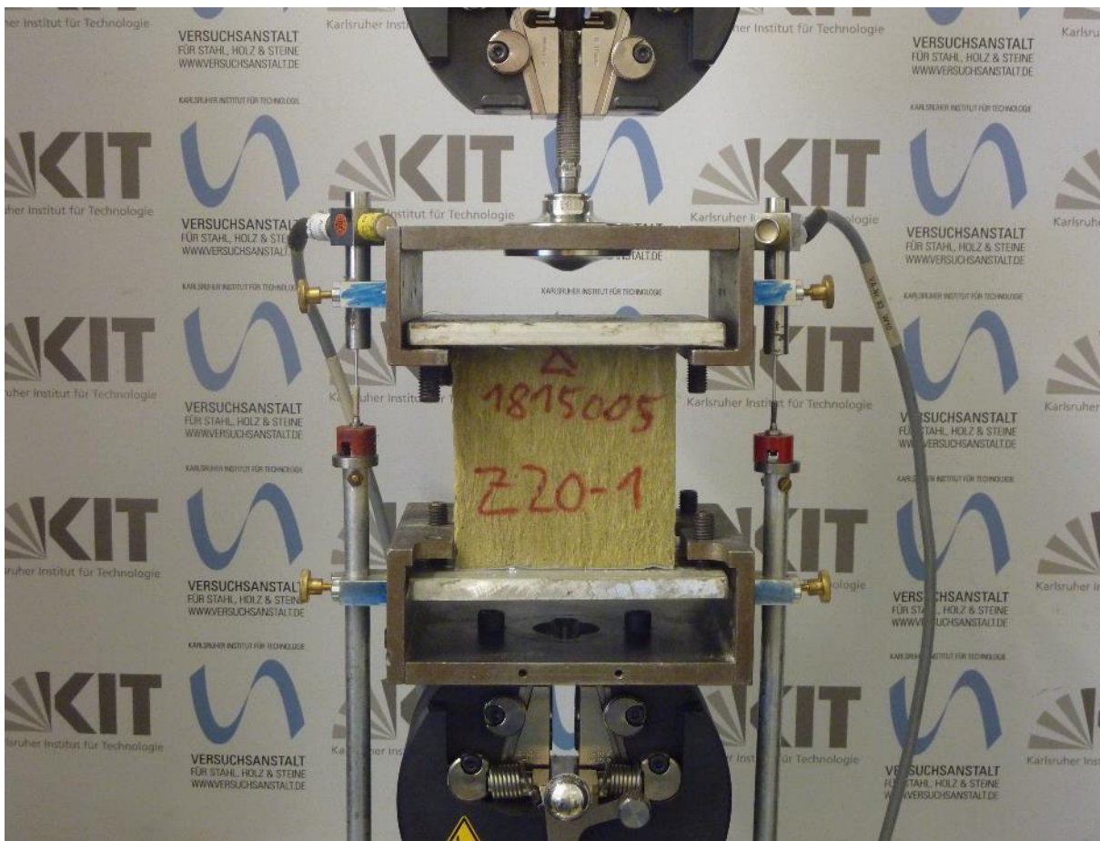
Abb. 4.4: Versuchsaufbau der Zugversuche bei Raumtemperatur
