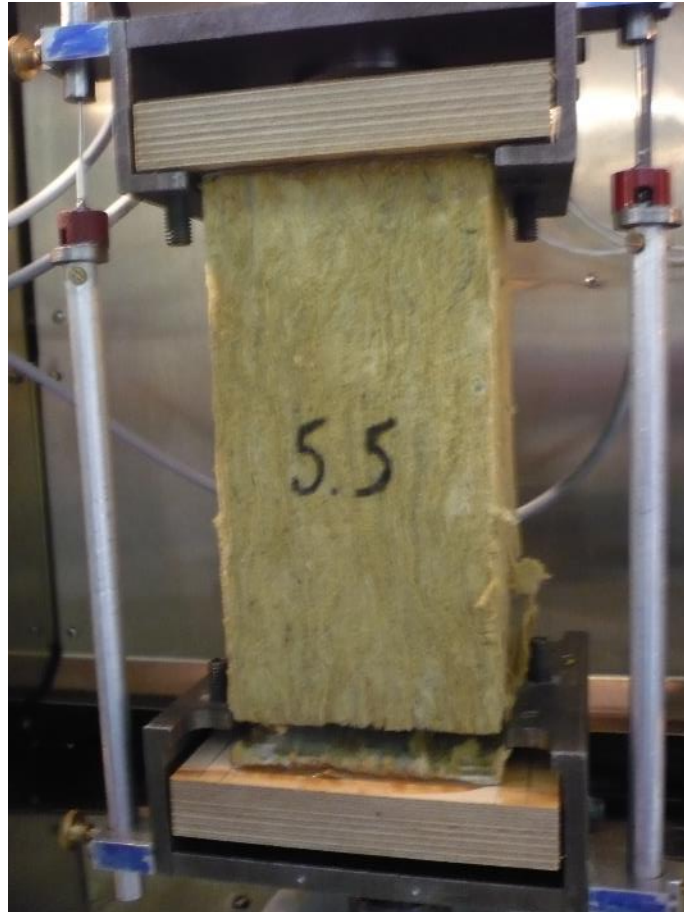
Abb. 2. 11: Querzugversuche 140°C senkrecht zur Deckschicht
