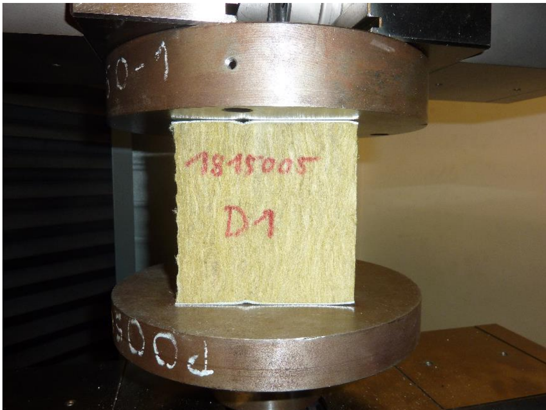
Abb. 4.2: Versuchsaufbau der Druckversuche
