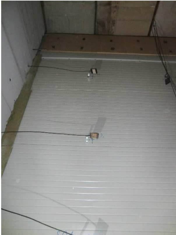
Abbildung 5.1 und 5.2: Brandraum mit abgedeckter Befestigung
