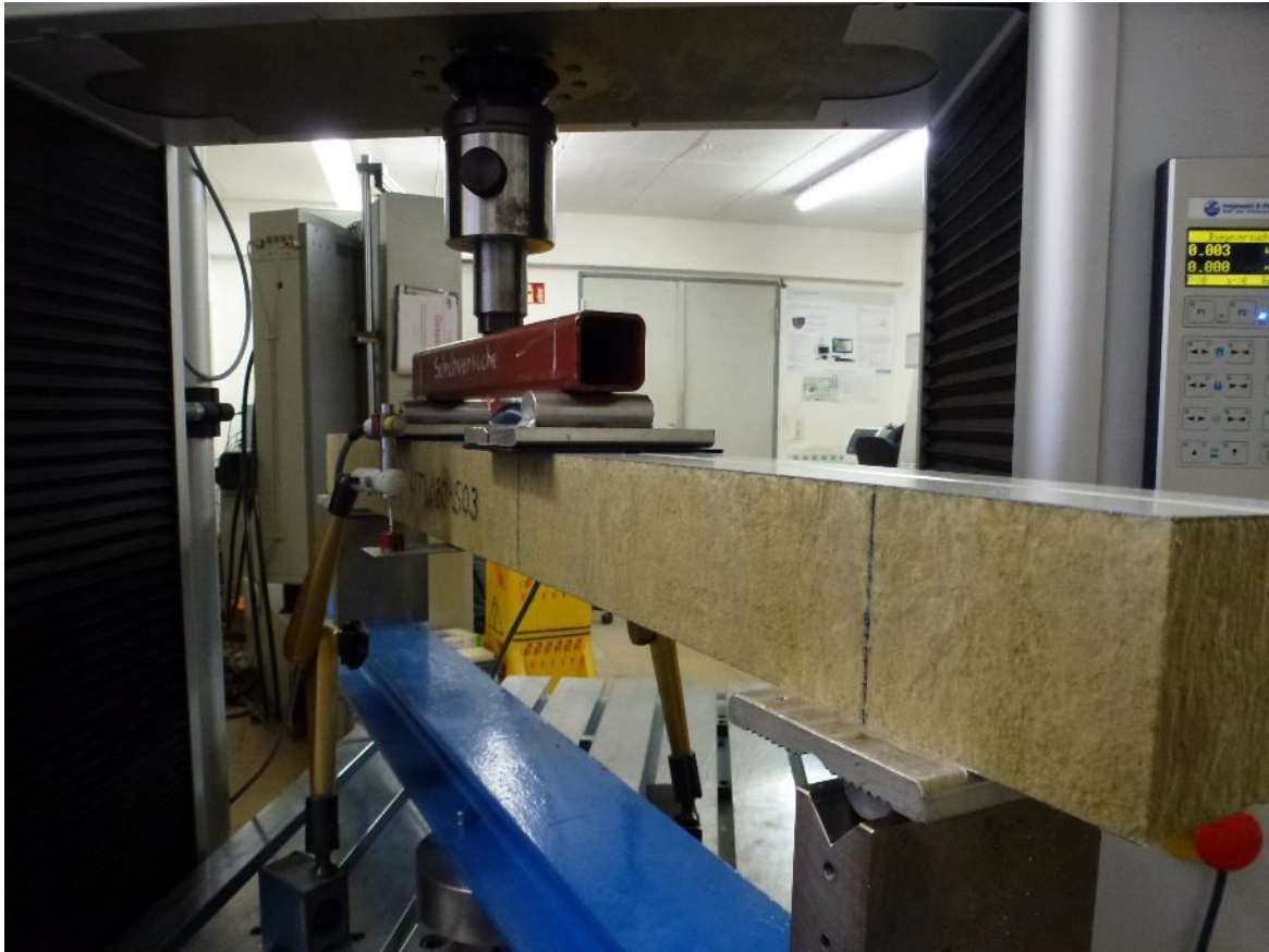
Abb. 3.13: Versuchsaufbau Schubbalken Versuch S-03
