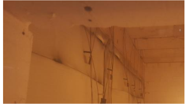
Abb. 9.6: Abdeckblech am oberen Rand wellt sich (7')
