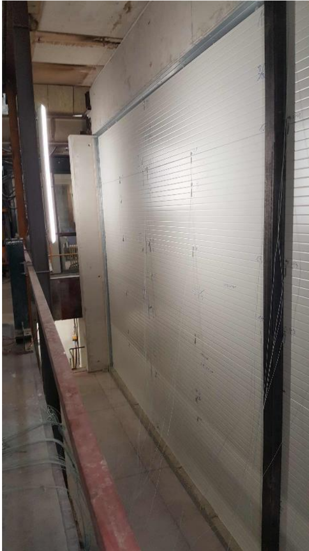
Abb. 8.1: Prüfaufbau mit Stütze
