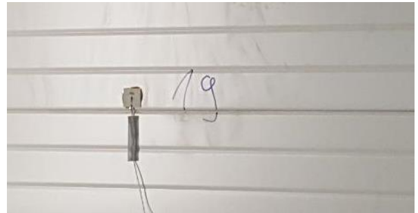
Abb. 9.8: Leichter Rauaustritt Fuge I (20')
