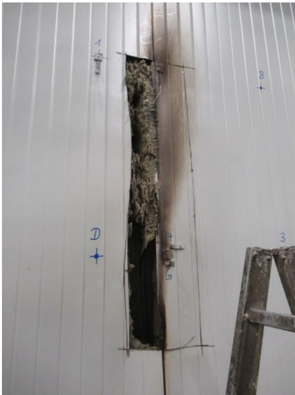
Abb. 14.7: Fugenöffnung nach Versuch
