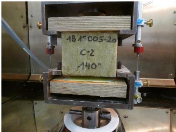
Abb. 3.12: Versagensbild Querzug 140°C Versuch 2, Ablösen der Deckschichtbeschichtung
