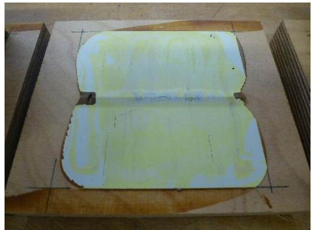
Abb. 3.12: Versagensbilder Querzug 140°C, abgelöste Deckschichtbeschichtung
