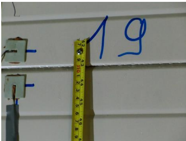
Abb. 5.15: Kondensat an MSt 19 (72')
