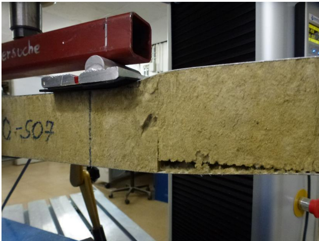
Abb. 3.16: Versagensbild Schubbruch Versuch S-07
