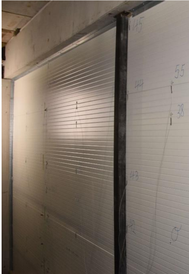
Abb. 9.1: Prüfaufbau mit Stütze
