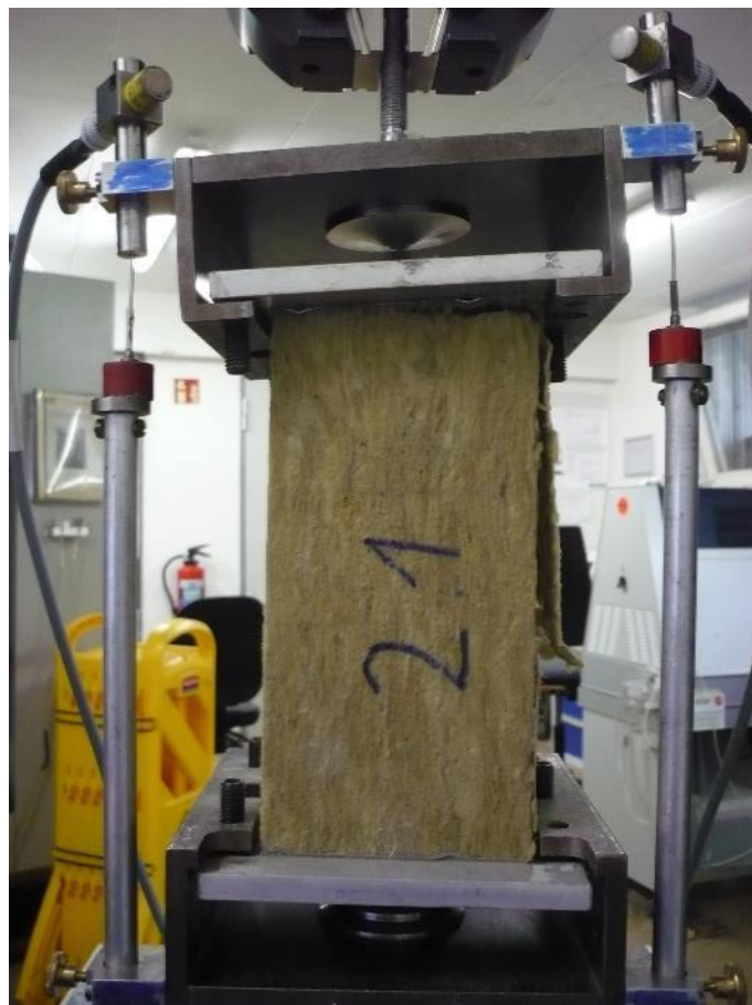
Abb. 2. 7: Versuchsaufbau der Zugversuche bei Raumtemperatur
