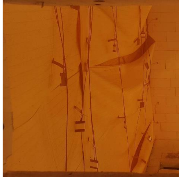
Abb. 8.10: Verformung der Deckschichten (50')
