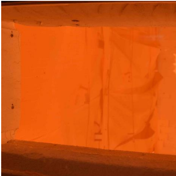
Abb. 8.16: Deckschichten hängen durch (76')
