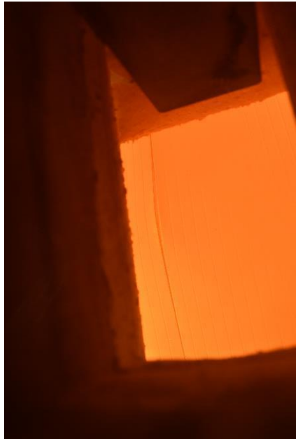
Abb. 11.6: Stoßfuge 2 leicht geöffnet (45')
