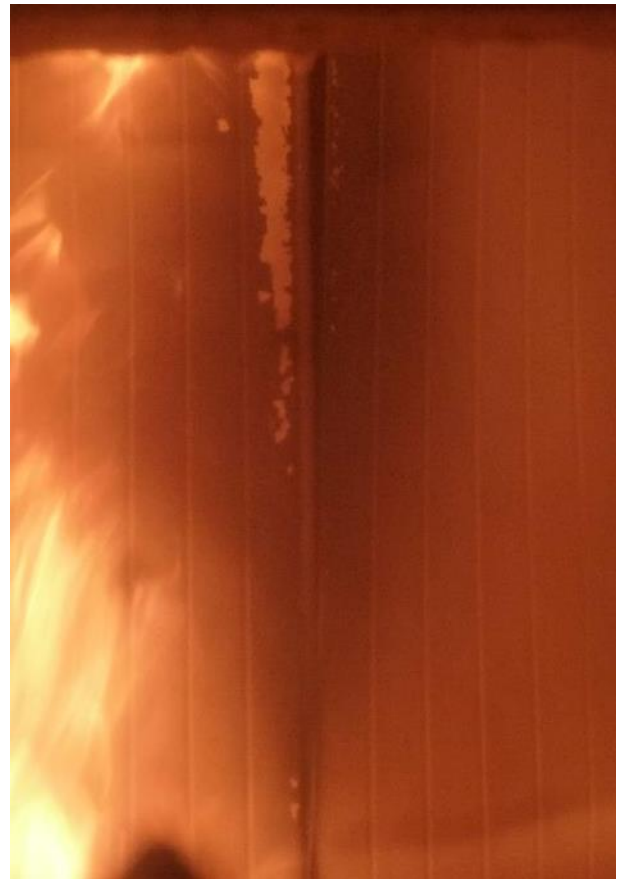
Abb. 12.4: Risse in der Beschichtung und Ablättern im Randbereich (5')
