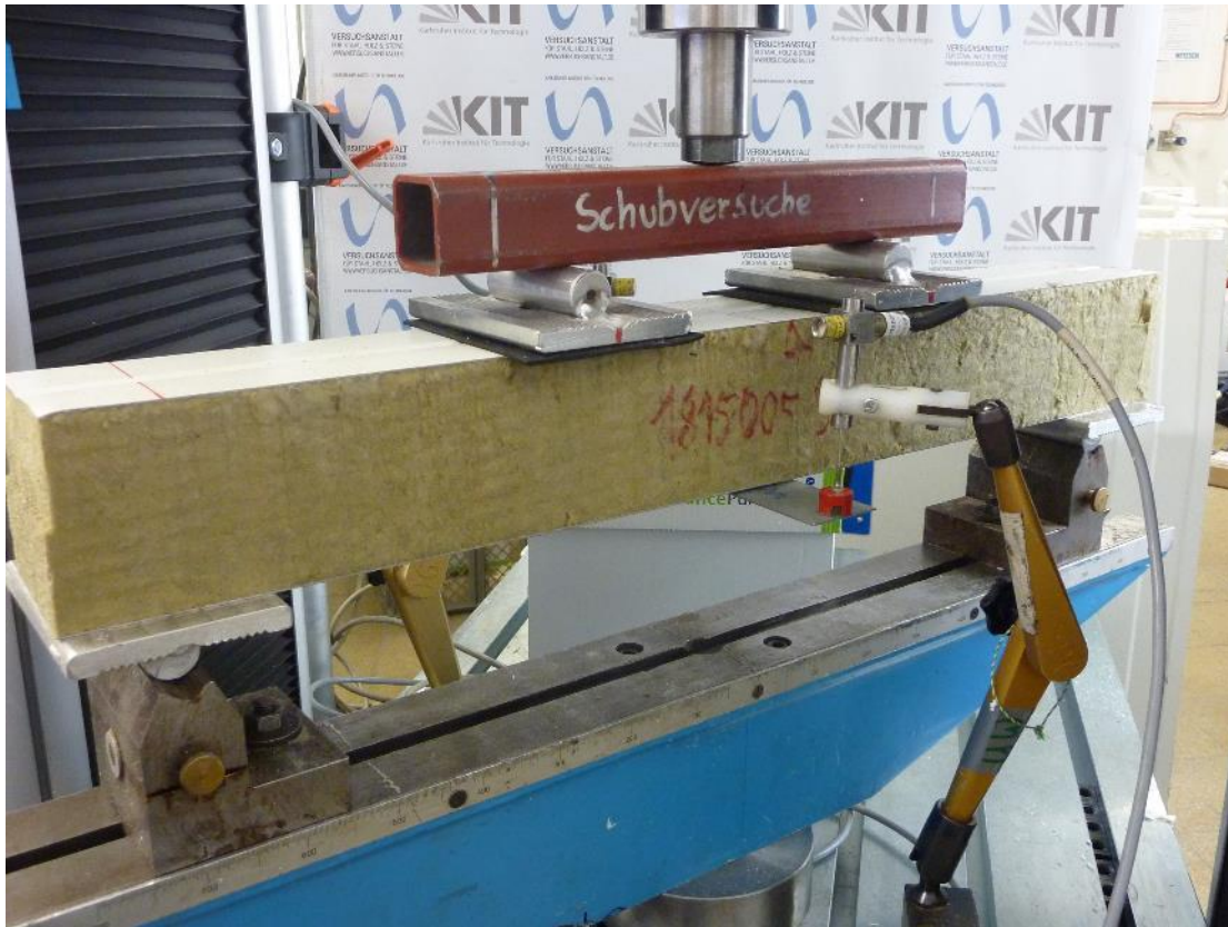
Abb. 4.10: Versuchsaufbau Schub balken
