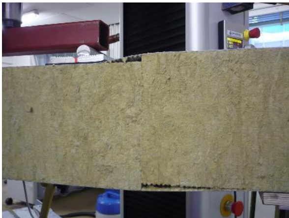
Abb. 2. 14: Versagen L infolge eines Lamellenstoßes im Querkraftbereich V03
