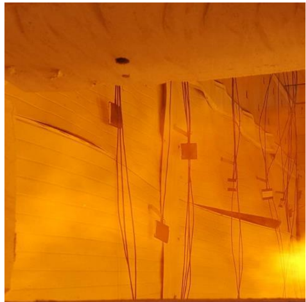
Abb. 8.8: FS Öffnen der Fugen (26')
