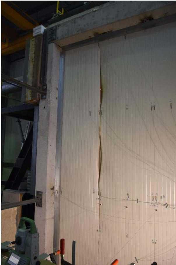
Abb. 13.11: Probekörperansicht nach Beflammungsende
