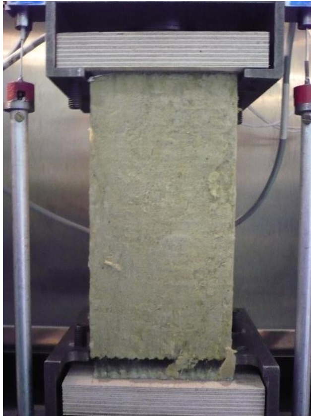
Abb. 2. 9: Querzugversuche 80°C senkrecht zur Deckschicht
