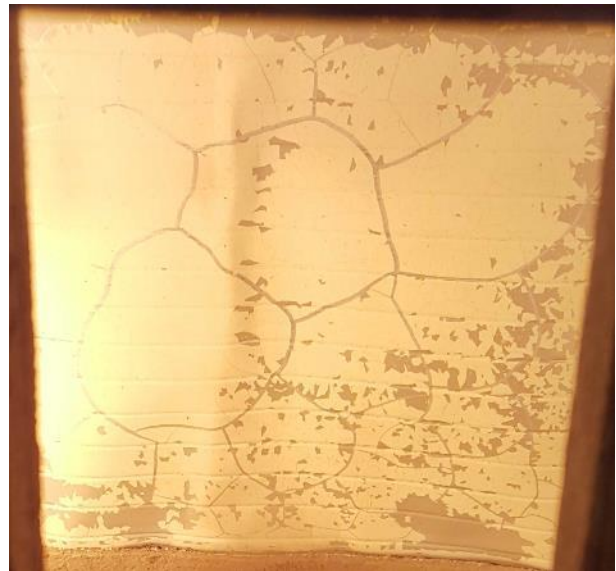
Abb. 7.4: Deckschicht innen gewellt (9')
