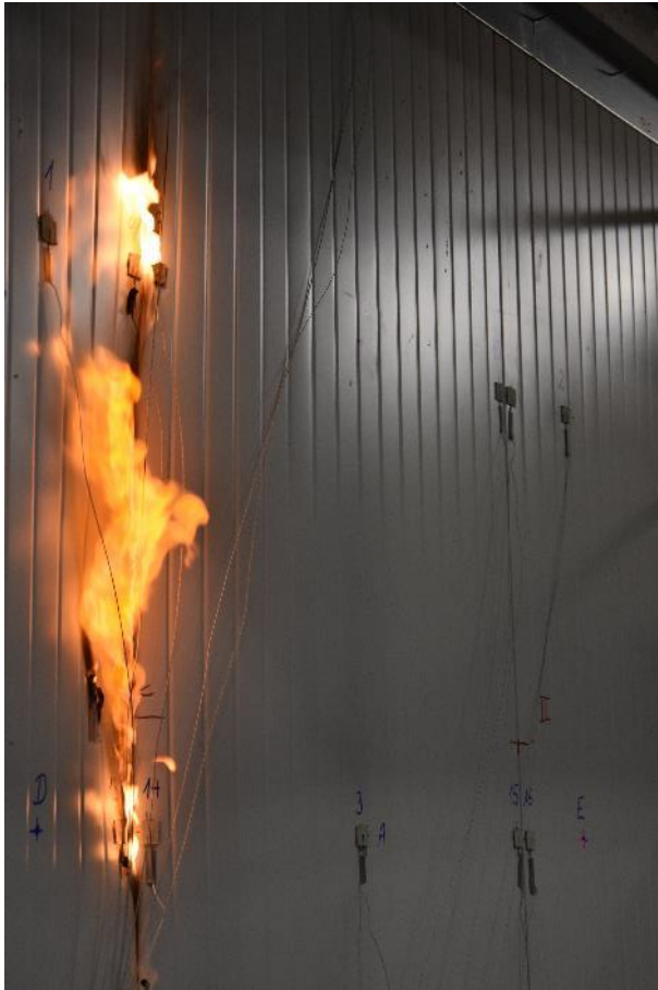
Abb. 11.9: Flammenaustritt aus Fuge I (133')
