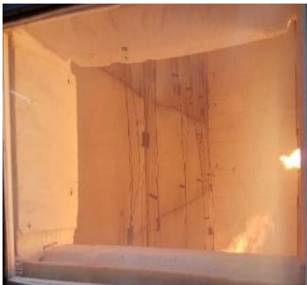
Abb. 9.3: Bleche wölben sich in den Brandraum (2')
