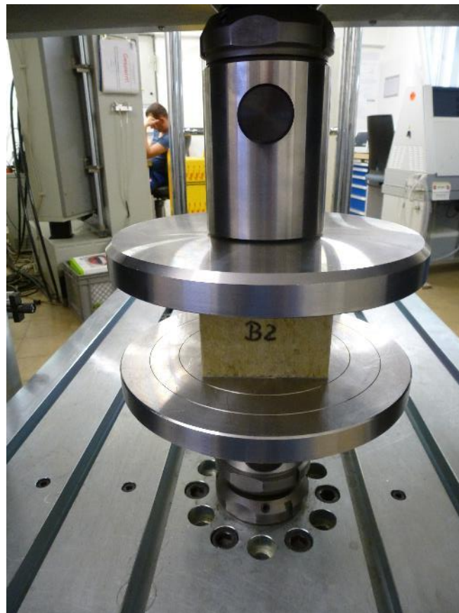
Abb. 3. 2: Versuchsaufbau der Druckversuche
