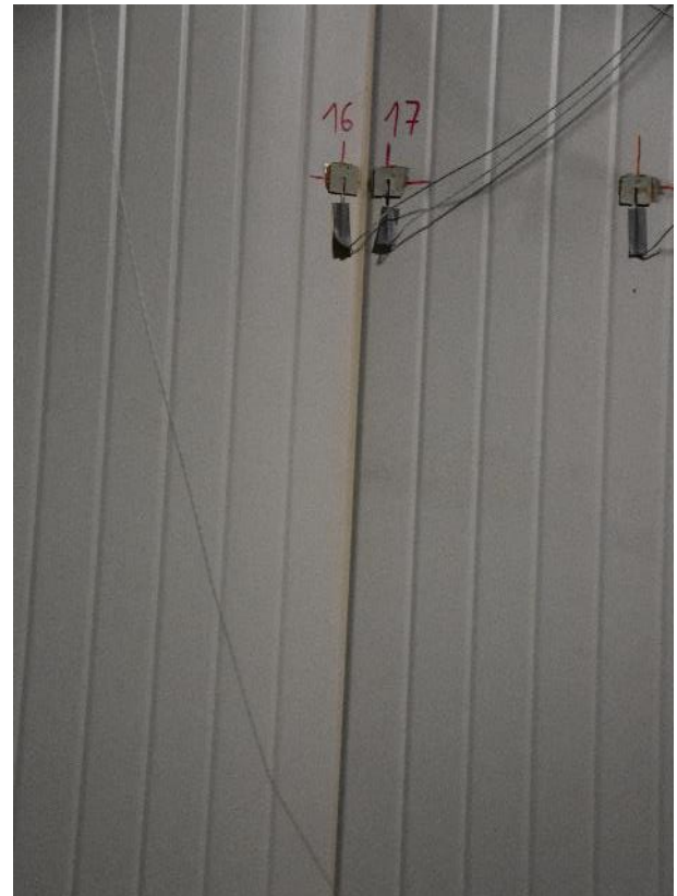
Abb. 12.8: Die Mst. 16/17 lösen sich leicht vom Probekörper
