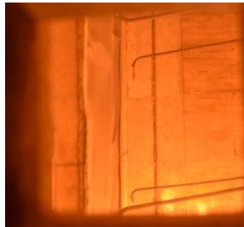
Abb. 13.4: Bleche lösen sich von der Mineralwolle und verformen sich (2')
