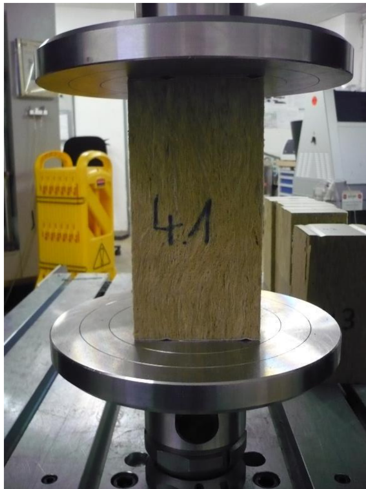
Abb. 2. 2: Versuchsaufbau der Druckversuche
