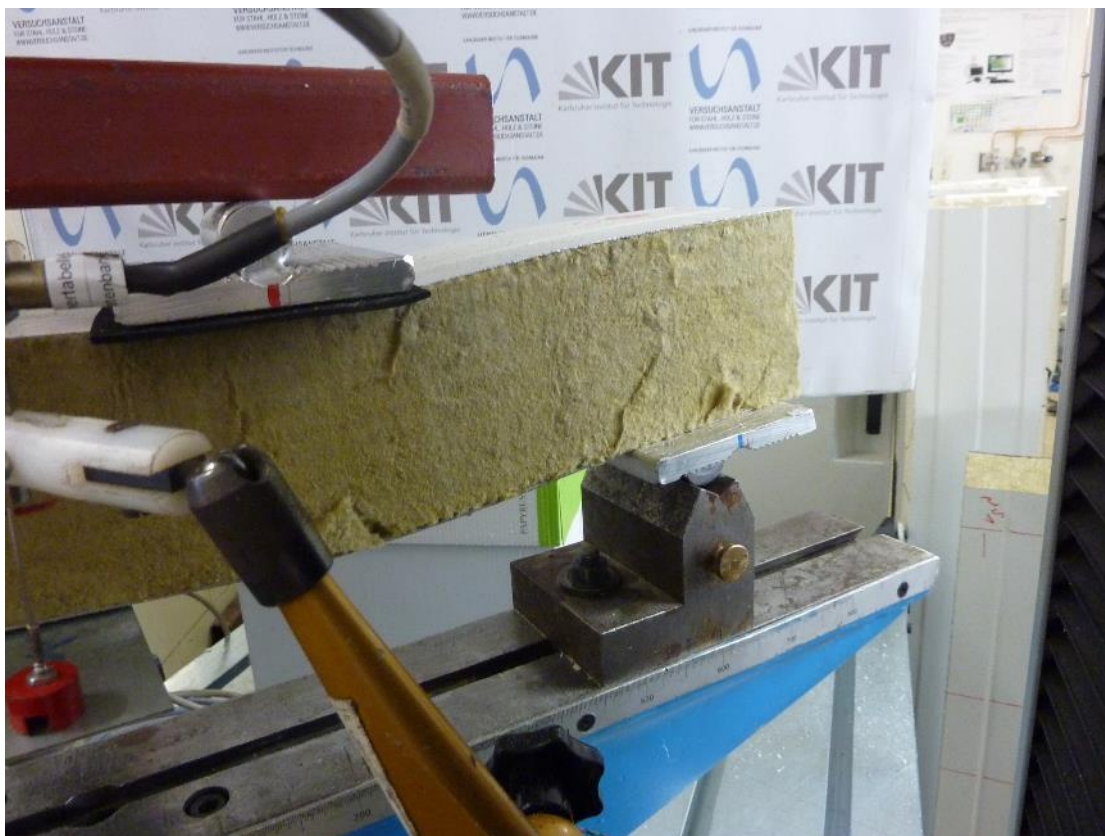
Abb. 4.11: Versagensbild Schubbruch Versuch S01
