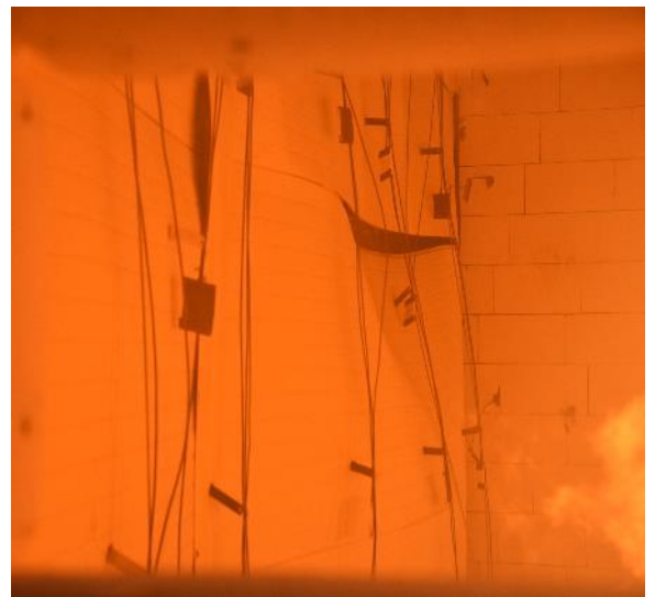
Abb. 9.8: Leichter Rauaustritt Fuge I (20')
