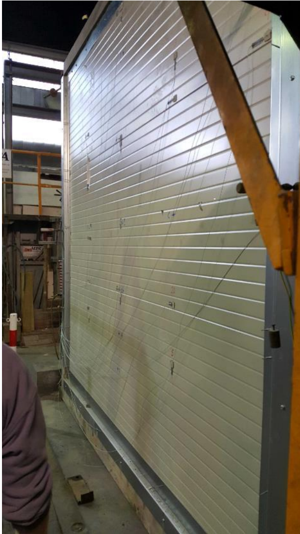
Abb. 7.5: Verformung zum Brandraum (16')
