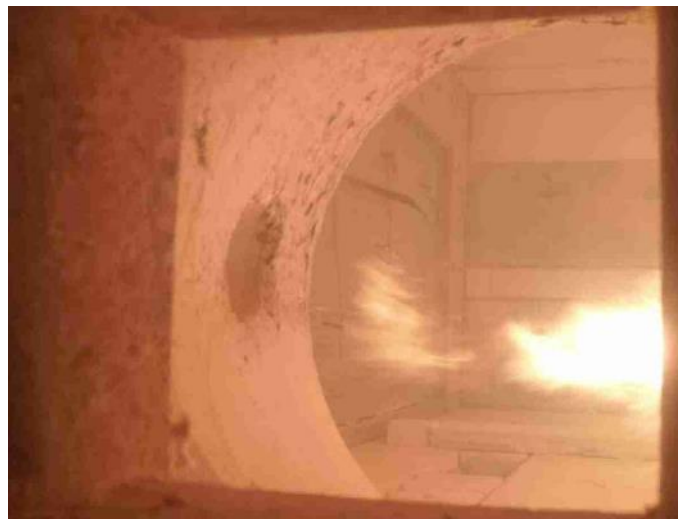
Abbildung 1: Feuerwiderstandsprüfung Sandwichwand Höhe 3m, Breite 6m horizontal verlegt
