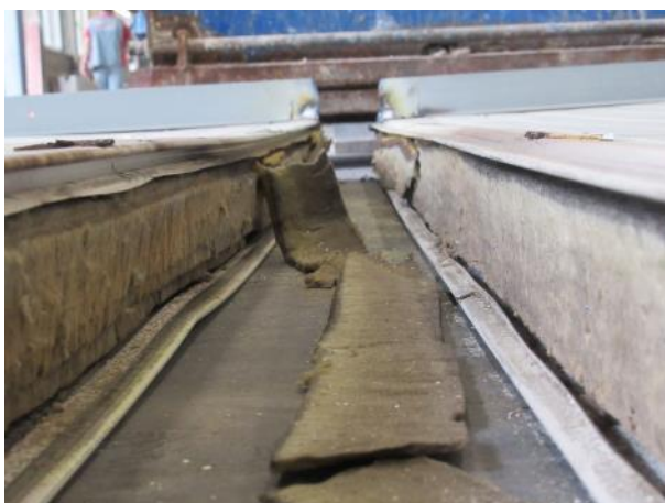
Abb. 10.18: Elemente mit Mineralwollstreifen
