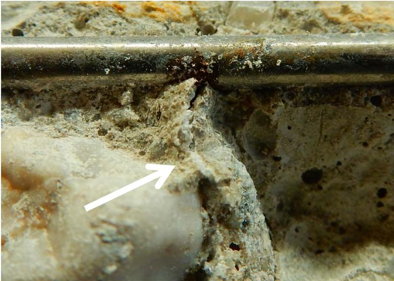
Abbildung 29 Riss mit Reaktionsprodukt, Prüfkörper Prüfkörper 8
