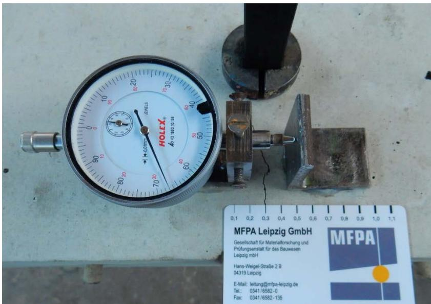
Abbildung 7 optische Rissmessung und Verschiebungsmessung mit Messuhr, schematisch
