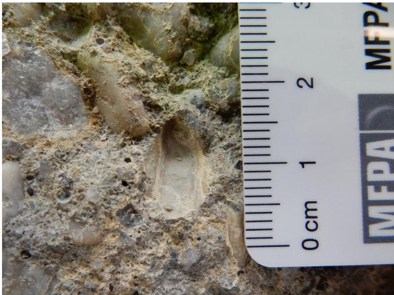
Abbildung 9 Detail Rissfläche Versuch Nr. 4 (2015) mit Ablagerungen [2]
