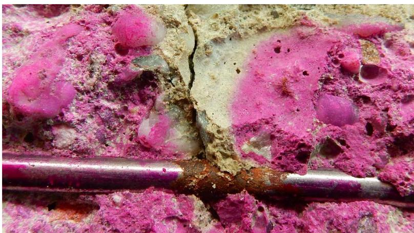
Abbildung 32 korrodierte Bewehrung, Prüfkörper P11, Luftlagerung
