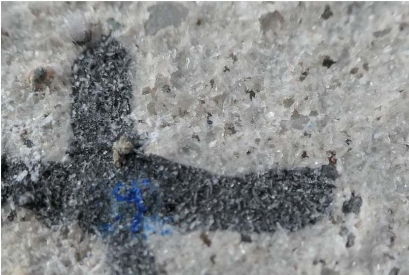
Abbildung 28 Kristalle an der Betonoberfläche, Detail aus Abbildung 27 rechts
