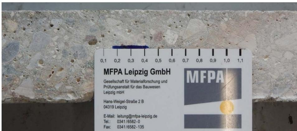
Abbildung 13 Rissbreite Bewehrungslage PK 2, Schnittfläche 2
