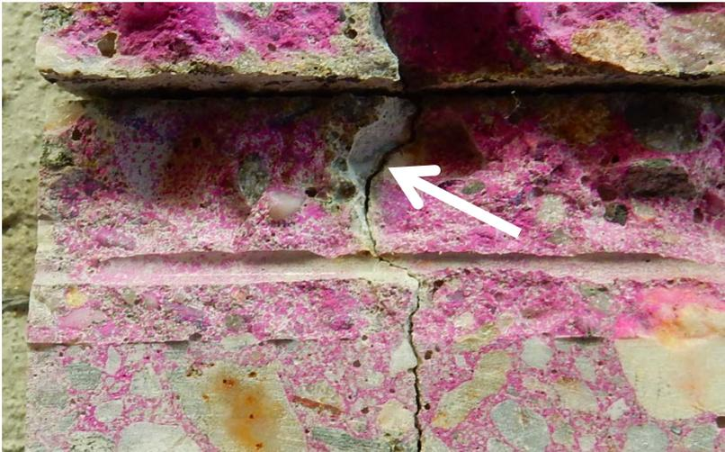
Abbildung 30 Rissflanke mit Reaktionsprodukt, Prüfkörper Pk1
