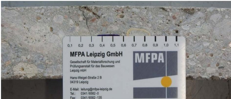
Abbildung 12 Rissbreite Bewehrungslage PK 1, Schnittfläche 2
