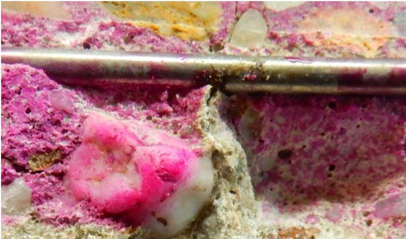
Abbildung 34 Rostansatz, Prüfkörper P8, Flüssigkeit PF3, Einwirkungsseite unten im Bild
