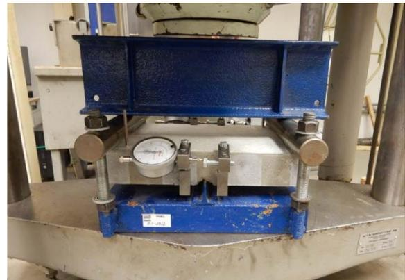
Abbildung 11 Prüfkörper in Einspannvorrichtung mit Messuhren
