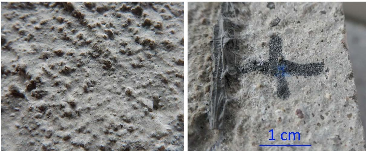
Abbildung 27 Betonoberfläche, links: nur Luftlagerung, rechts: 20 % Säure
