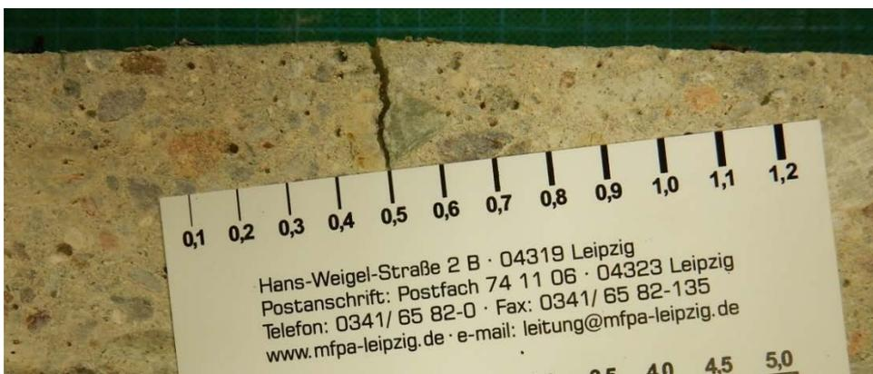
Abbildung 14 Rissbreite Bewehrungslage PK 3, Schnittfläche 2
