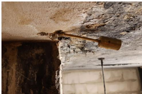
**Abb. 07:** Einspeisung / Tracer mit Tropfenbildung [Quelle: Texplor GmbH]
