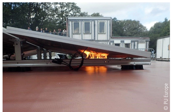
Abb. 5: Versuchsbeginn – Brenner unter den PV-Modulen entzündet
