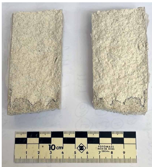
Abb. 15: Eindringtiefe bzw. Saughöhe des Wassers (mit Bleistift nachgezeichnet), Prismen unmittelbar nach Beendigung der Saugversuche gespalten; links: saugender mineralischer Putz, rechts: wasserabweisender Armierungsputz
