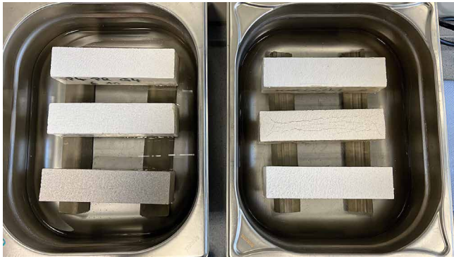
Abb. 10: Versuchsaufbau nach DIN EN ISO 15148 an Prismen und Putzplatten
