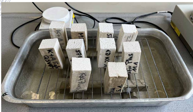
Abb. 11: Versuchsaufbau nach DIN EN 1015-18
