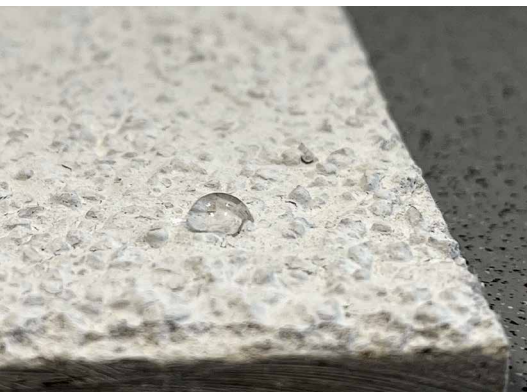
Abb. 16: Benetzungsprobe an einem wasserabweisenden Strukturputz nach 5 min (oben) und 15 min (rechts)
