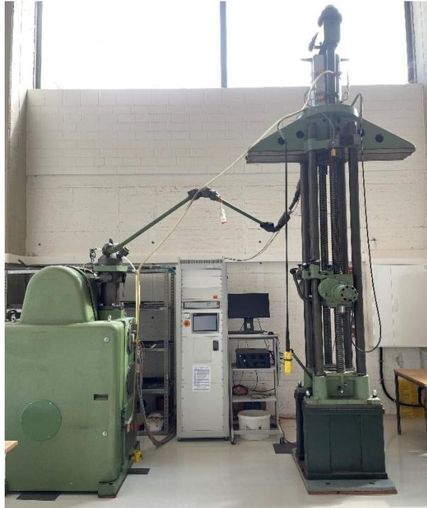
Abb. 5-5: Eingesetzte Universalprüfmaschine „Amsler“
