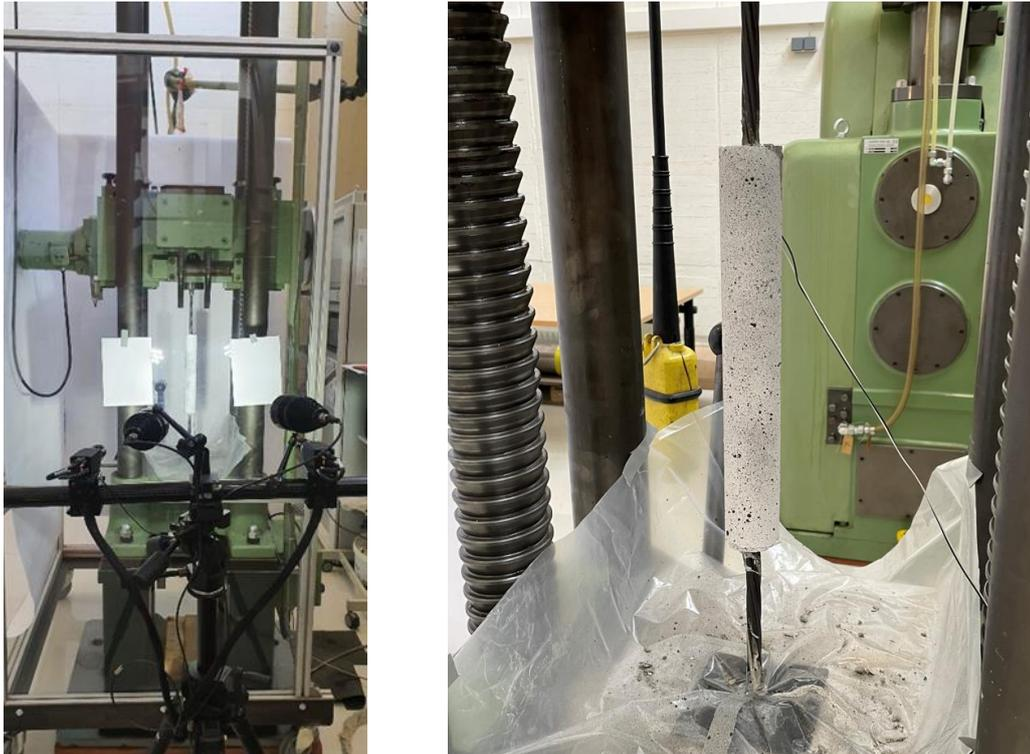
Abb. 6-1: ARAMIS-System am Versuchskörper „mDSV-UHFB-250-S-2“
