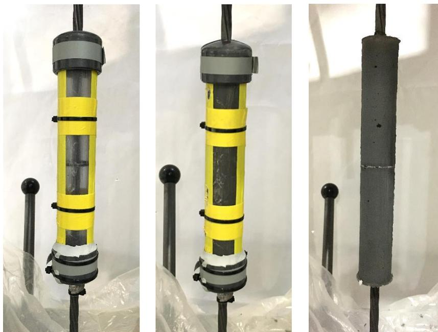
Abb. 5-4: Herstellung der Probekörper
