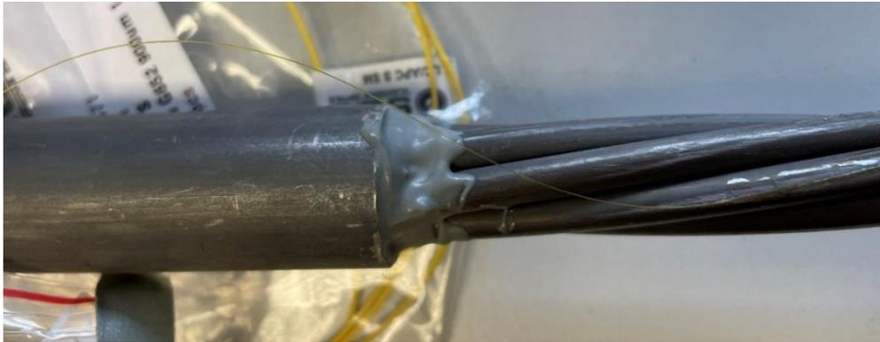
Abb. 6-3: Vorbereitung einer Spannstahlilitze für das „Luna-Messsystem“
