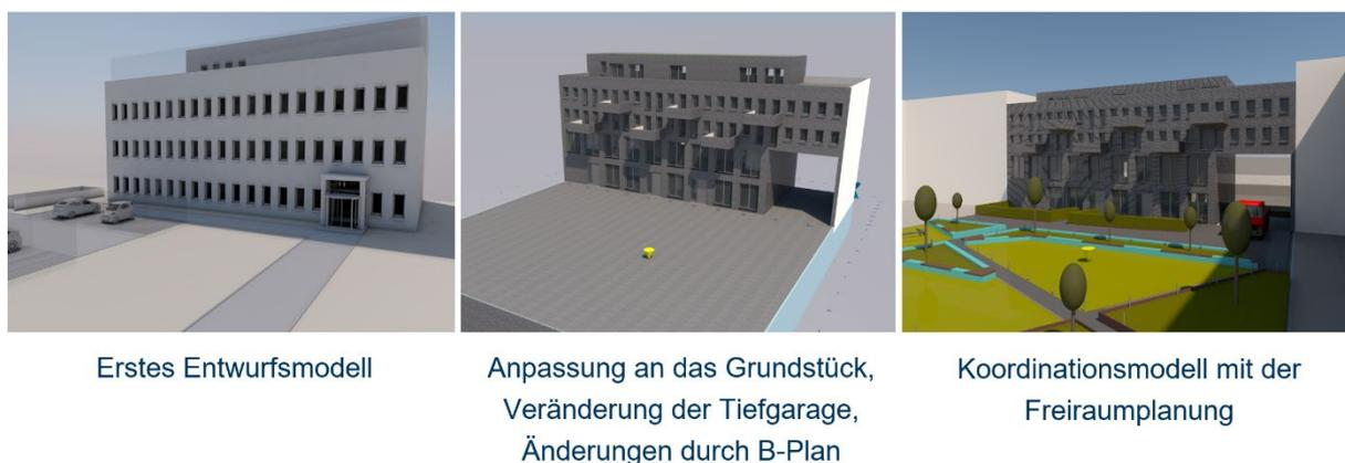
Abbildung 17: Historie mit fortlaufendem Entwurf, vom ersten Entwurfsmodell (links), zum aktuellen BIM-Modell (Mitte) und als Koordinationsmodell mit der Freiraumplanung<sup>18</sup> (rechts)
