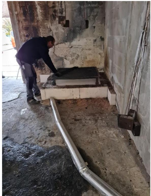
Abb. 7-28: Die Waage wird mit dem Gewicht des Gitterrostwagen und der Isopropanolwannen genullt.
