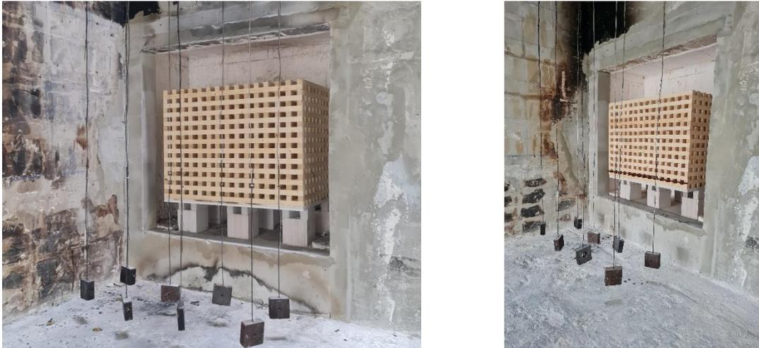
Abbildung 3-12: Anordnung der Holzkrippe in der Brandkammer beim Large-Exposure-Test (links) sowie Holzweichfaserplattenstreifen als Zündinitial (rechts)
