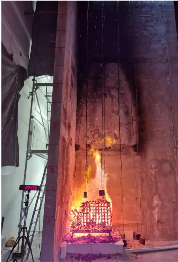
Abb. 7-160: Versuch 10 bei ca. 25 Minuten. Im normalen Brandversuch würde die Krippe jetzt abgelöscht werden.
