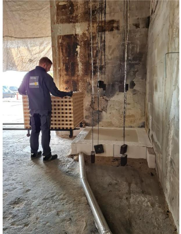
Abb. 7-30: Platzieren der Krippe mit Gitterrostwagen auf der Wiegeeinrichtung.
