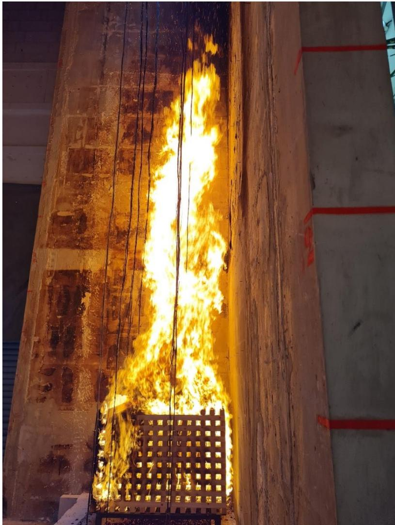
Abbildung 3-25: Exemplarische Darstellung der Flammenausbildung oberhalb der Holzkippe parallel zur Rückwand
