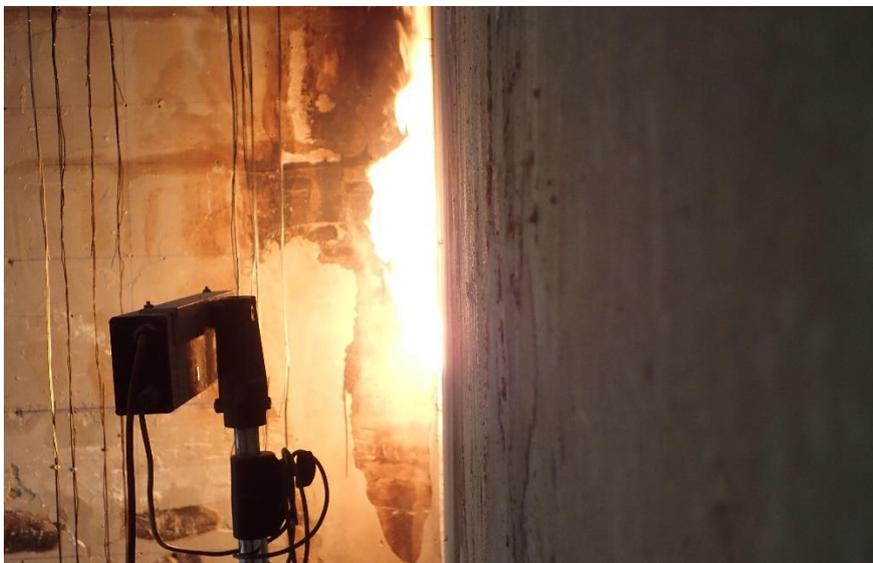
Abbildung 3-11: Exemplarische Darstellung der Flammenausbildung oberhalb der Brandkammern auf der Rückwand
