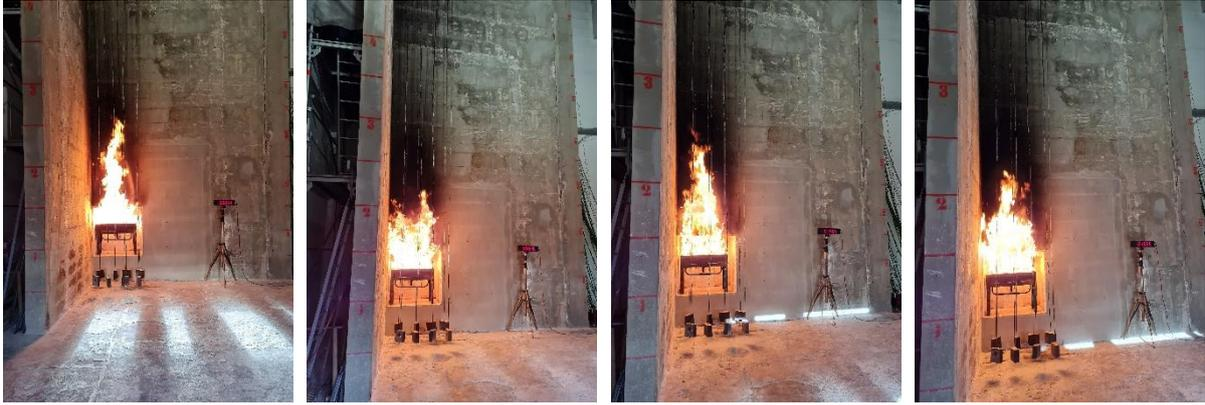
Abbildung 3-10: Brandbeanspruchung in der 1., 6., 15. und 20. Prüfminute
