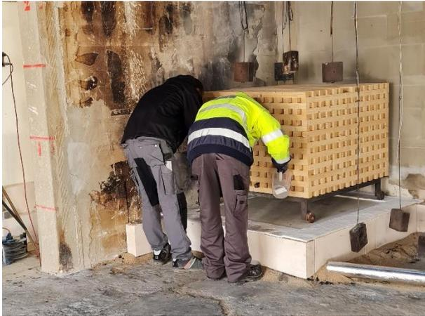
Abb. 7-33: Einfüllen des Isopropanols in die Wannen.
