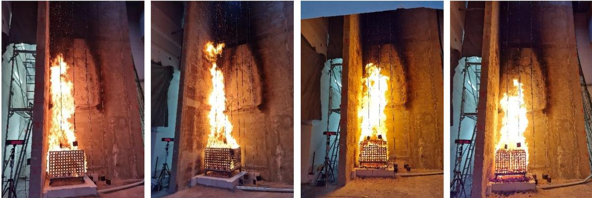
Abbildung 3-24: Brandbeanspruchung in der 5., 9., 18. Und 21. Prüfminute
