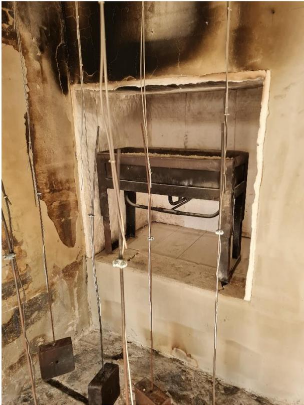
Abb. 7-10: Anordnung des Brenners in der Brandkammer
