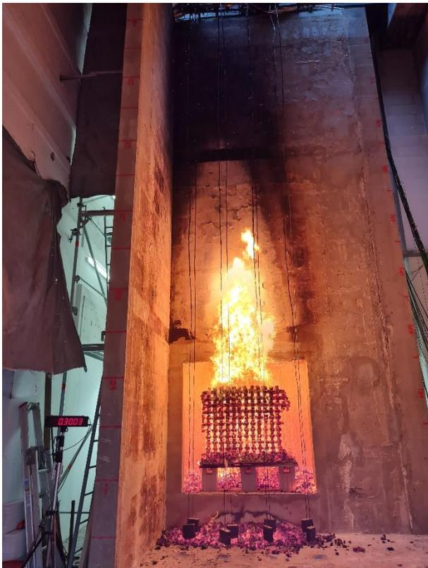
Abb. 7-93: Versuch 8 bei 30:03 Minuten. Ein normaler Brandversuch endet nach 30 Minuten.
