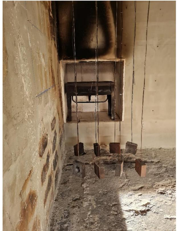
Abb. 7-11: Anordnung der Messbäume und Thermoelemente entspricht der Medium-Exposure-Tests.
