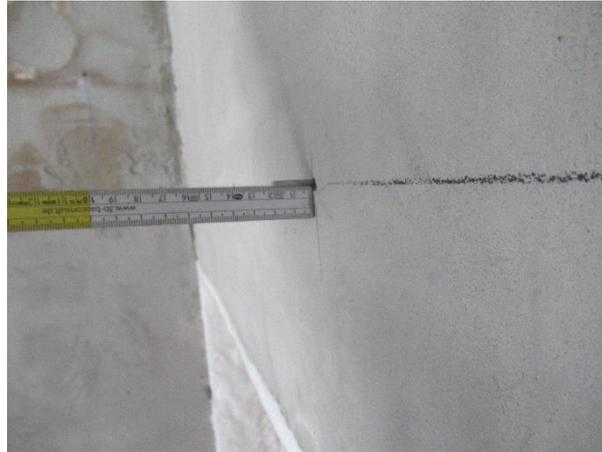
Abb. 7-6: Die Thermoelemente an der Oberfläche stehen 20 mm vor die Prüfstandwand.
