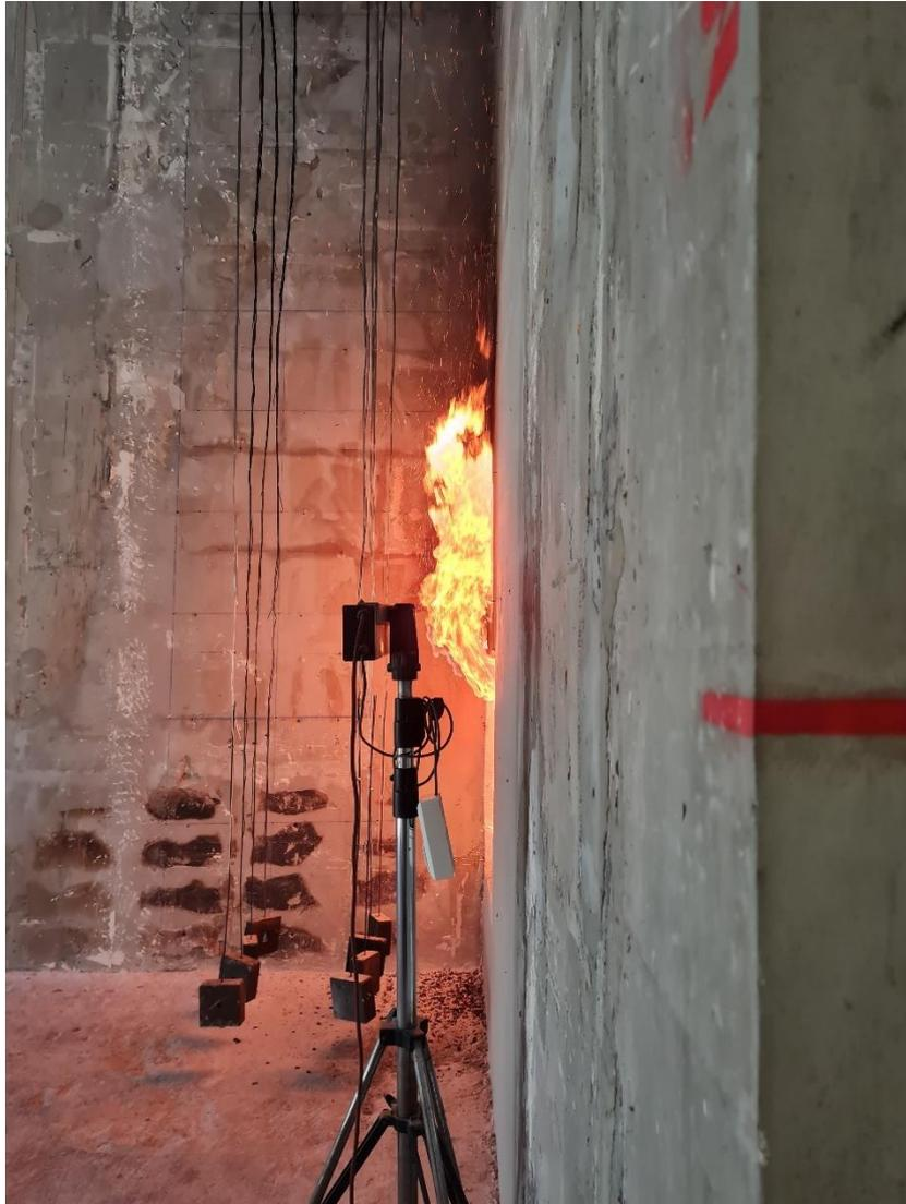
Abbildung 3-7: Exemplarische Darstellung der Flammenausbildung oberhalb der Brandkammern auf der Rückwand
