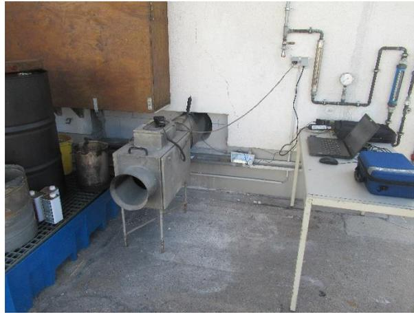
Abb. 7-2: Maschinelle Belüftung und Messtechnik für die Wiegeeinrichtung
