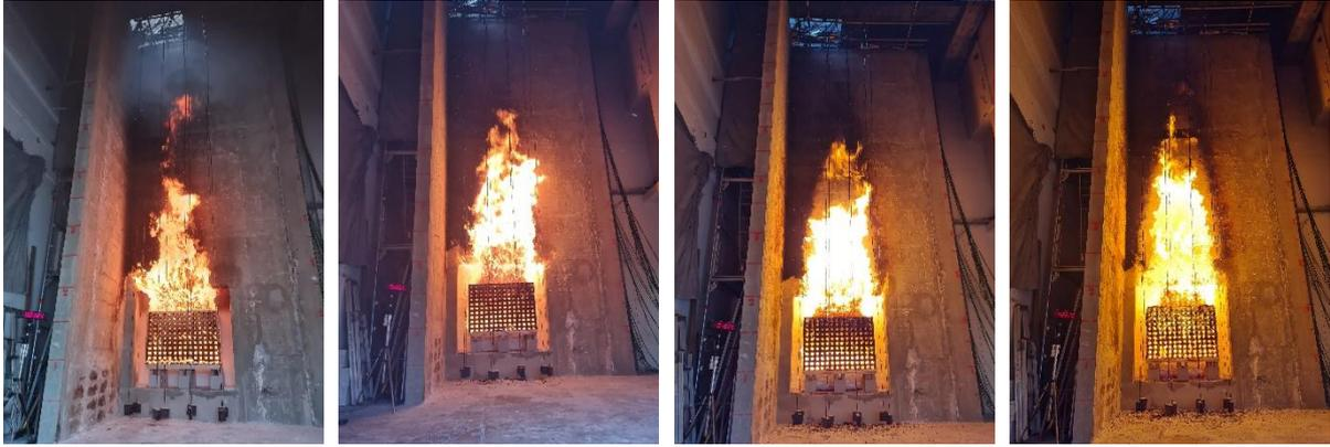
Abbildung 3-17: Brandbeanspruchung in der 3., 6., 16. und 22. Prüfminute
