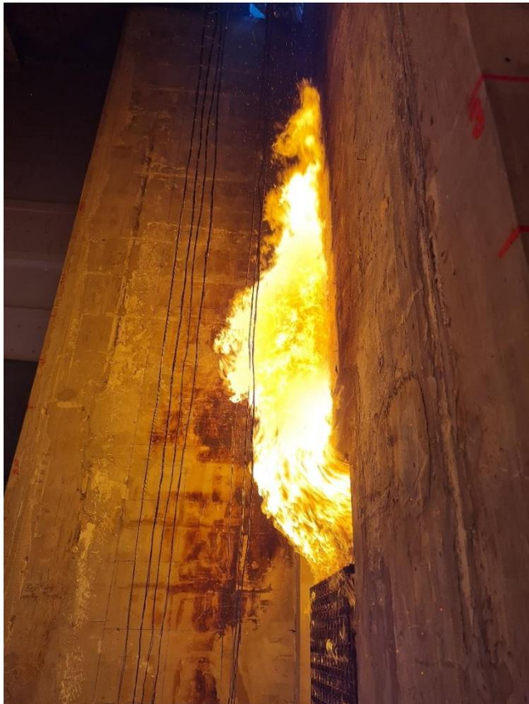
Abbildung 3-18: Exemplarische Darstellung der Flammenausbildung oberhalb der Brandkammern auf der Rückwand
