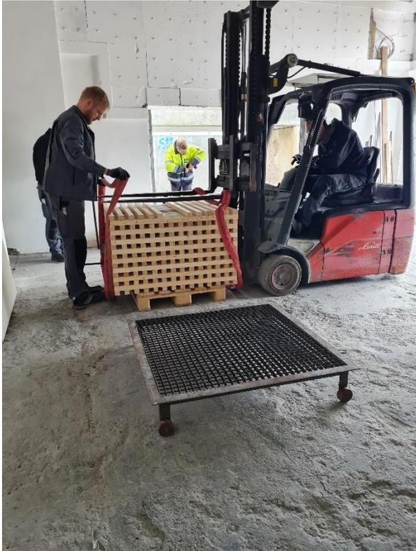
Abb. 7-29: Aufsetzen der Holzkippe auf den Gitterrostwagen.
