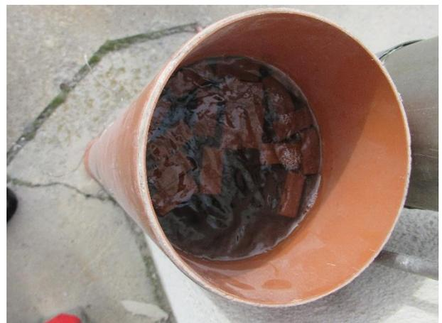
Abb. 7-18: Tränken der Holzweichfaserplattenstreifen.
