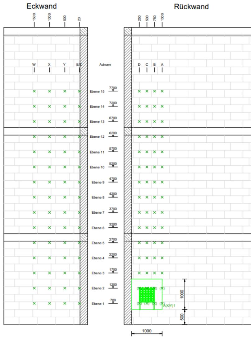
Abbildung 3-2: Anordnung der Thermoelemente beim Medium-Exposure-Test (Ansicht)
