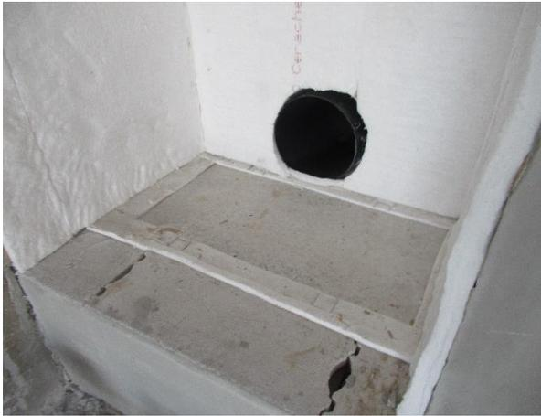
Abb. 7-1: Brandkammerboden mit Wiegeeinrichtung und Zuluftöffnung in der Rückwand
