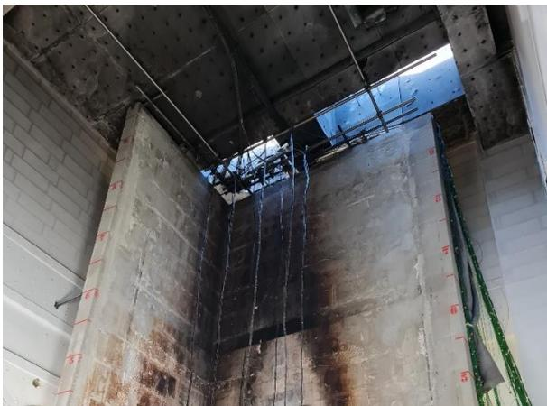
Abb. 7-35: Abluftöffnungen bei Versuch 10 und 11
