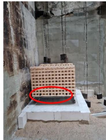
Abbildung 3-19: Aufbau Wiegeeinrichtung (links) und Anordnung Zündinitial (rechts) Wiegeeinrichtung für das Prüffeuer bei den Brandversuche V10 bis V12
