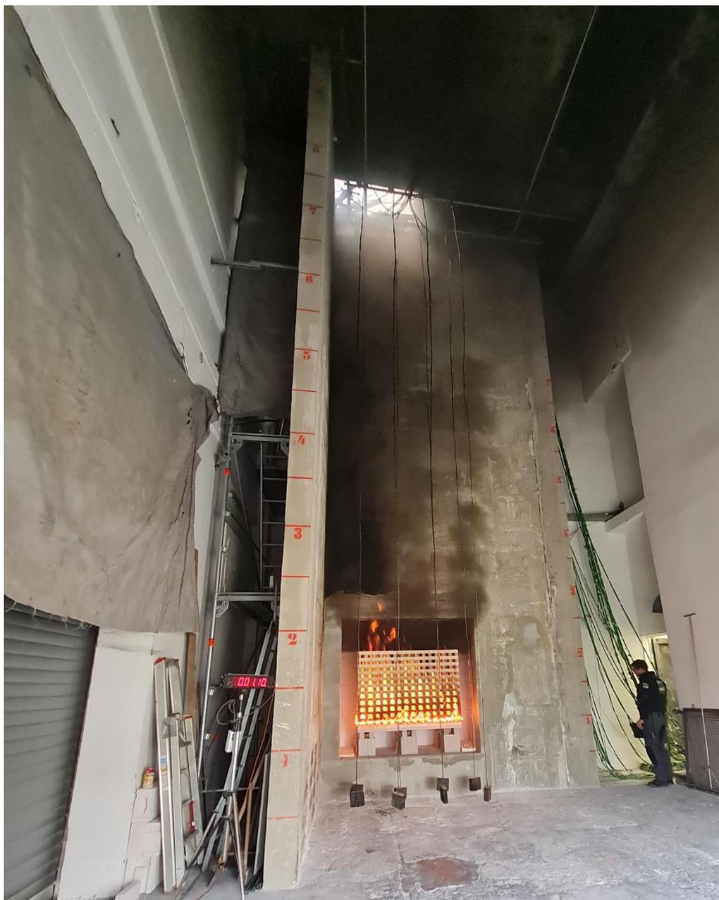
Abb. 7-24: Darstellung des Gesamtprüfstandes mit Abluftöffnung während der Prüfung 7
