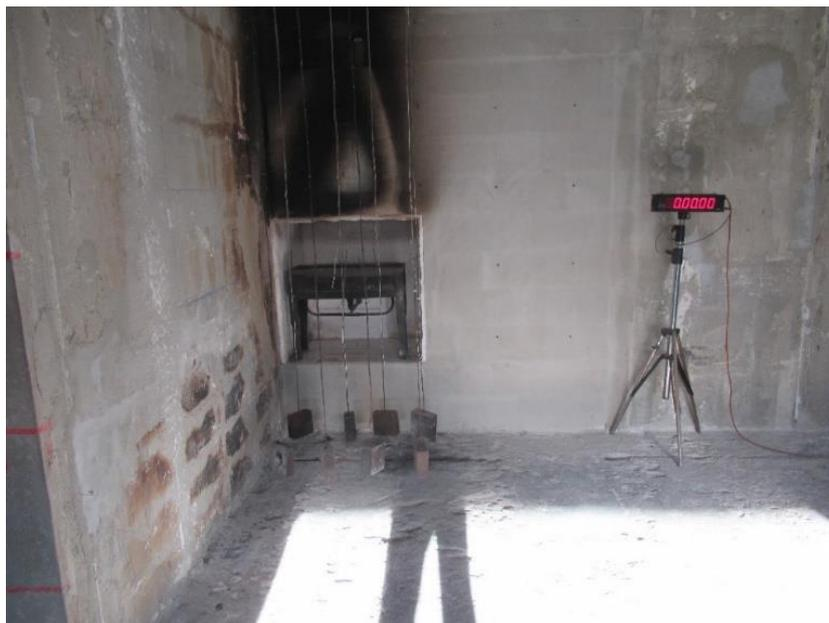
Abbildung 3-8: Anordnung des Brenners in der Brandkammer
