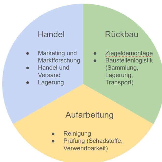
Abbildung 6: Elemente der Qualitätssicherung innerhalb des Prozessablaufes für die Wiederverwendung von Mauerziegeln (nach Holzkamp, 1999, S.117)
