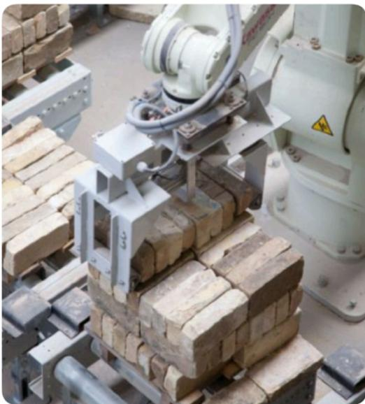
Abbildung 3: Maschinelles Sortieren und Verpacken von gebrauchten Mauerziegel beim dänischen Baustoffhändler Gamle Mursten (Quelle: [3])
