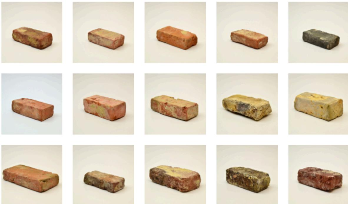
Abbildung 3: Beispiele verschiedener Farben und Farbnuancen von Vollziegeln (Quelle: Rotor vzw/asbl, 2021, S. 3)
