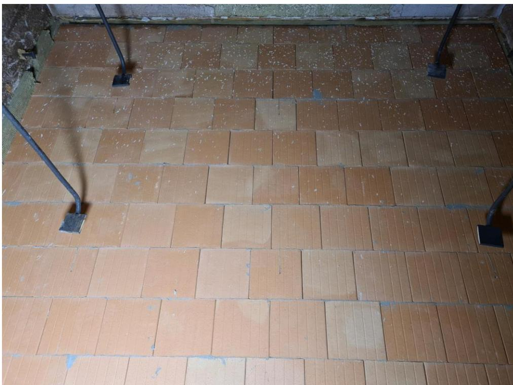
Abb. 6.33: Probekörper brandzugewandte Seite vor Versuchsbeginn
