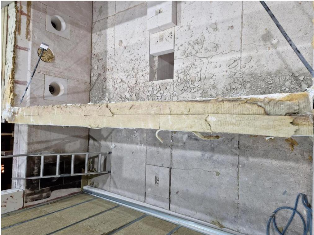
*Abb. 6.148: Draufsicht Bauteilfuge ohne Decke (nach Versuchsende)*
