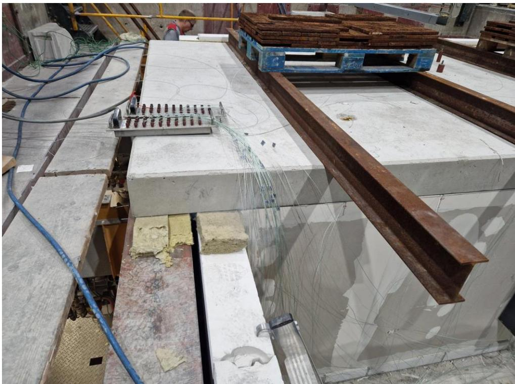
*Abb. 6.66: Rauchaustritt seitlich der Bauteilfuge (4. Brandminute)*
