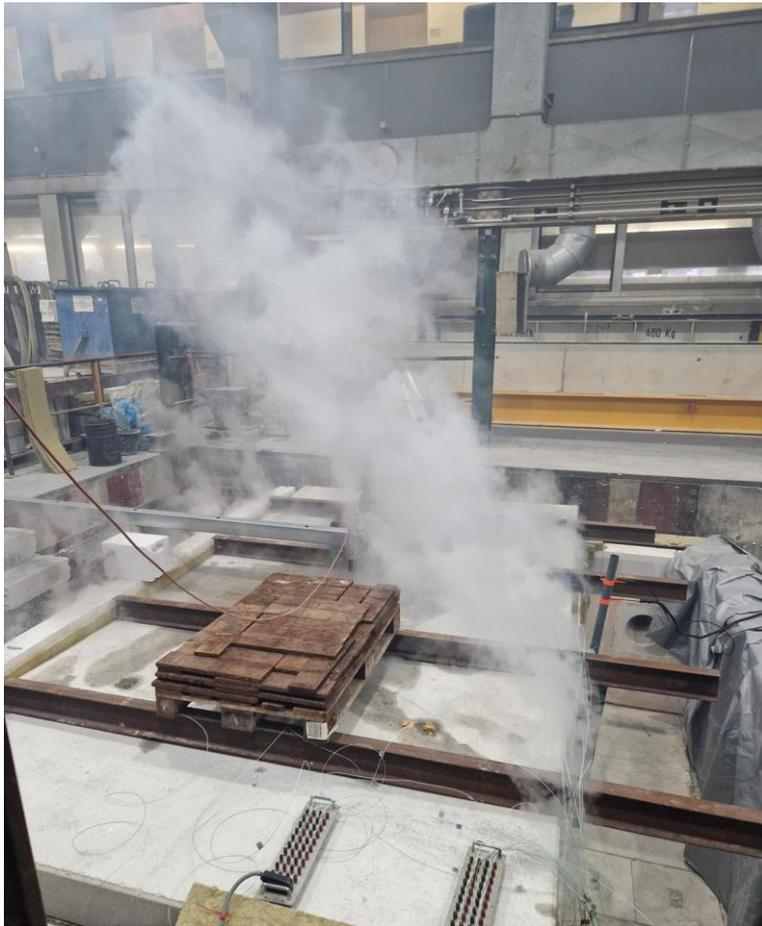
*Abb. 6.107: Starker Rauchaustritt aus Bauteiffuge (70. Brandminute)*
