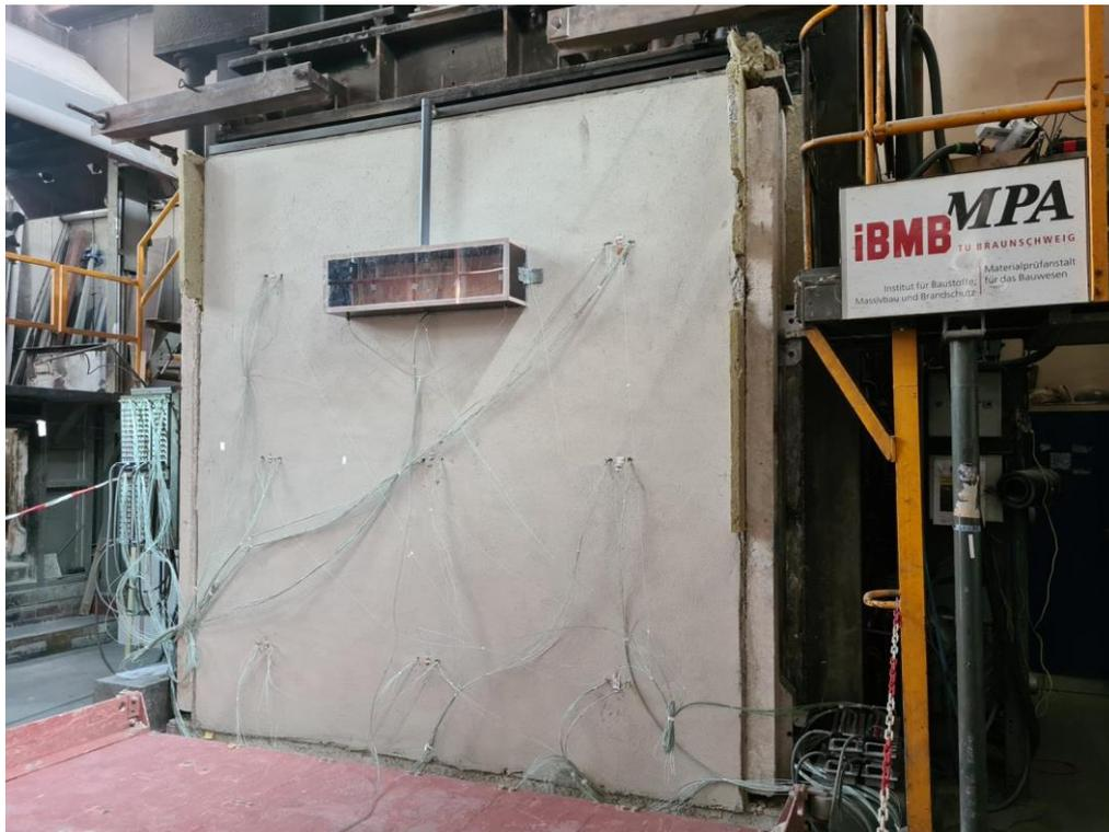
Abb. 6.17: Probekörper brandabgewandte Seite nach Versuchsende
