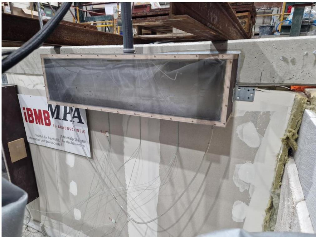
Abb. 6.68: Silikonabdichtung am RAK-Bauteilfuge reißt auf, RAK beschlägt (19. Brandminute)
