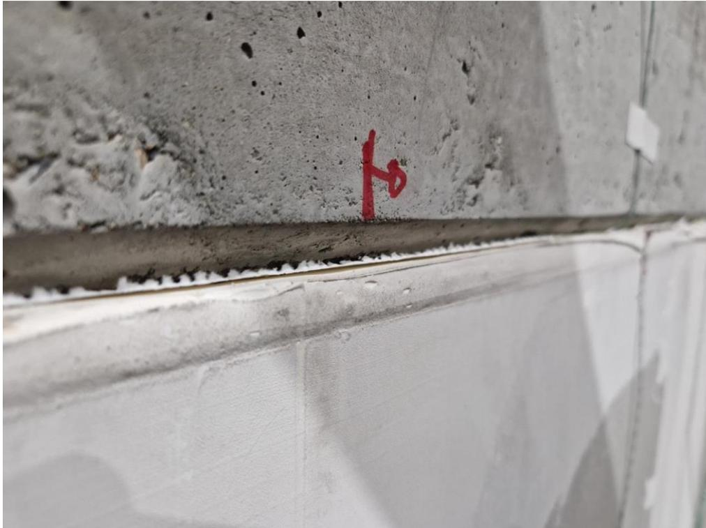
Abb. 6.101: Verputzte Bauteiffuge brandabgewandte Seite (vor Versuchsbeginn)
