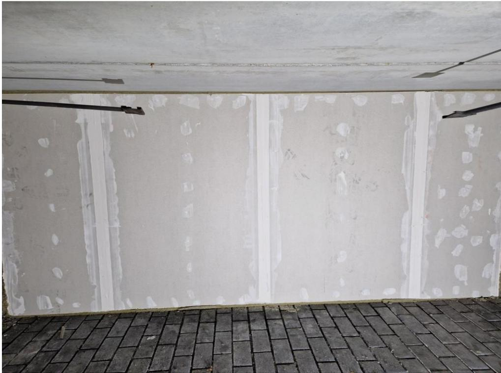
Abb. 6.216: Probekörper brandzugewandte Seite (vor Versuchsbeginn)
