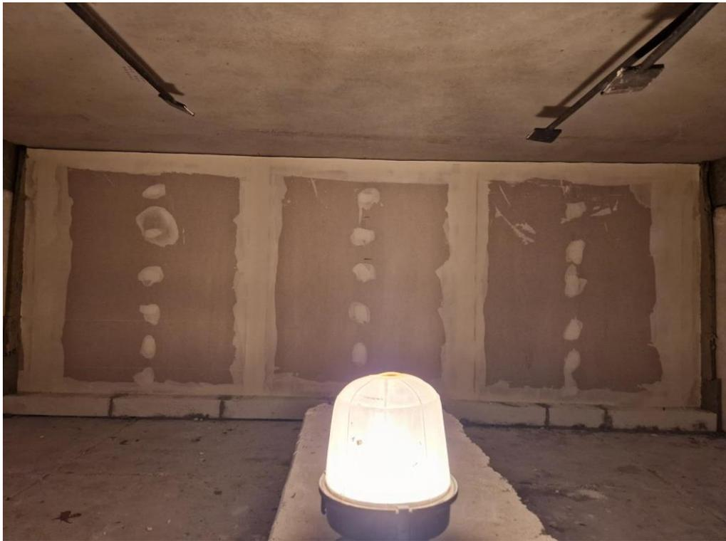
*Abb. 6.65: Probekörper brandzugewandte Seite (vor Versuchsbeginn)*
