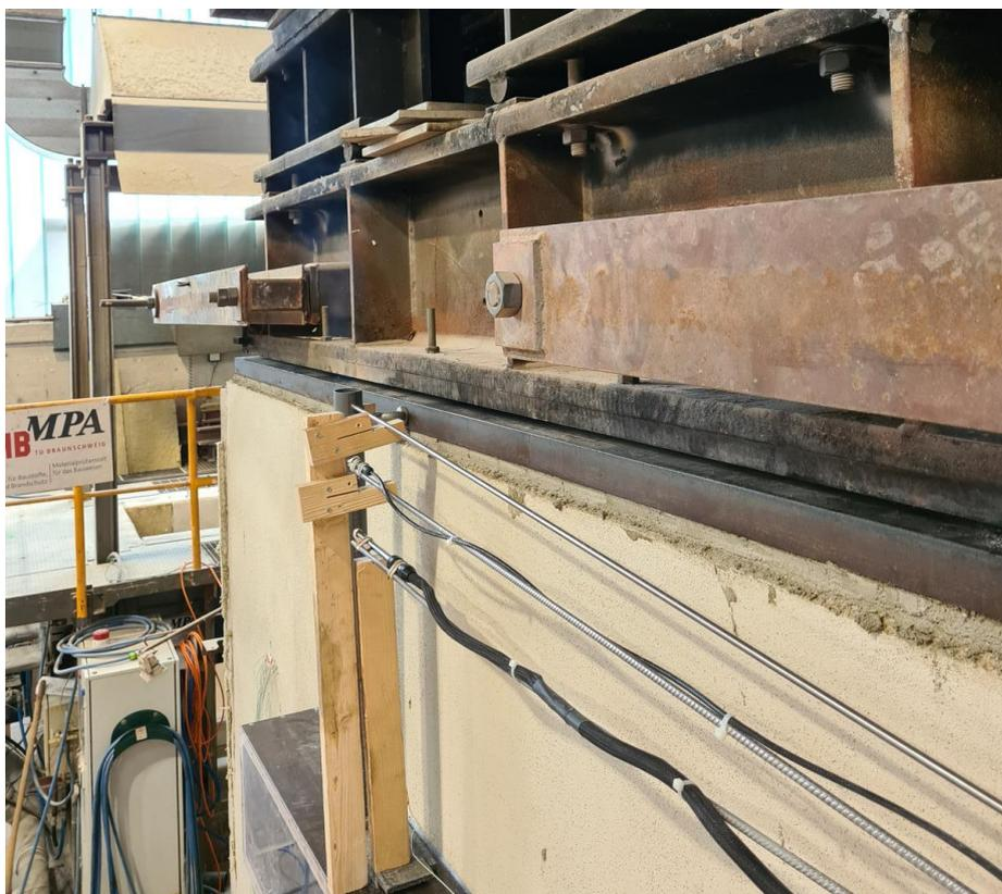
Abb. 6.35: Rauchaustritt am Rohr erkennbar (15. Brandminute)
