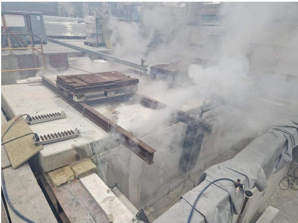
Abb. 6.109: Starke Rauchentwicklung in der Versuchshalle (86. Brandminute)
