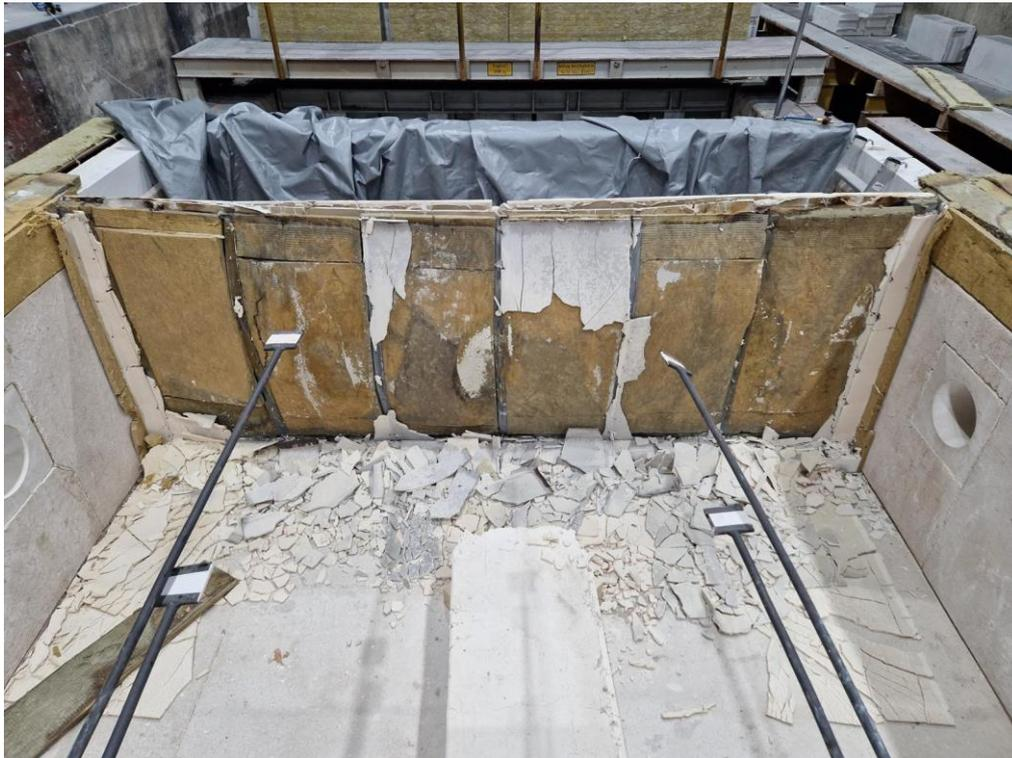
*Abb. 6.73: Probekörper brandzugewandte Seite (nach Versuchsende)*
