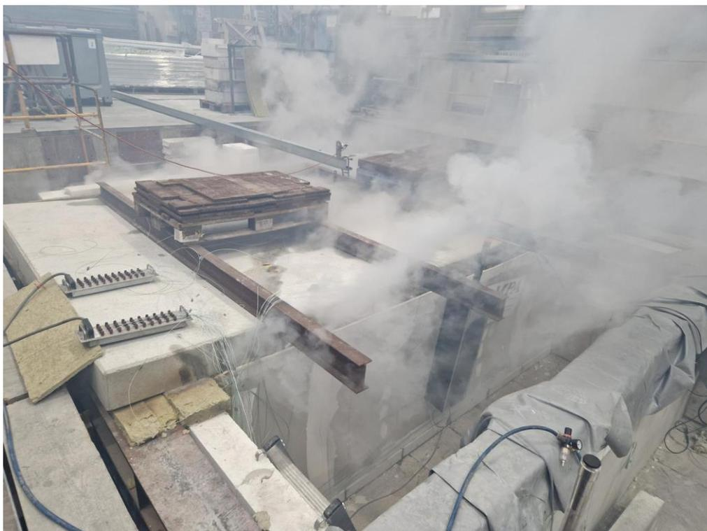
*Abbildung 3.6: Austritt von Wasserdampf beim Versuch 4 (TB-STB) zur 86. Versuchsminute*
