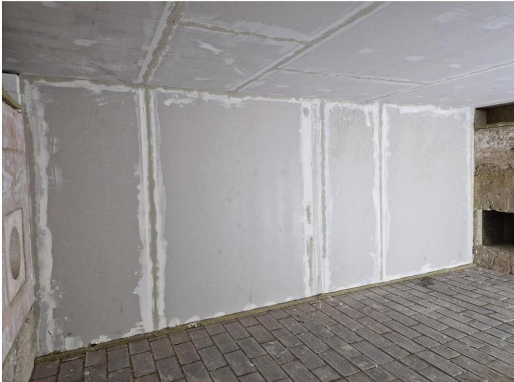
*Abb. 6.178: Probekörper brandzugewandte Seite (vor Versuchsbeginn)*
