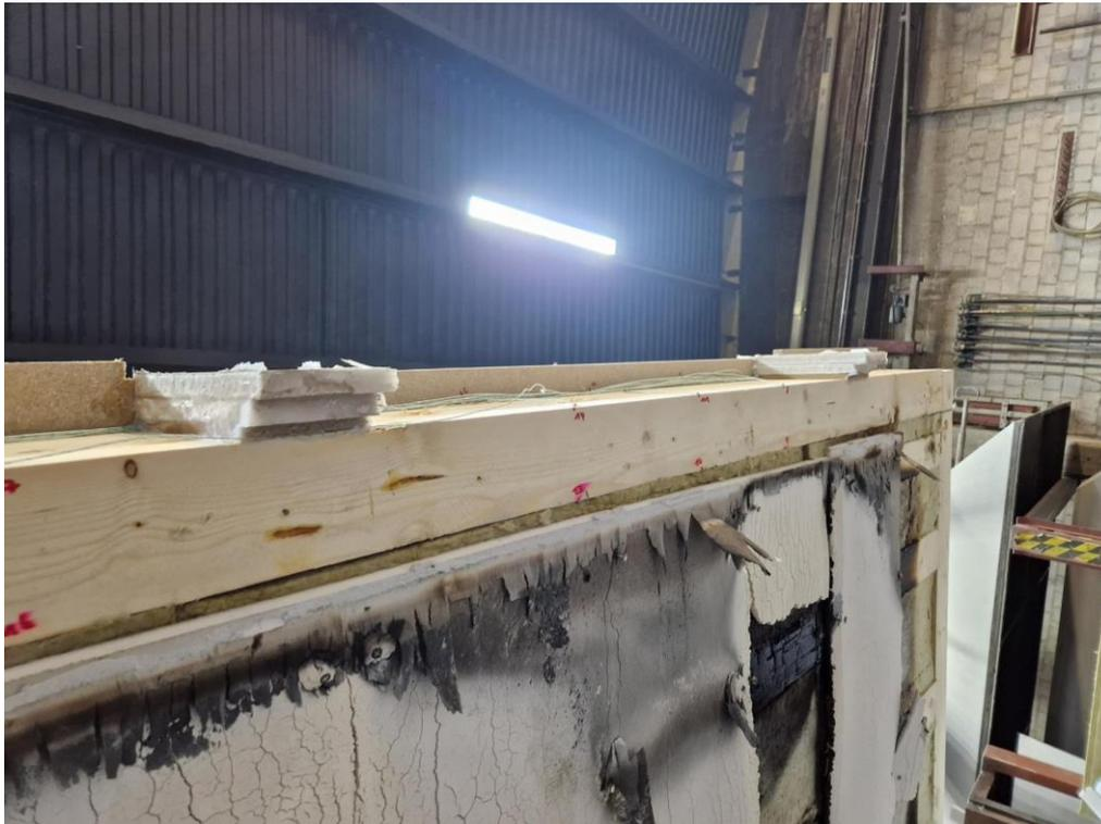
*Abb. 6.184: Verblockung der Decke zur Bauteilfuge (nach Versuchsende und Löscharbeiten)*
