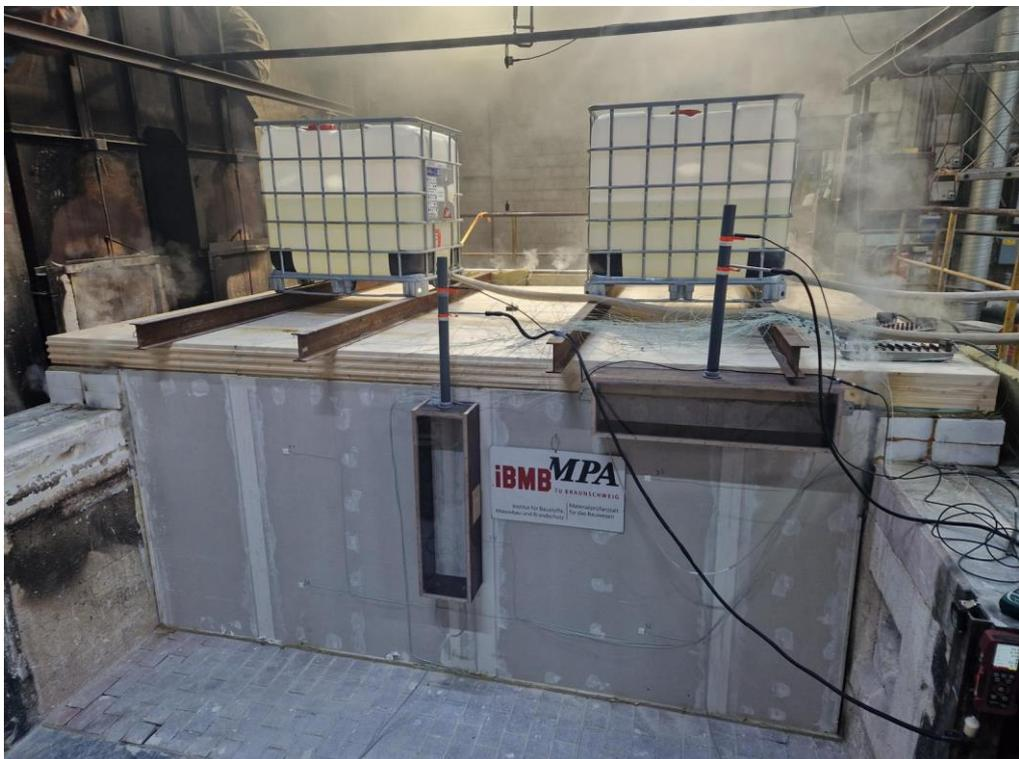
Abb. 6.259: Probekörper brandabgewandte Seite (nach Versuchsende)
