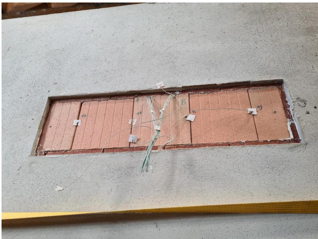
Abb. 6.18: Stoßfugen brandabgewandte Seite nach Versuchsende
