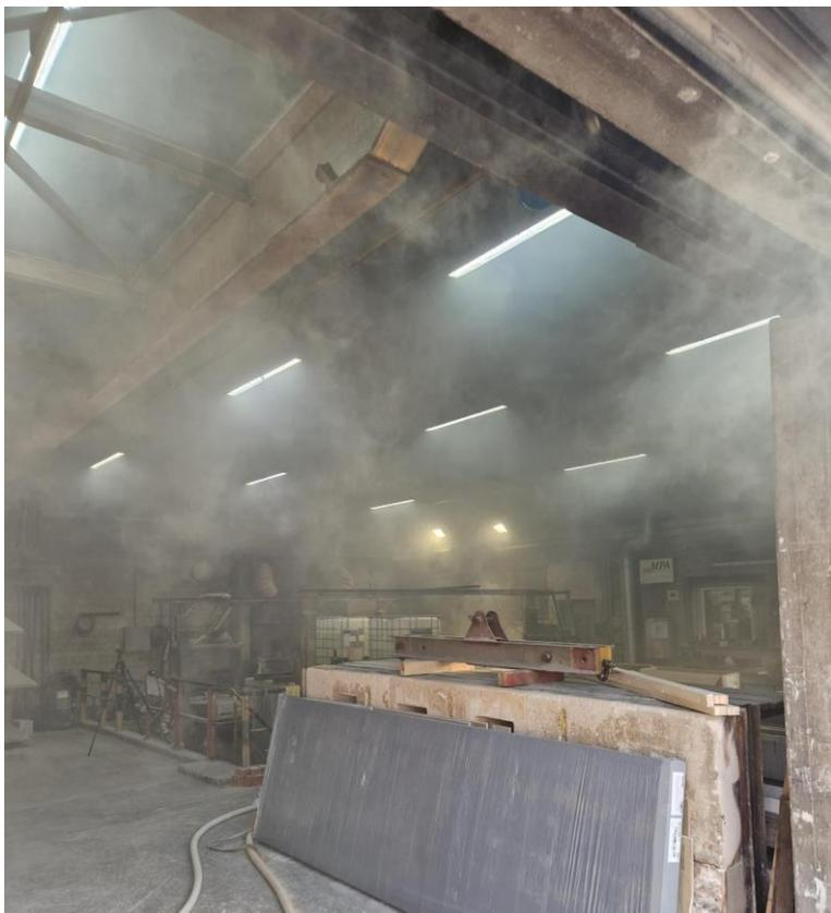
Abb. 6.257: Rauchausbreitung in der Versuchshalle (38. Brandminute)
