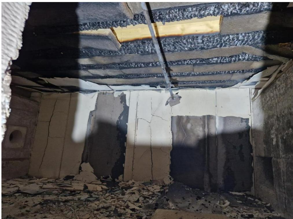
Abb. 6.183: Probekörper brandzugewandte Seite (nach Versuchsende und Löscharbeiten)
