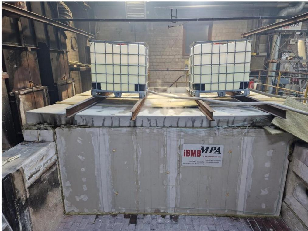
Abb. 6.220: Probekörper brandabgewandte Seite (nach Versuchsende)
