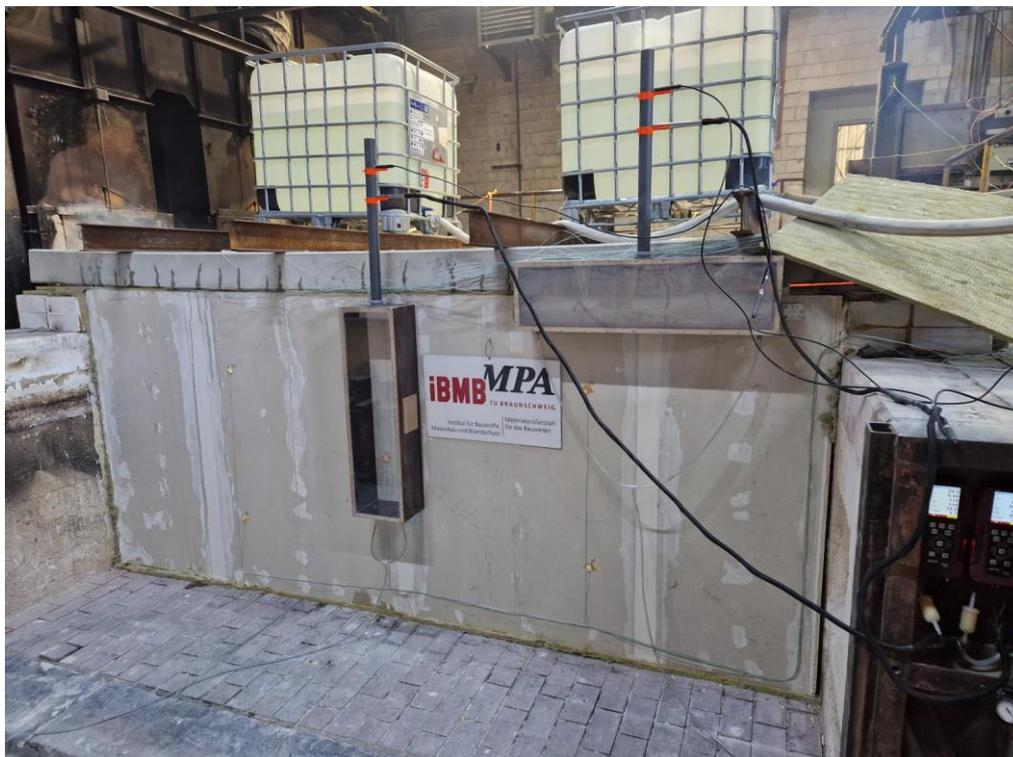
Abb. 6.218: Feuerschein durch Bauteilfuge am RAK-Bauteilfuge (30. Brandminute)
