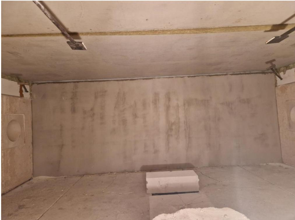
Abb. 6.142: Probekörper brandzugewandte Seite (vor Versuchsbeginn)
