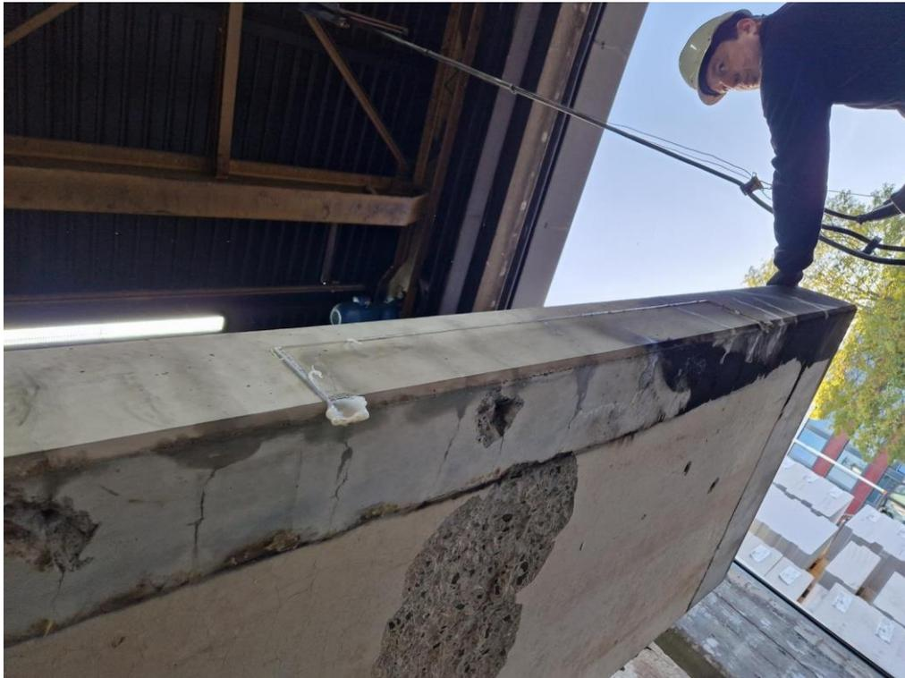
*Abb. 6.222: Unterseite Decke im Bereich der Bauteilfuge (nach Versuchsende)*
