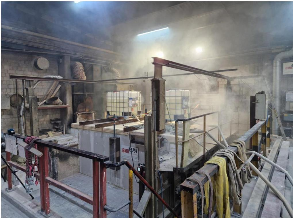
Abb. 6.256: Auslösung CO-Warner und Verlassen der Versuchshalle (8. Brandminute)
