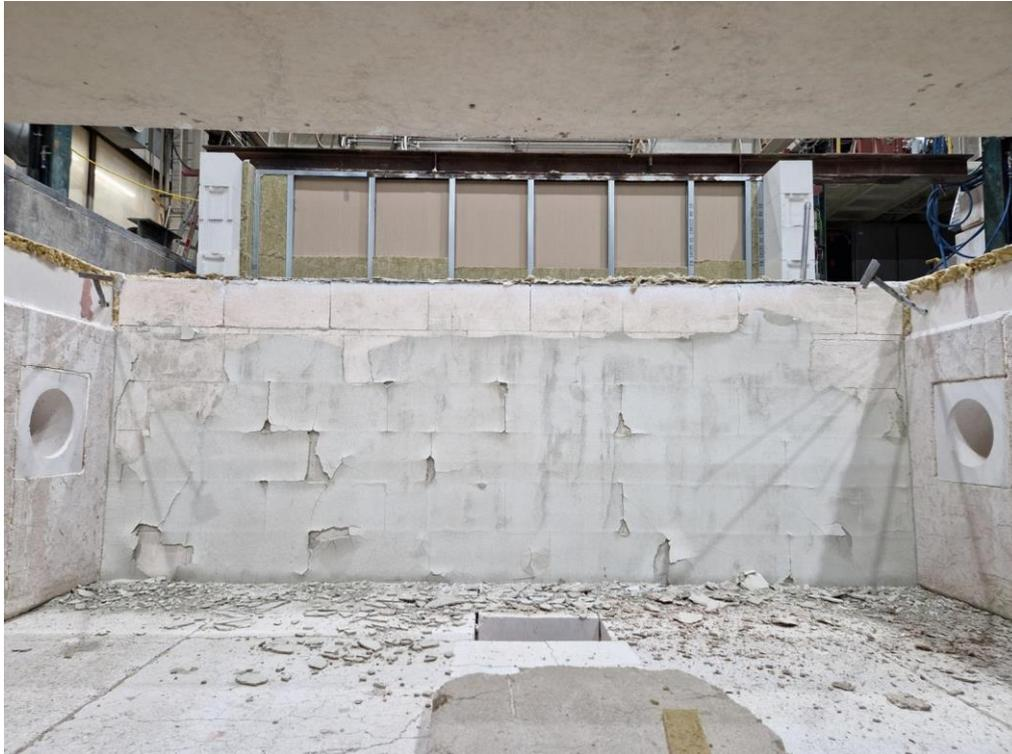
Abb. 6.147: Probekörper brandzugewandte Seite ohne Decke (nach Versuchsende)
