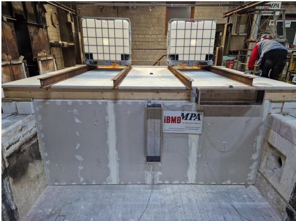
Abb. 6.182: Probekörper brandabgewandte Seite (nach Versuchsende)
