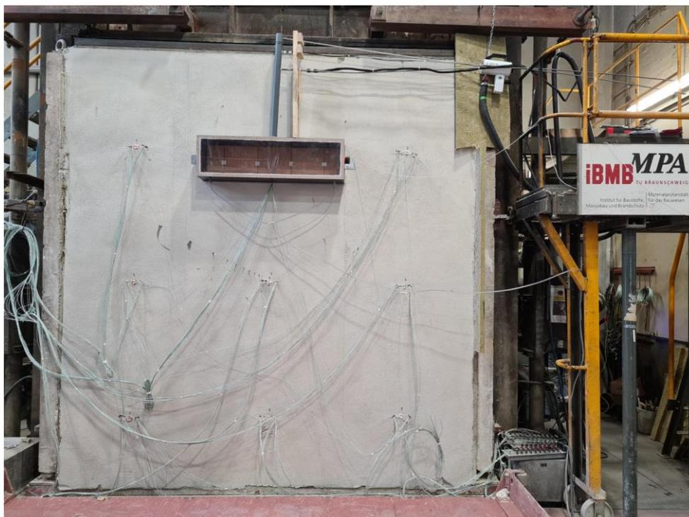
*Abbildung 2.3: Ansicht Versuch 2, brandabgewandte Seite vor Versuchsbeginn (Wandprüfstand)*
