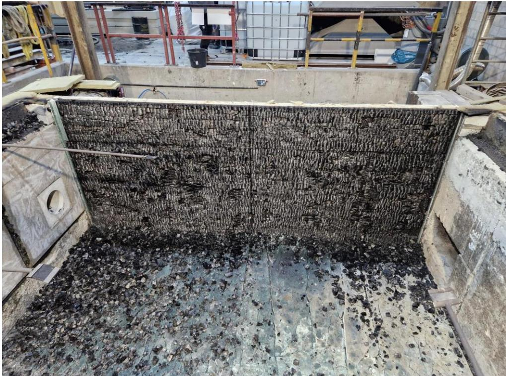
*Abb. 6.260: Probekörper (Wand) brandzugewandte Seite (nach Versuchsende / Löscharbeiten)*
