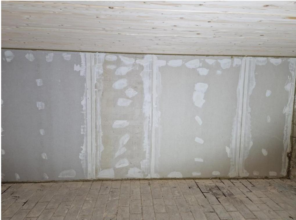
*Abb. 6.254: Probekörper brandzugewandte Seite (vor Versuchsbeginn)*
