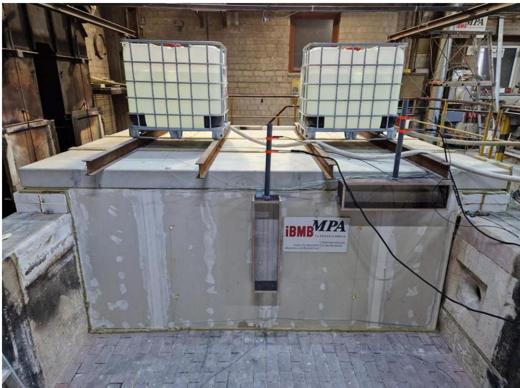
Abb. 6.215: Probekörper brandabgewandte Seite (vor Versuchsbeginn)
