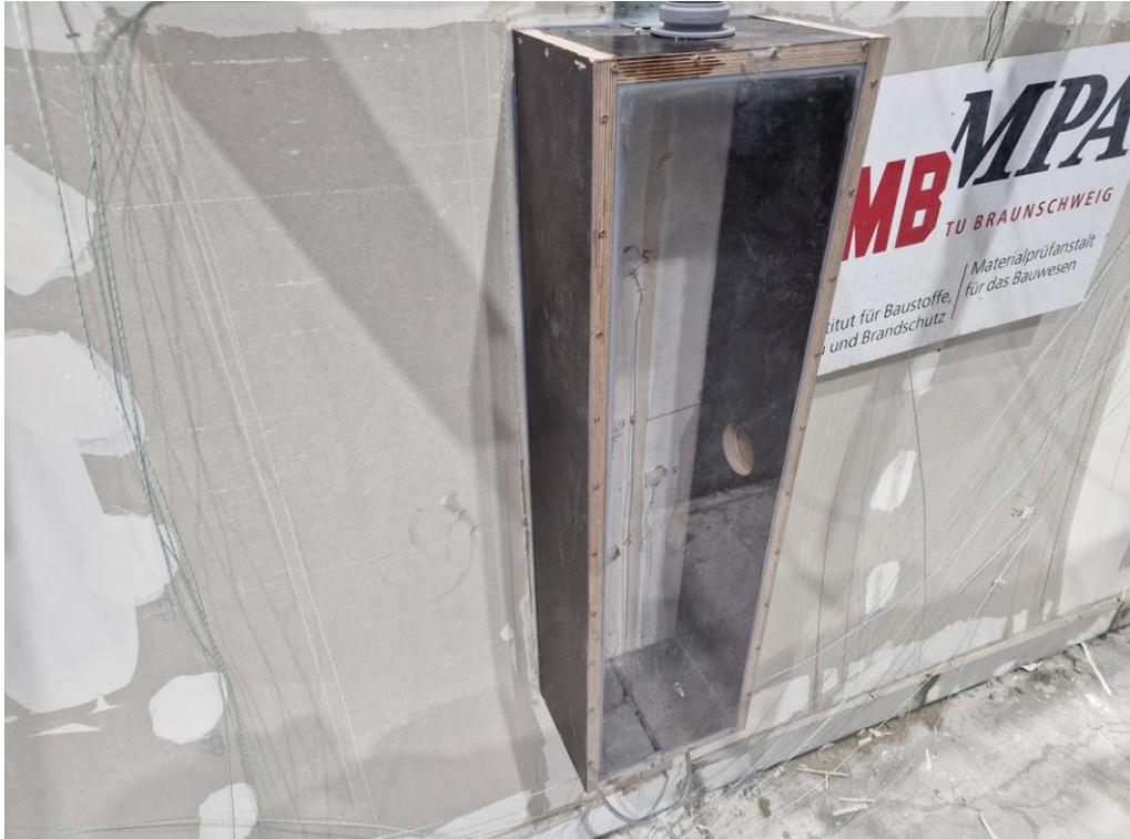
Abb. 6.70: Silikonabdichtung am RAK-Elementfuge reißt auf (57. Brandminute)
