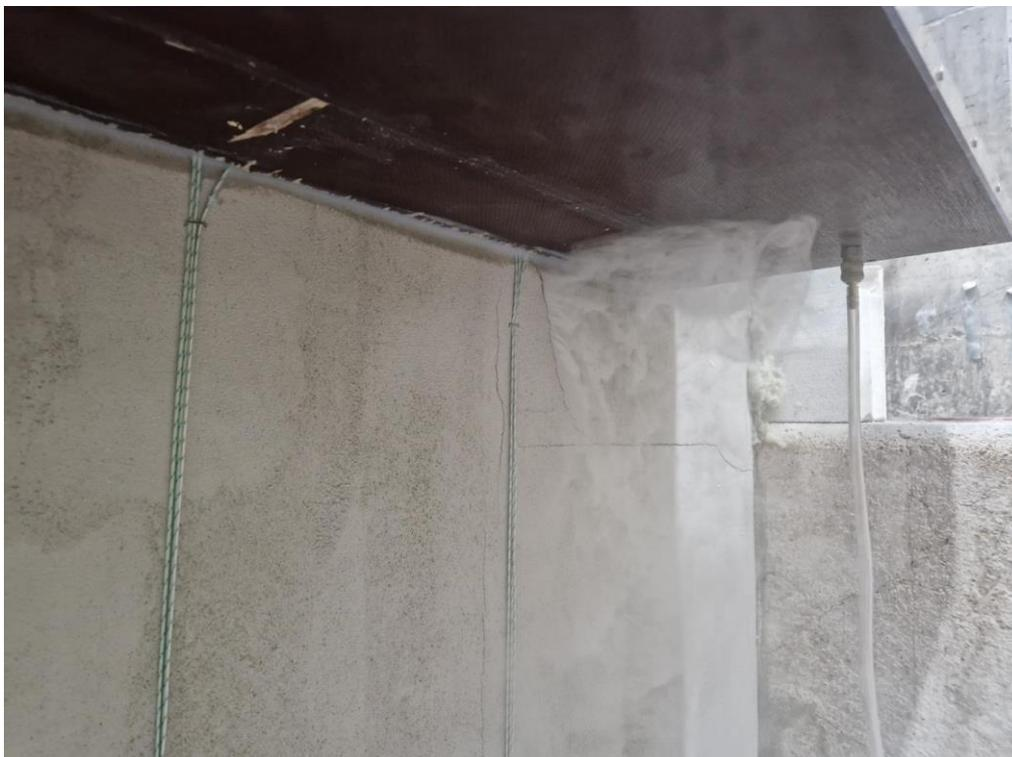
Abb. 6.143: Außenputz beginnt zu reißen, Rauchaustritt unterhalb RAK-Bauteilfuge (14. Brandminute)
