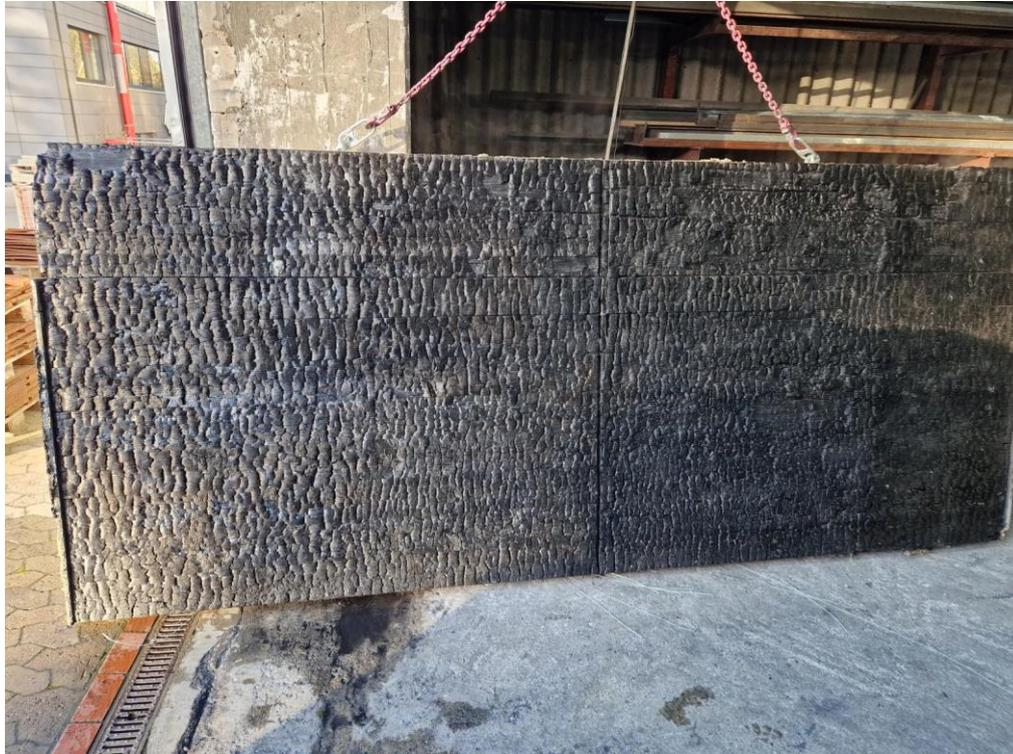
Abb. 6.221: Probekörper (Wand) brandzugewandte Seite (nach Versuchsende)
