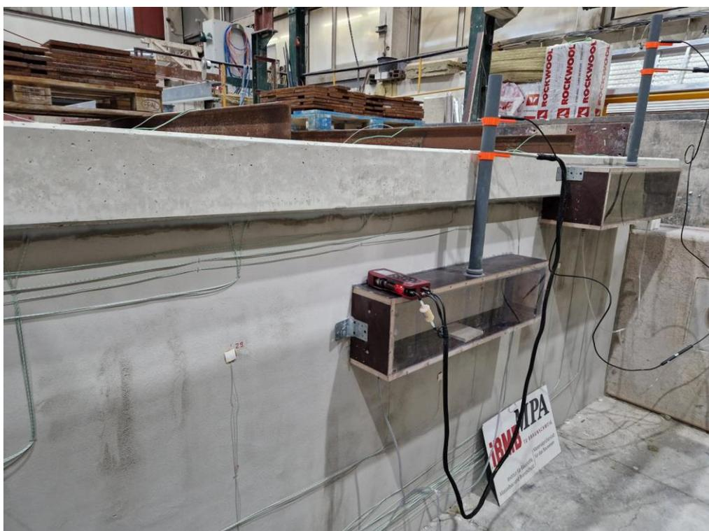
Abb. 6.141: Probekörper brandabgewandte Seite (vor Versuchsbeginn)
