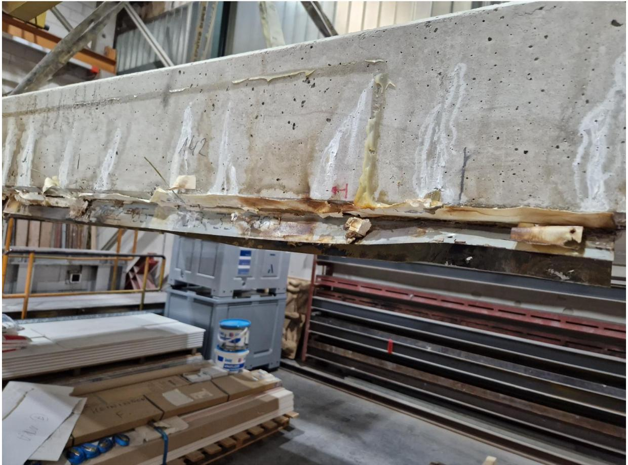
Abb. 6.112: Verschraubtes UW-Profil mit Mineralwolle an Deckenelement (nach Versuchsende)
