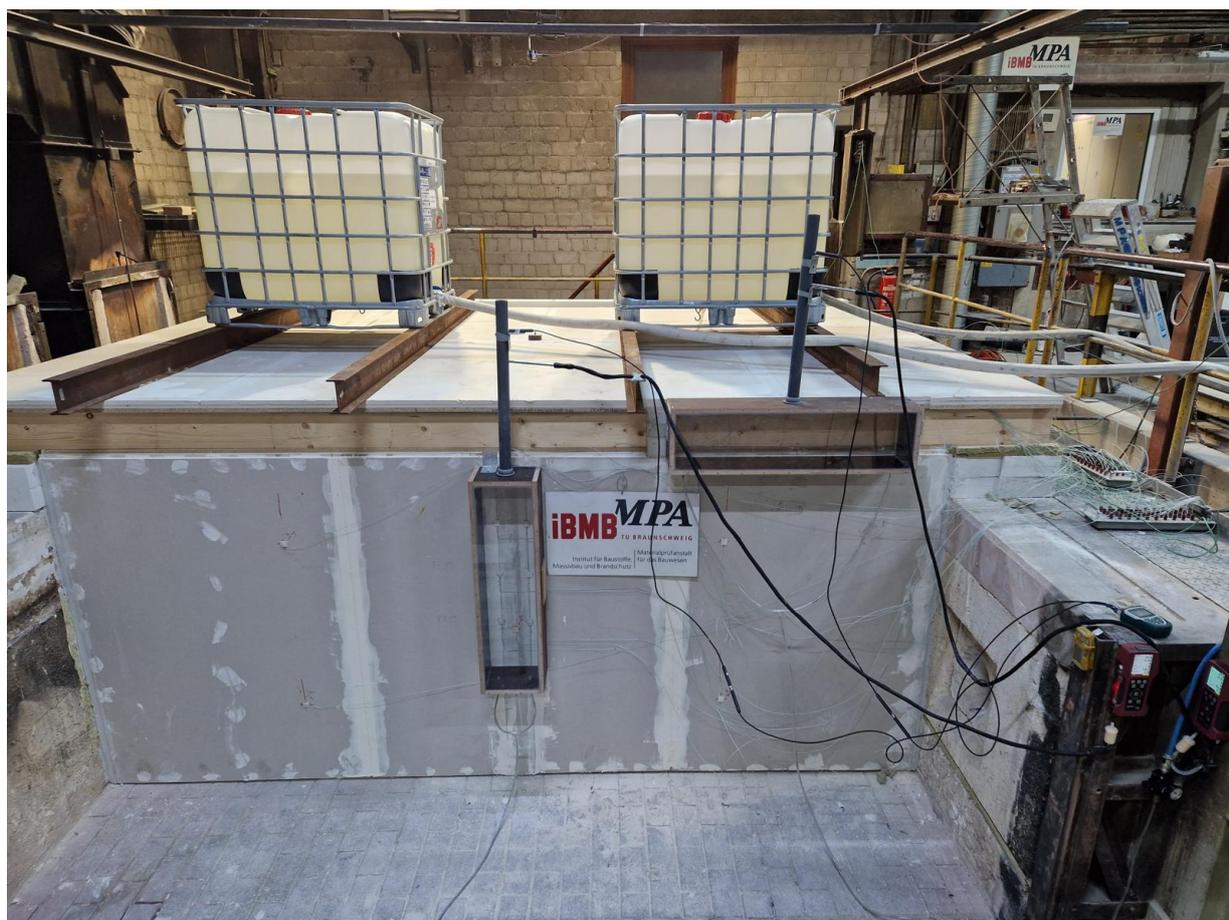
Abbildung 2.5: Ansicht Versuch 6, brandabgewandte Seite vor Versuchsbeginn (Kammer 15/16)
