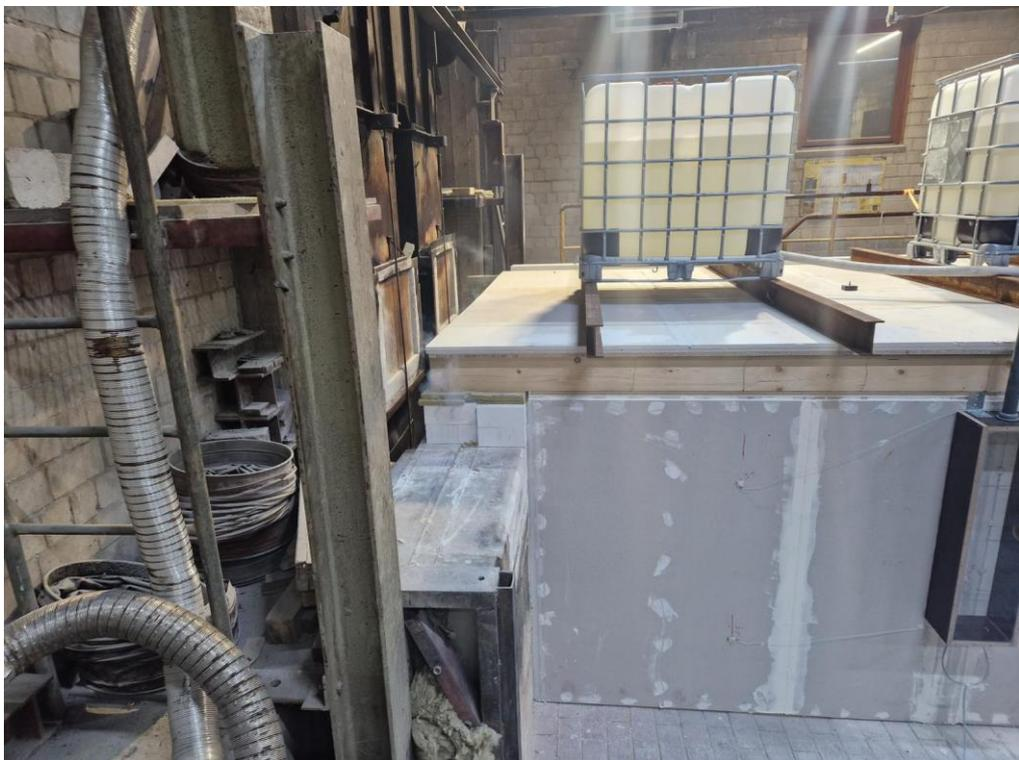
*Abb. 6.179: Rauchaustritt durch seitliche Auflagerfugen (3. Brandminute)*
