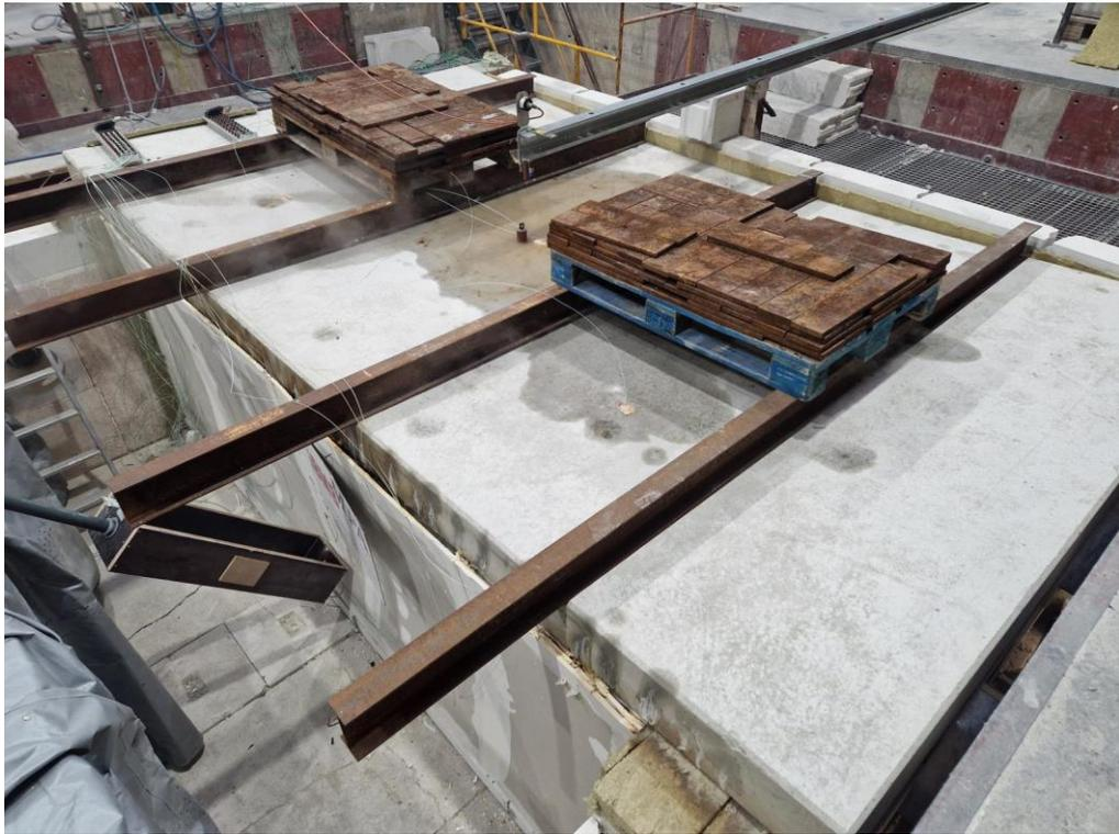
*Abb. 6.110: Probekörper brandabgewandte Seite (nach Versuchsende)*
