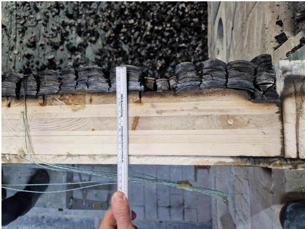
*Abb. 6.262: Auflagerfläche der Wand zur Bauteilfuge (nach Versuchsende / Löscharbeiten)*
