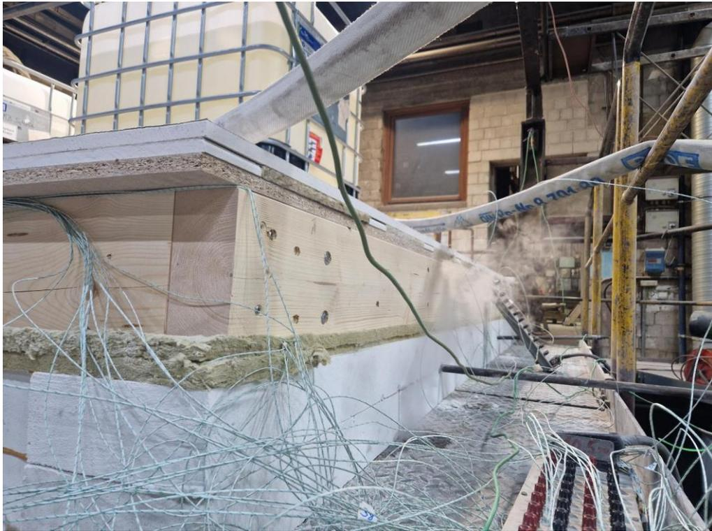
Abb. 6.180: Rauchaustritt durch seitliche Auflagerfugen (35. Brandminute)
