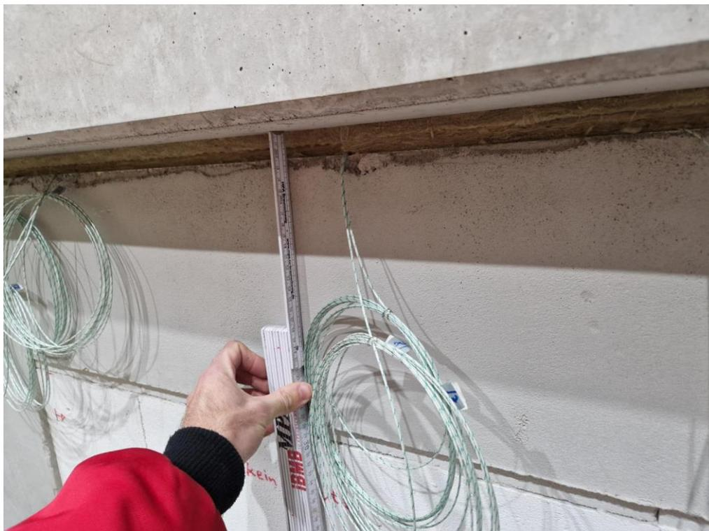
Abb. 6.140: Bauteilfuge mit Mineralwolle noch ohne Fugendichtstoff (vor Versuchsbeginn)
