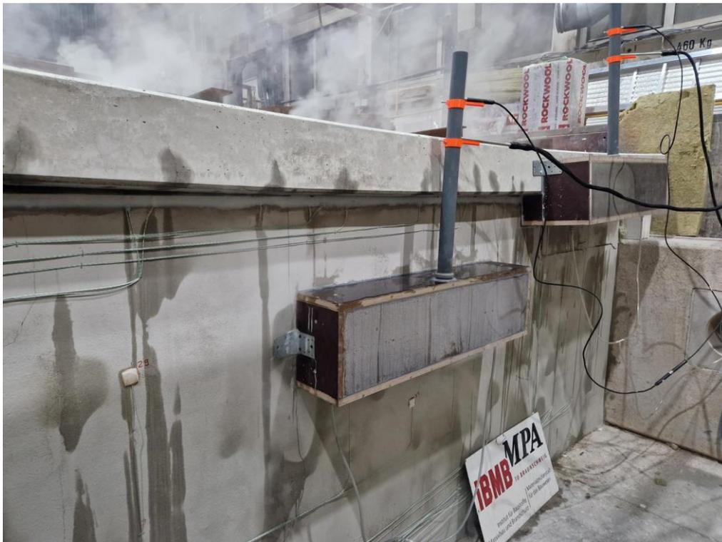
Abb. 6.146: Probekörper brandabgewandte Seite (nach Versuchsende)
