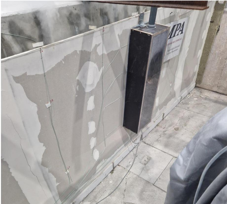
Abb. 6.108: Knick in äußerer Bekleidungslage (75. Brandminute)
