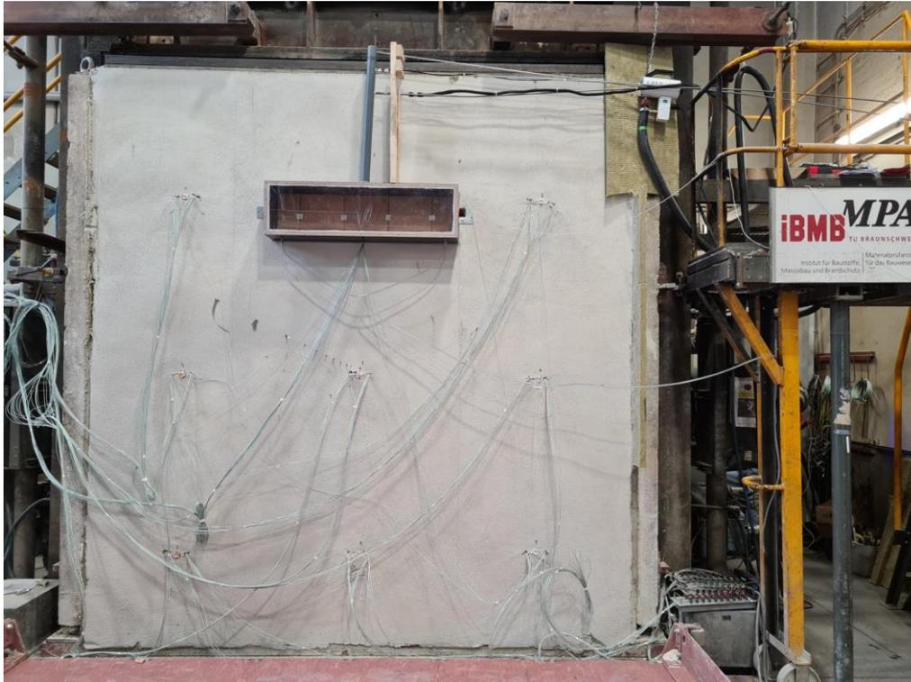
Abb. 6.32: Probekörper brandabgewandte Seite vor Versuchsbeginn
