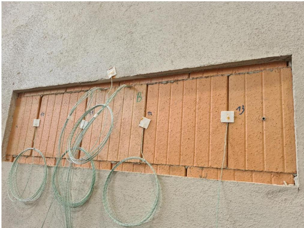
Abb. 6.15: Stoßfugen brandabgewandte Seite vor Versuchsbeginn ohne Rauchauffangkasten
