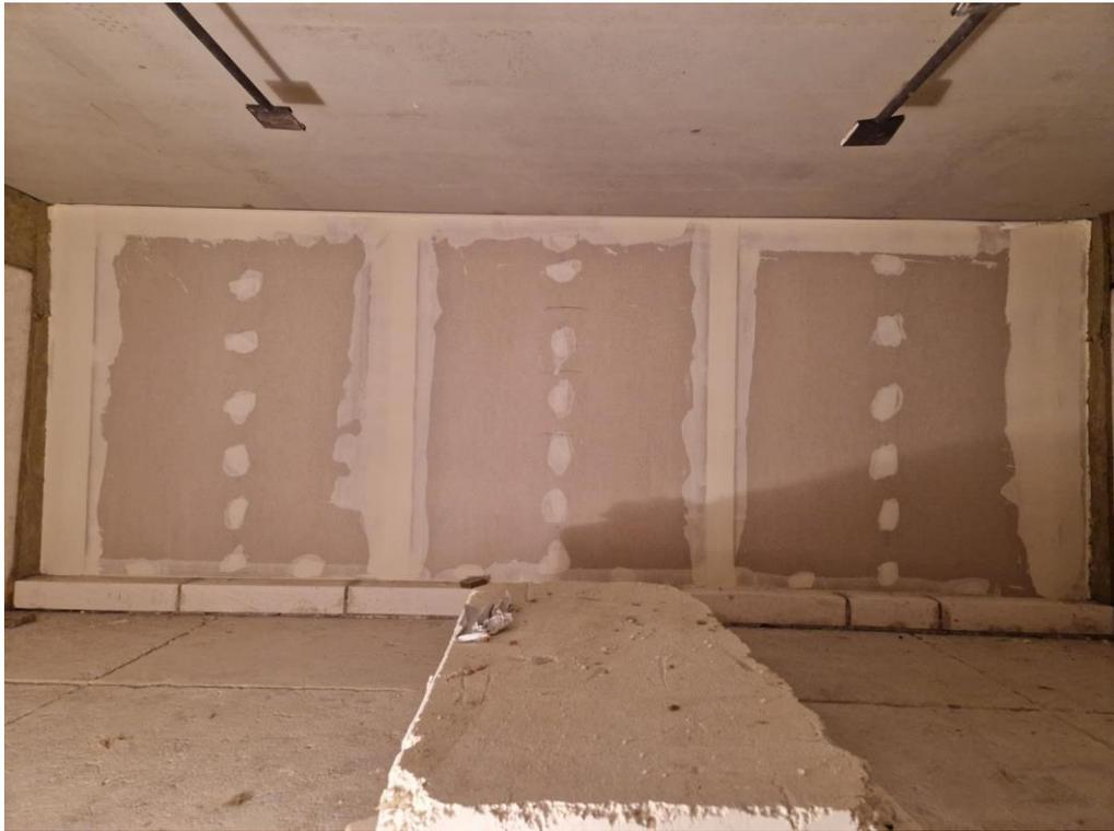
Abb. 6.103: Probekörper brandzugewandte Seite (vor Versuchsbeginn)
