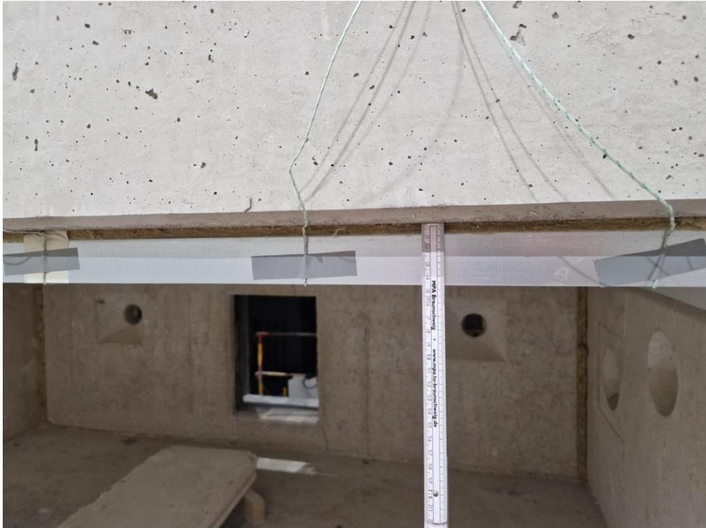
Abb. 6.63: Montage des UW-Profiles mit Mineralwolle am Deckenelement (vor Versuchsbeginn)
