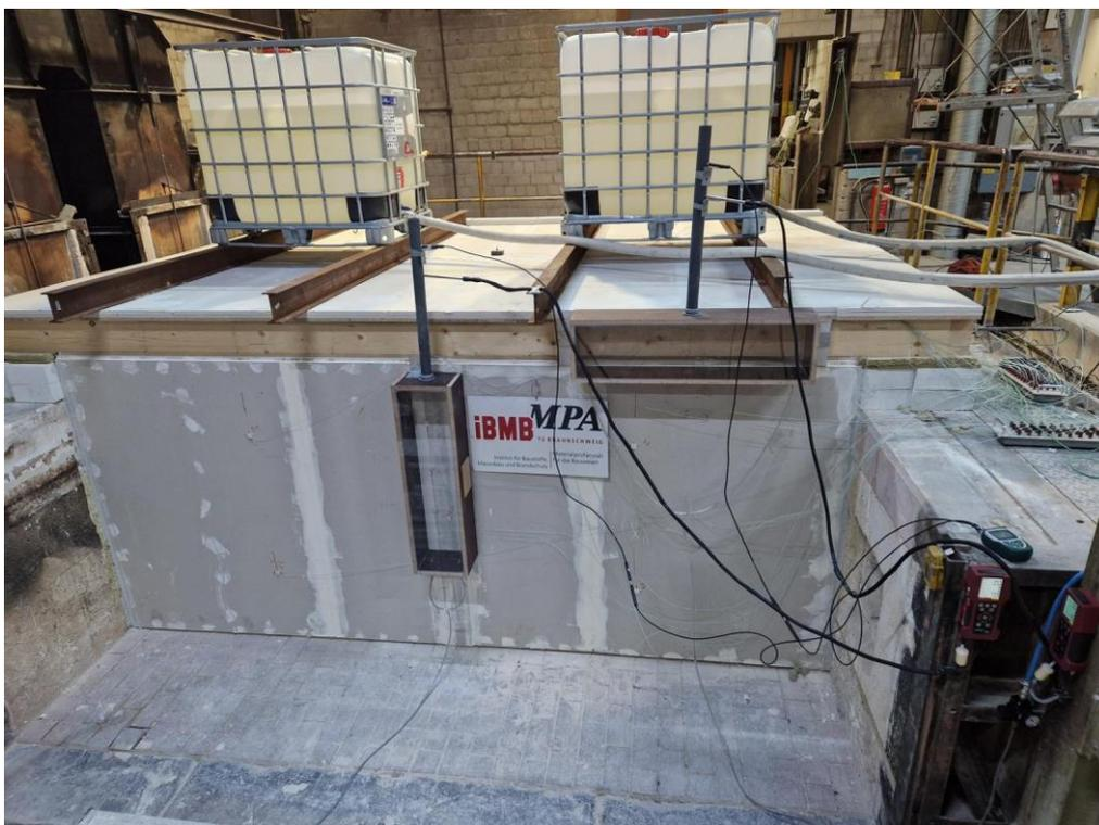
Abb. 6.177: Probekörper brandabgewandte Seite (vor Versuchsbeginn)
