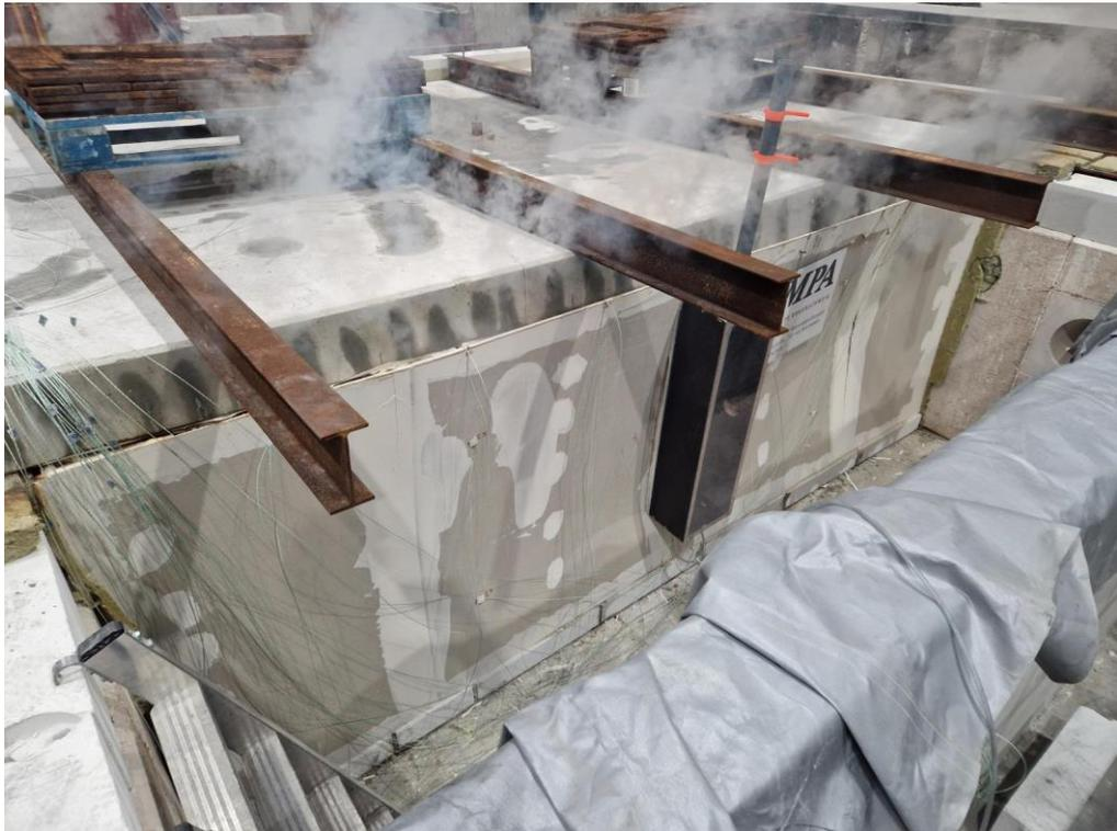
Abb. 6.71: Starker Rauchaustritt und Wandverformung (62. Brandminute)
