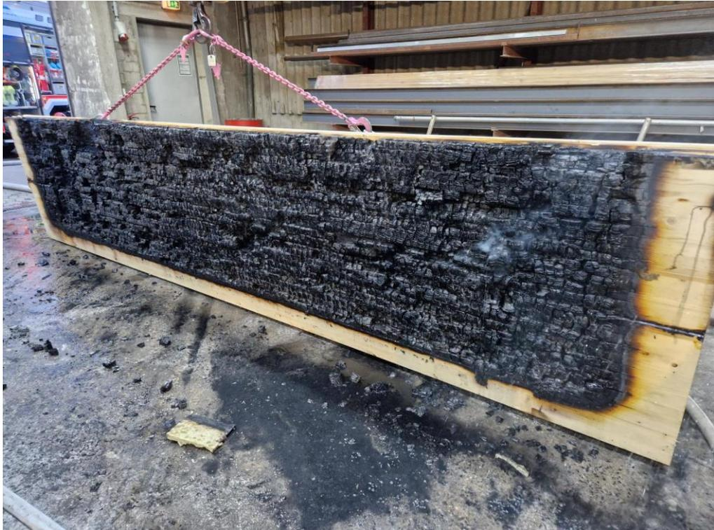
*Abb. 6.261: Unterseite Decke im Bereich der Bauteilfuge (nach Versuchsende / Löscharbeiten)*
