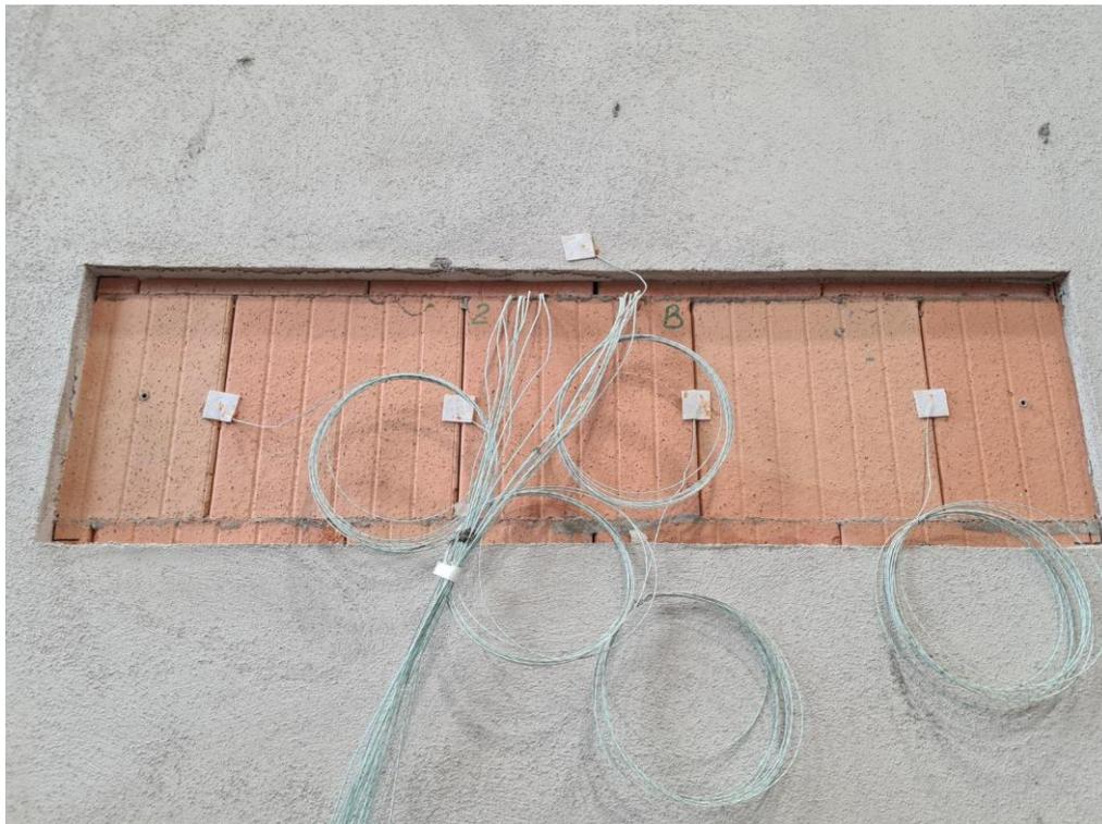
Abb. 6.34: Stoßfugen brandabgewandte Seite ohne Rauchauffangkasten (vor Versuchsbeginn)
