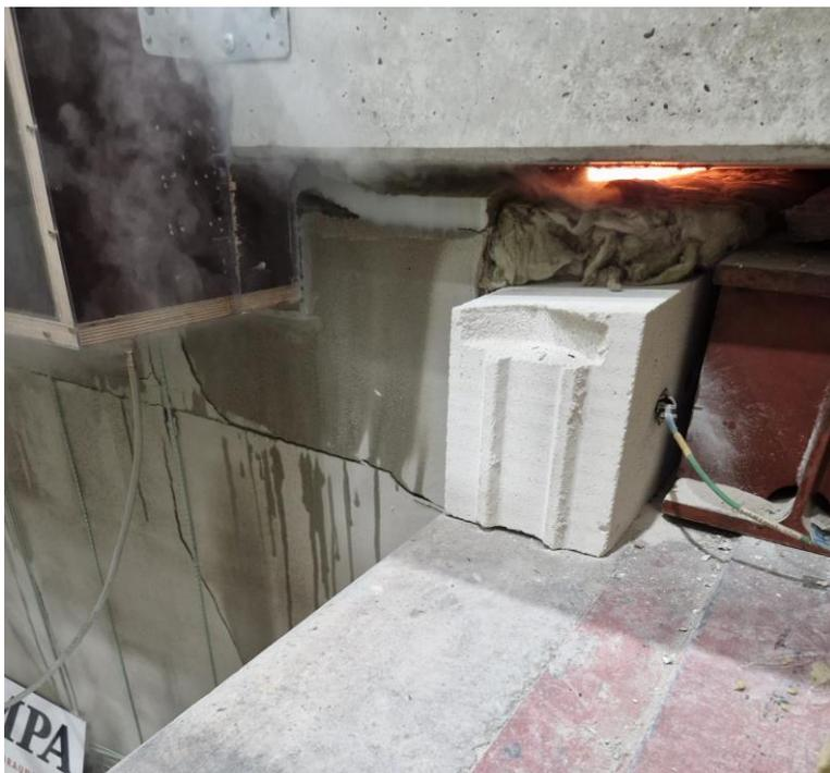
Abb. 6.144: Silikonabdichtung am RAK-Bauteilfuge reißt auf (51. Brandminute)
