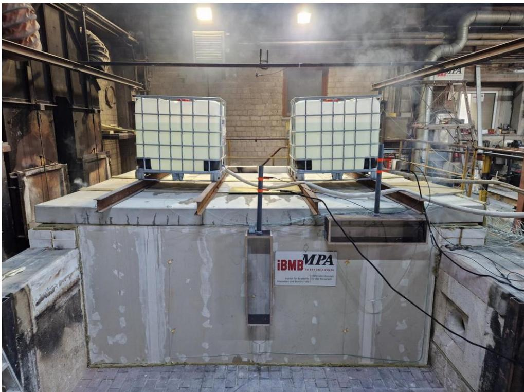
Abb. 6.217: Deckenverformung und Abreißen Silikonfuge am RAK-Bauteilfuge (27. Brandminute)
