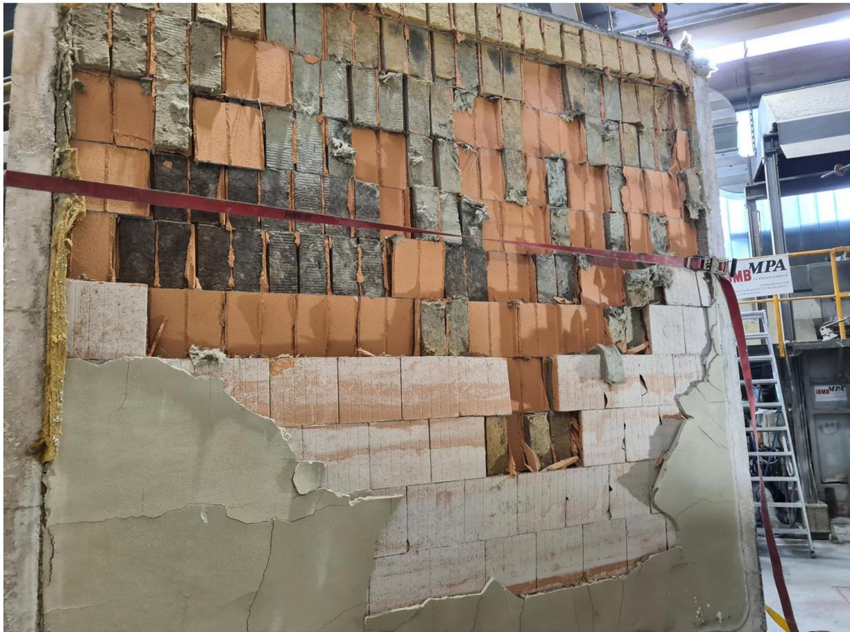
*Abb. 6.19: Probekörper brandzugewandte Seite nach Versuchsende*
