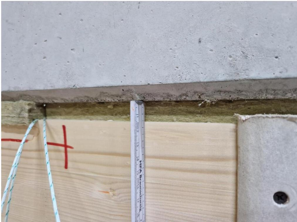
Abb. 6.214: Bauteilfuge mit komprimierter Mineralwolle (vor Versuchsbeginn)
