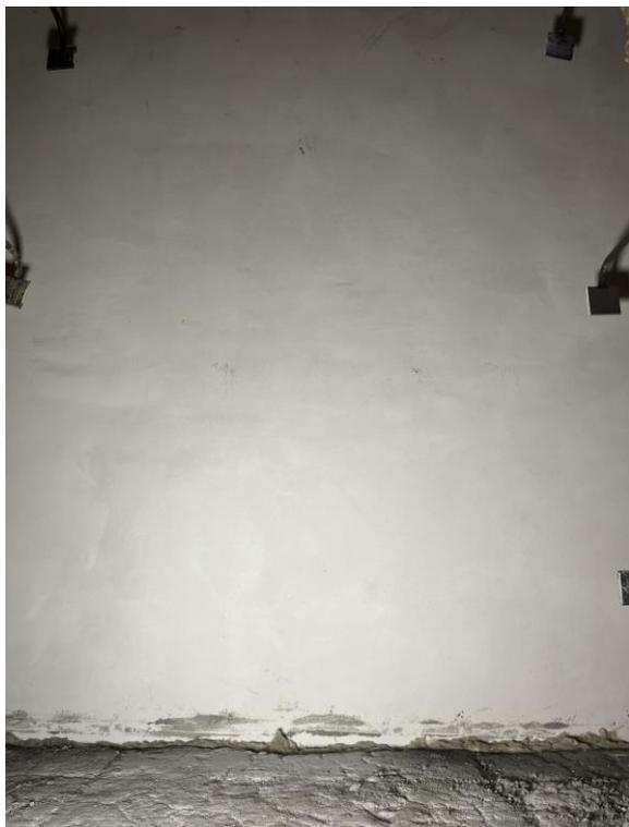
Abb. 6.14: Probekörper brandzugewandte Seite vor Versuchsbeginn
