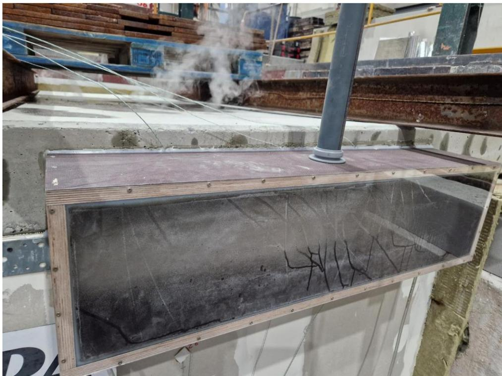
Abb. 6.105: Offene Silikonabdichtung zwischen RAK-Bauteilfuge und Decke (45. Brandminute)
