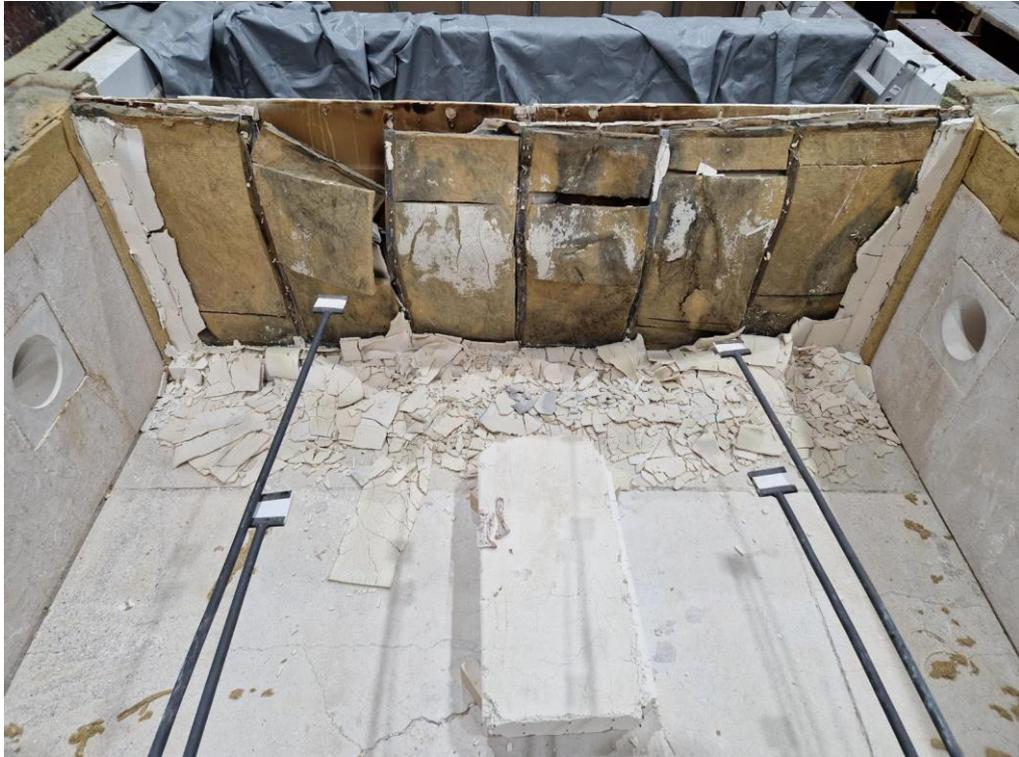
*Abb. 6.111: Probekörper brandzugewandte Seite (nach Versuchsende)*
