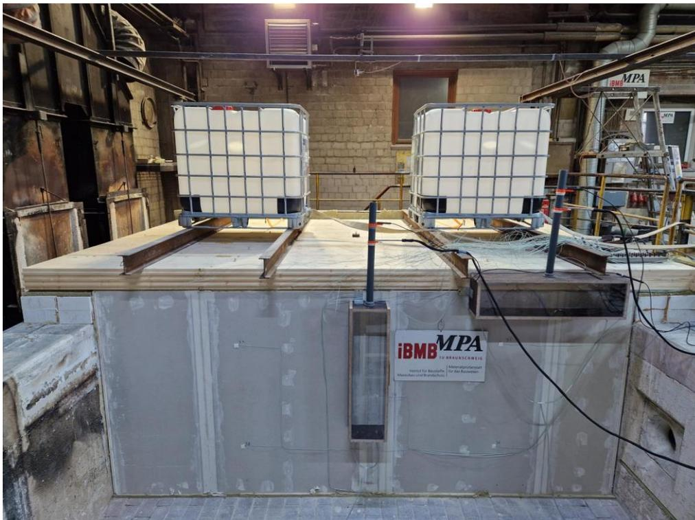
Abb. 6.253: Probekörper brandabgewandte Seite (vor Versuchsbeginn)
