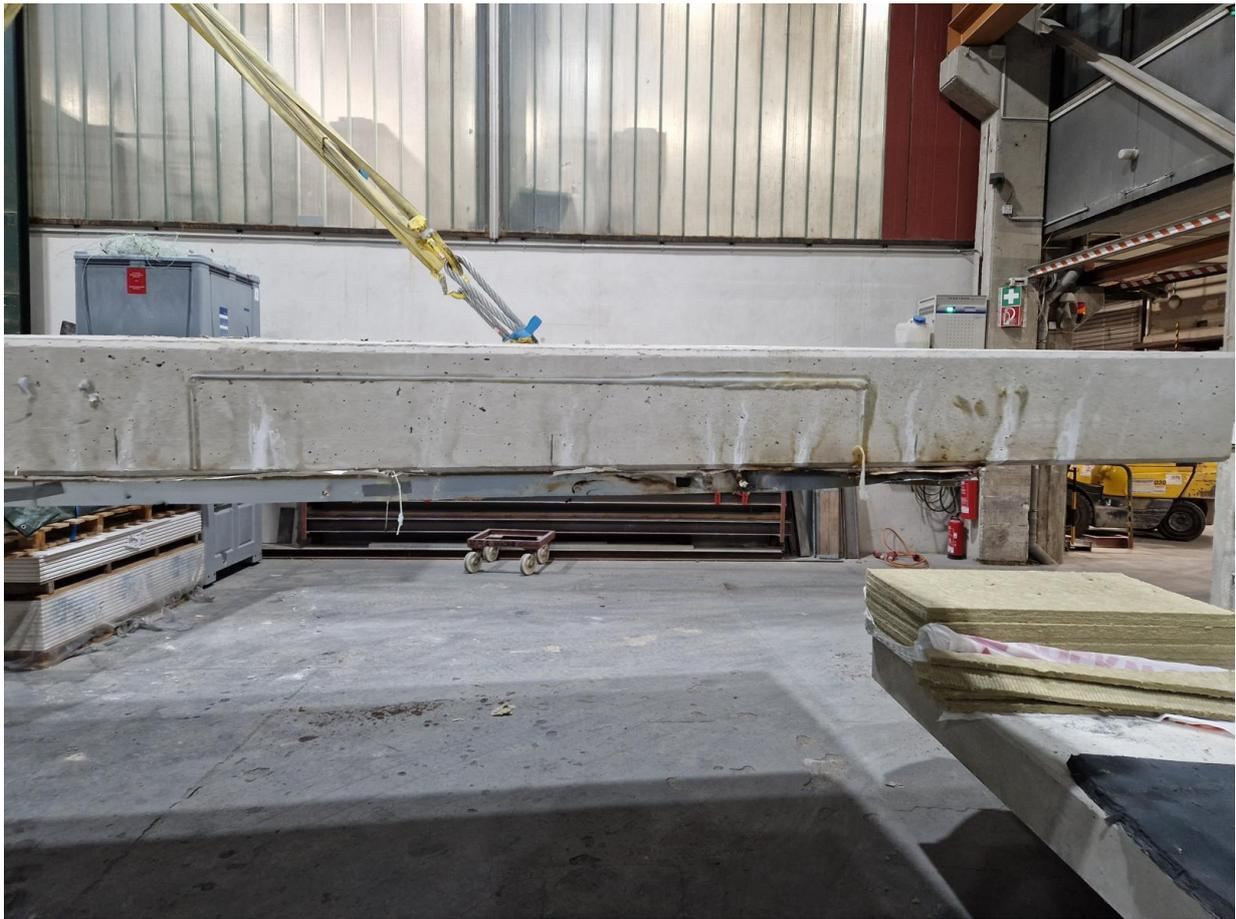
*Abb. 6.74: Verschraubtes UW-Profil mit Mineralwolle an Deckenelement (nach Versuchsende)*
