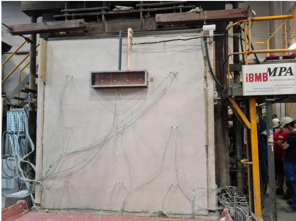
Abb. 6.13: Probekörper brandabgewandte Seite vor Versuchsbeginn
