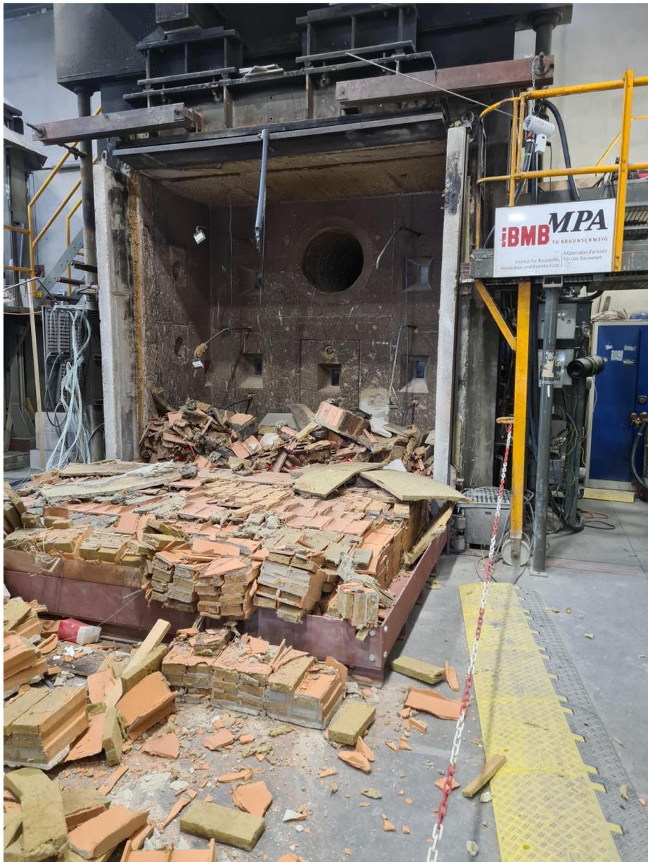
Abb. 6.36: Probekörper nach Versagen (82. Brandminute)
