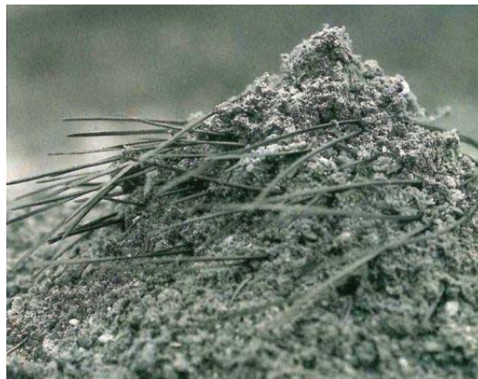
Abb. 1 Konzept der 'Terra Armée' mit Sand und Kiefernadeln nach VIDAL (1966)
