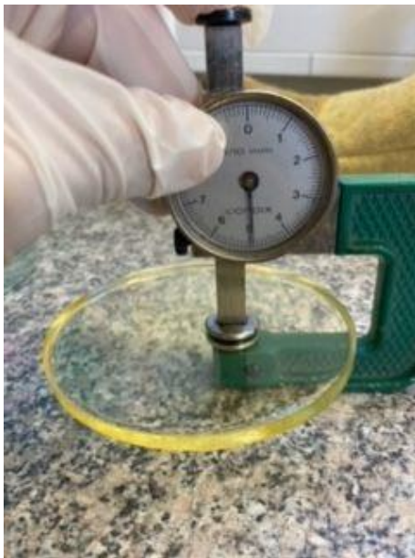
Bild 8: Vinylesterharz-Probe nach Herstellung in einer Petrischale
