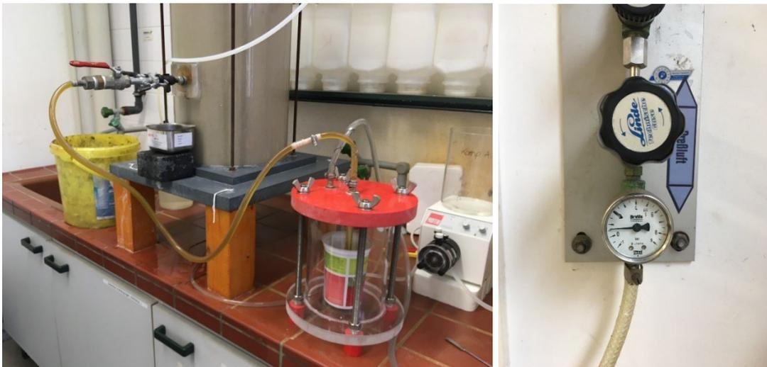
**Abbildung 3:** Säulenanlage mit Windkesselanlage (WKA) während eines Injektionsvorganges (links) und angelegter Druck (rechts)
