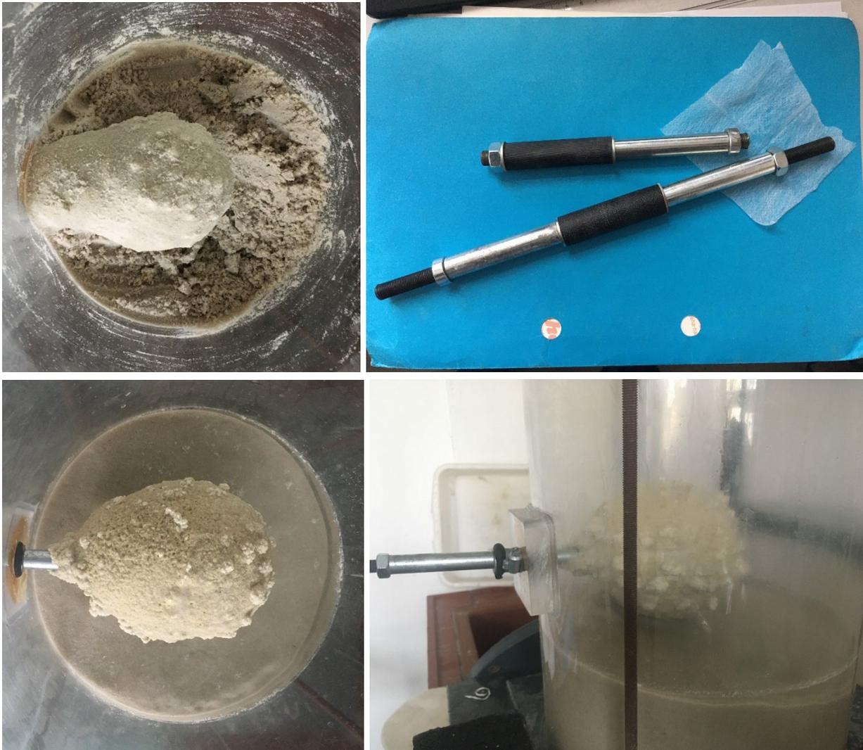
**Abbildung 4:** Prüfkörper der Vorversuche und geändertes Packersystem (kurzer vs. langer Packer)
