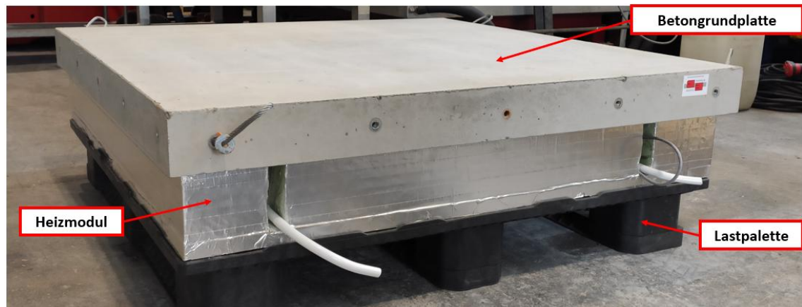
Abbildung 28 Unterer Teil der Prüfkammer: Heizmodul auf Lastpalette mit aufgesetzter Betongrundplatte
