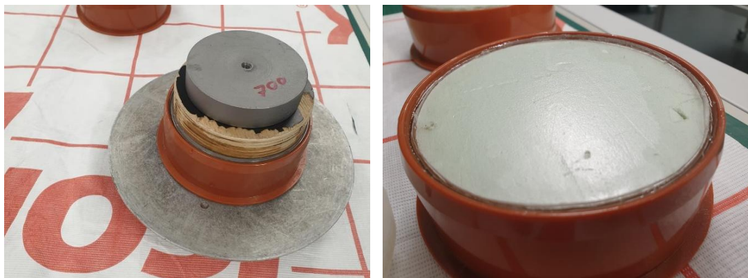
Abbildung 11 Links: Eingießen der Probe mit Epoxidharz; Rechts: fertige Probe mit vergossenem Rand
