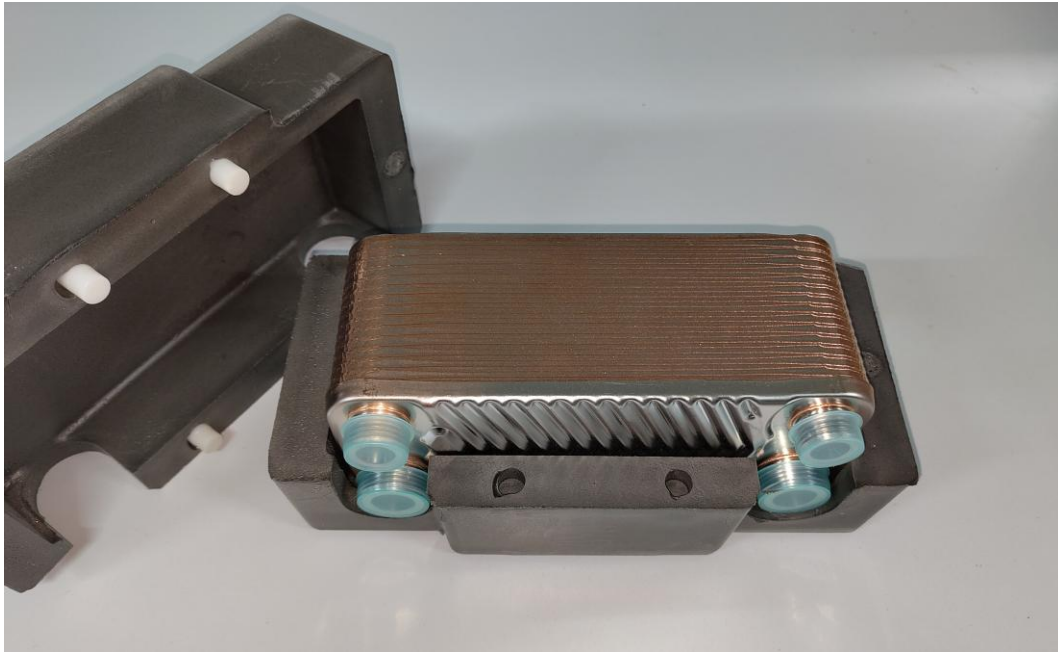
Abbildung 50 Neuer Plattenwärmetauscher mit erhöhter Wärmeübertragungsleistung und Dämmschale zur Reduzierung der Wärmeverluste
