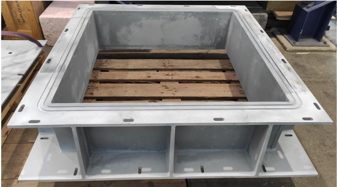
Abbildung 25 Gefertigter Prüfkammerrahmen als Schweißkonstruktion aus verzinktem Stahl
