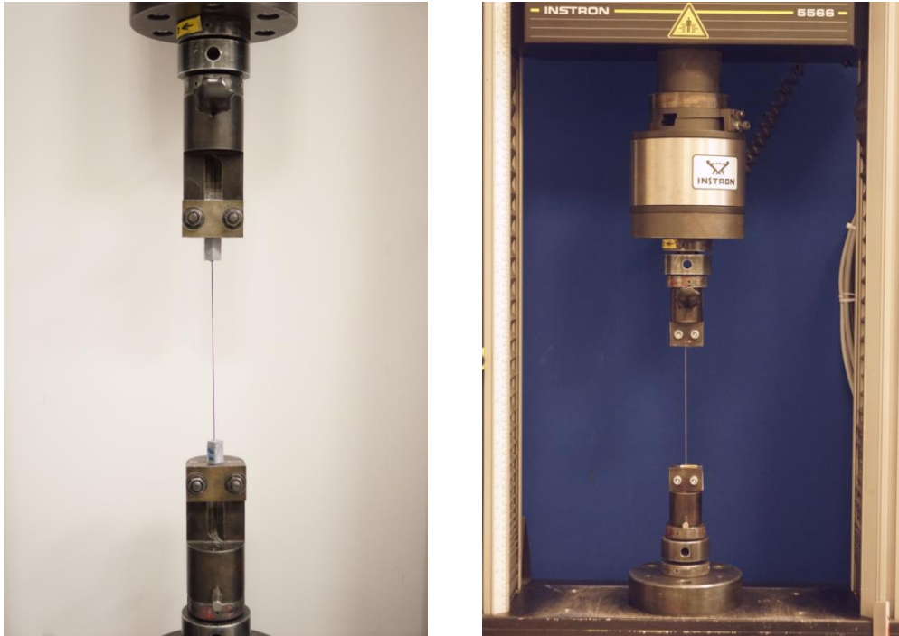
Bild 7: Prüfaufbau zur Prüfung der Restzugfestigkeit der Basaltfasern (links) sowie PA-Fasern (rechts)
