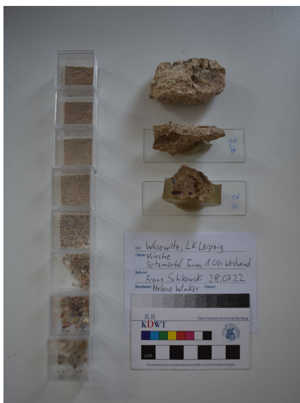
Abb. 5 Kornfraktionen (links) und Putz- proben (rechts) – Wasewitz, evangelische Kirche, 2022
