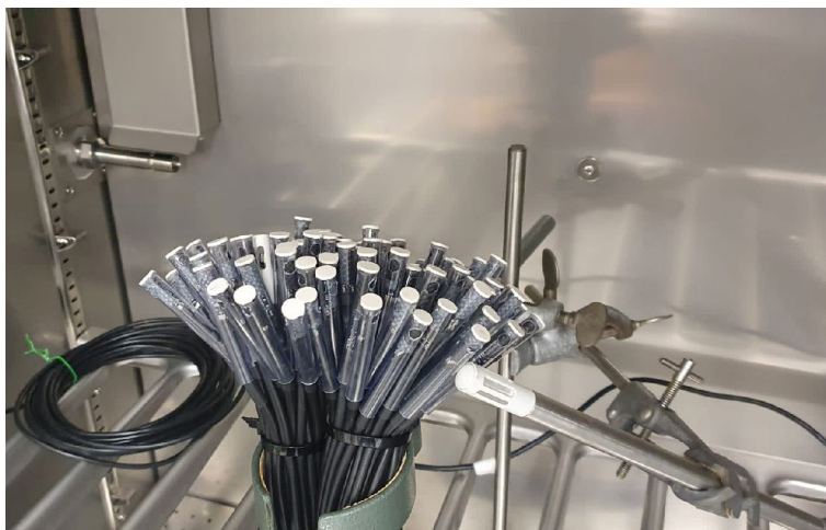
Abb. 9 Überprüfung der Sensoren mit Schutzkappe im Klimaschrank (Torsten Toepel, BTU Cottbus-Senftenberg)
