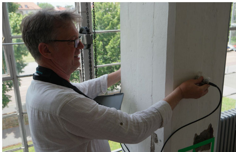
Abb. 8 Ultraschallmessung an einer Massivstütze des Werkstattflügels
