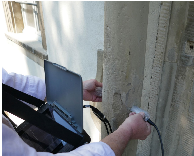
Abb. 5 Durchschallung der Säulenschäfte
