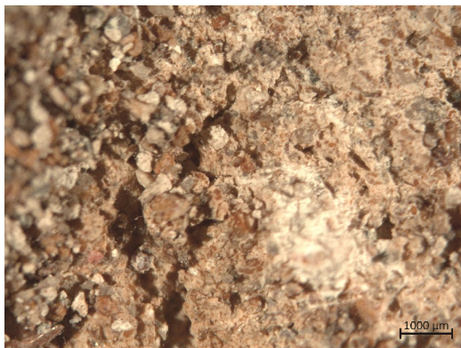
Abb. 4 Mikroskopische Ansicht des Mauer- und Fugenmörtels im Gewölbe, datiert auf die erste Hälfte des 16. Jahrhunderts
