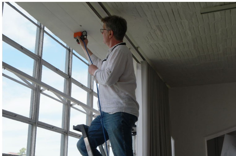
Abb. 7 Radarmessung an den Massivdecken des Werkstattflügels
