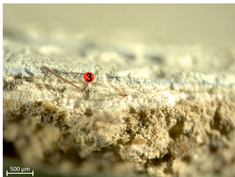
Abb. 15 Fassungspaket der Seitenwände unter der Lichtnische mit deutlich weniger Schichten (ca. 5 Schichten). Hier liegt das Hellblau (Schicht 3) auf Ausbesserungsmörtel mit Haarmarmierung.
