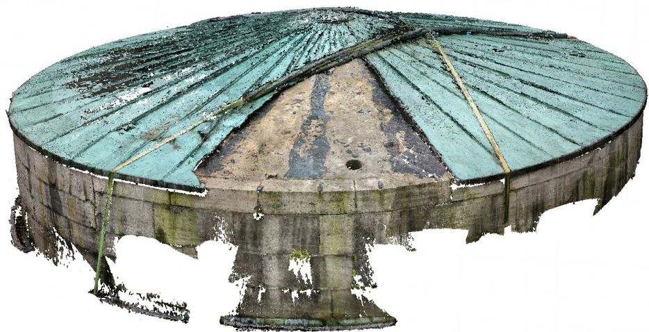
Abb. 7 Dreidimensionale Aufnahme des Bestandes mittels Laserscanning und 3D-Fotogrammetrie
