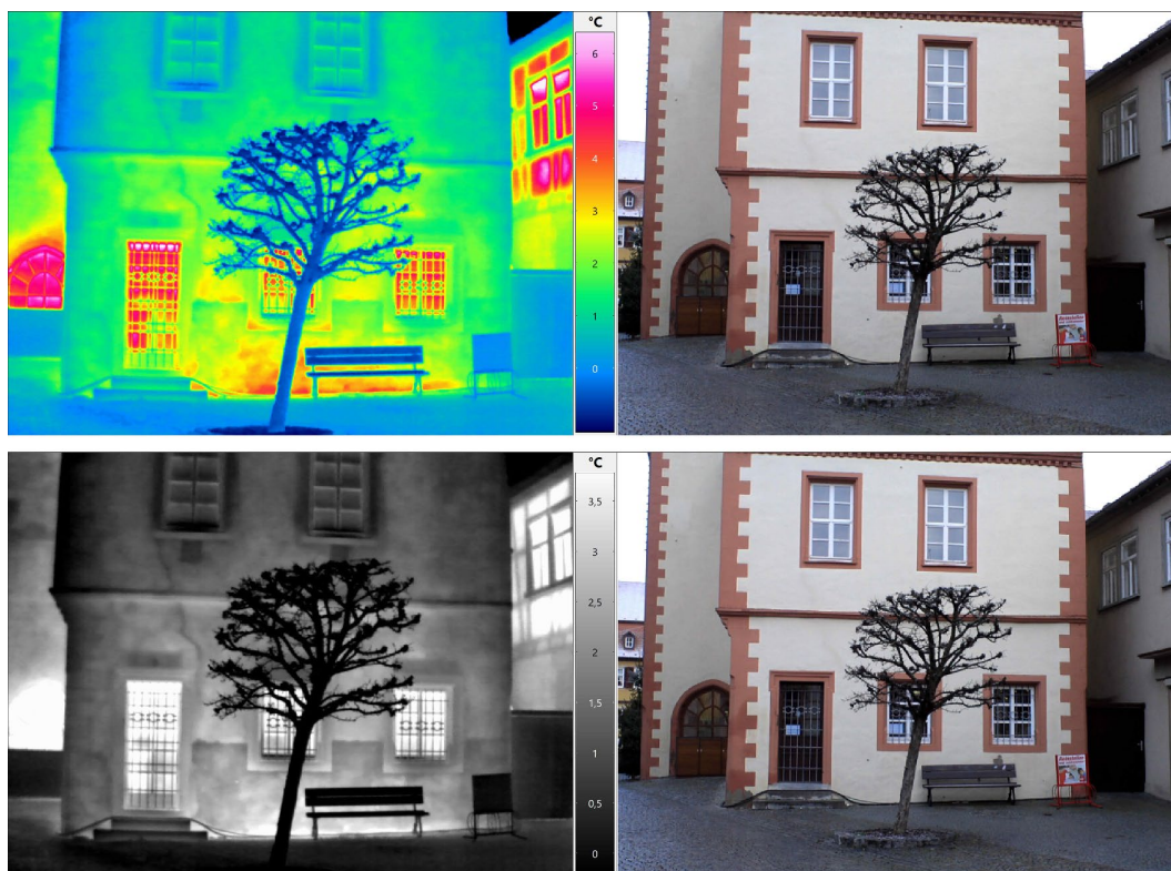
Abb. 13 RT-Untersuchung des Rathauses in Gerolzhofen – Detektion von Sockelsanierung
