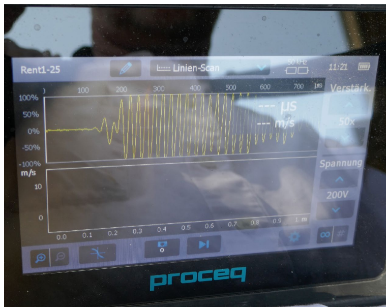
Abb. 6 Erfassung der Laufzeit des Kompressions- wellenimpulses
