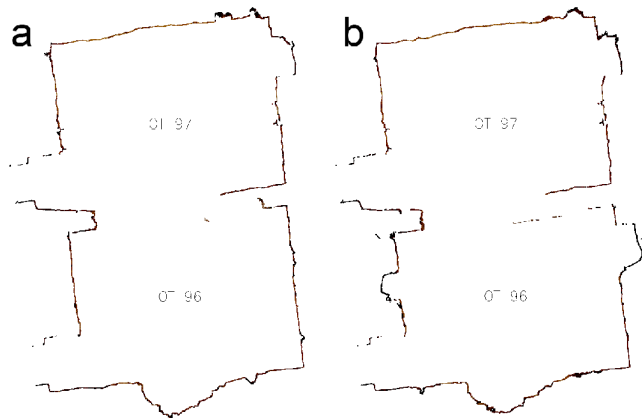
Abb. 5 Ägypten, Kloster Dayr Anba Hadra, Wohnbau der Mönche: horizontale slices durch die 3D-Punktwolke im Abstand von 5 cm
