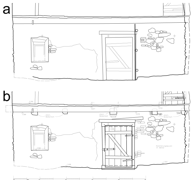
Abb. 14 Neustadt a. d. Waldnaab, Marktplatz 22: a) Querschnitt durch das Untergeschoss nach Auswertung einer 3D-Punktwolke; b) wie a), jedoch nach bauforscherischer Überarbeitung vor Ort (Anna Kofer; Arnold Kreisel)
