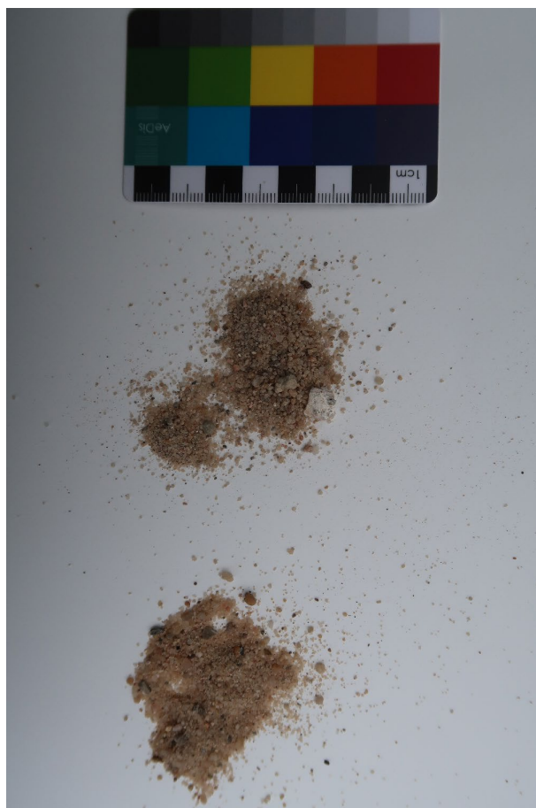
Abb. 4 Zuschlag des Bestandsputzes nach Auflösung des Kalkbindemittels (oben) und Sandmuster für Neuputz (unten) – Schwäbisch Hall, OT Steinbach, St. Johannes Baptist, 2023 (AeDis AG)
