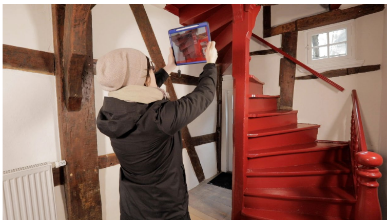
Abb. 5 Erfassen einer Treppe mit der 3D-Scan-App (Objekt: Fachwerkhaus am Entenmarkt, Bad Münstereifel) (Silvia Wolf, Pulheim)
