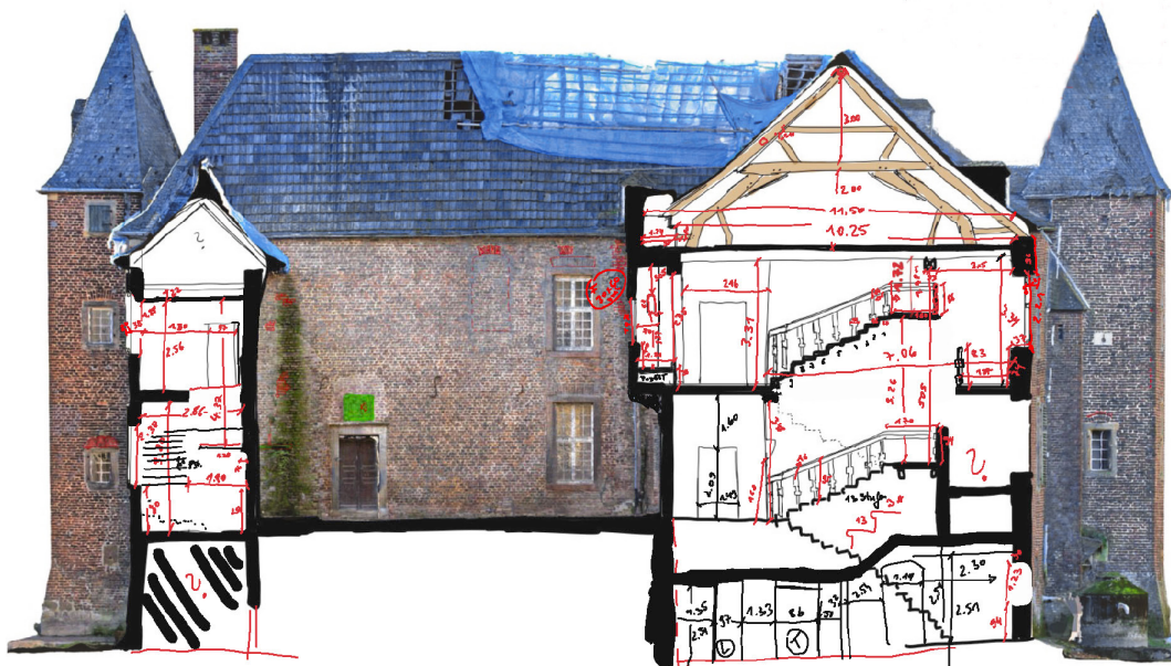
Abb. 3 Maßstäblicher Gebäudeschnitt (2D-Bildplan) mit Kartierungen, die auf dem Tablet mittels digitalem Stift ergänzt wurden (Objekt: Haus Rath, Düren-Arnoldsweiler) (Bildplan aus dem 3D-Modell: Hans Meyer, Pulheim)
