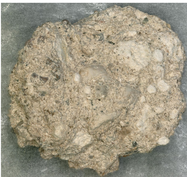
Abb. 7 Putzprobe mit Kalkspatzen, Mikroskopaufnahme mit Keyence- Digitalmikroskop (Panoramafunktion), 2022
