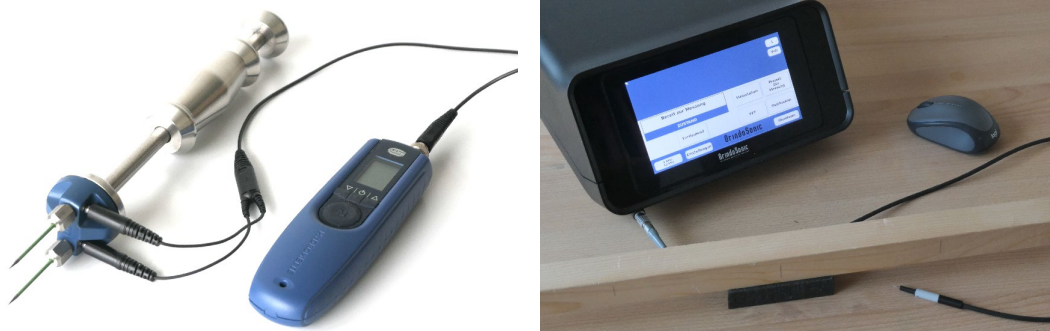
Abb. 6 Gann Hydromette BL H 40 (links) und GrindoSonic MK7 (rechts)
