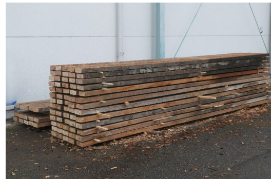
Abb. 3 Sparrenabschnitte des Wohnriegels für Validierung (links) und Sparren für Erprobung (rechts)
