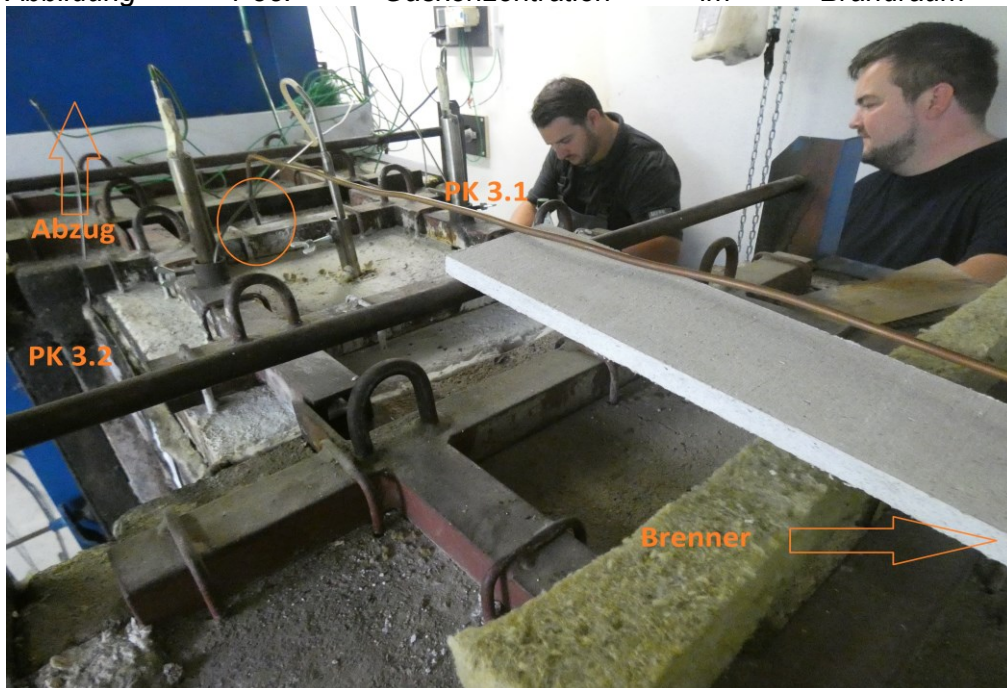
Abbildung 4-38: Gaskonzentration im Brandraum während V3
