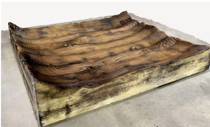
Abbildung 3-18: Ergebnis eines 3D-Scans mittels LIDAR und der App Polycam
