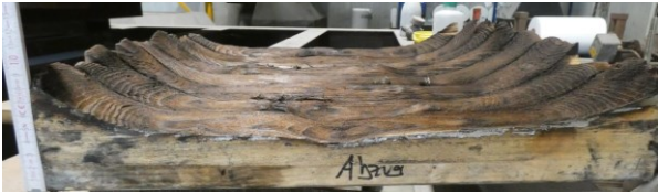
Abbildung 3-8: Mit Spachtel und Drahtbürste bis zur Abbrandgrenze entfernte Holzkohle.
