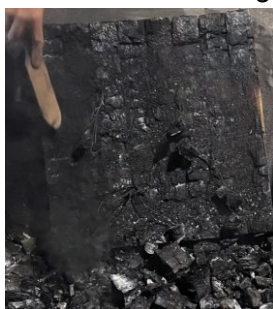
Abbildung 3-5: Händisches Entfernen der Holzkohle nach dem Brandversuch mittels einer Drahtbürste.
