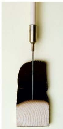
Abbildung 3-11: Messung der Abbrandtiefe mit einer Keramiklanze [33]
