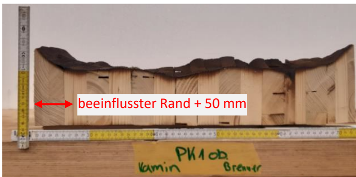
Abbildung 5-2: Randbereiche am Beispiel eines Probekörpers aus der Versuchsreihe von Ross [42]
