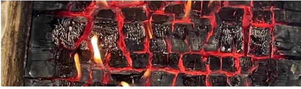
Abbildung 3-6: Brennende Holzoberfläche nach dem Brandversuch.
