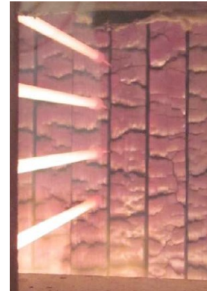
Abbildung 3-12: Keramiklanzen und Probekörper im Brandprüfstand [Quelle Holzforschung München]
