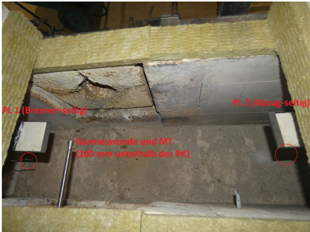
Abbildung 4-45: Anordnung der PL und MT während V7 (rote Markierungen: MT neben PL 1 und 2)
