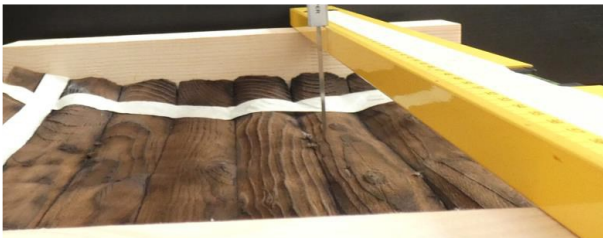
Abbildung 3-9: Messung der Abbrandtiefe und daraus resultierend des Restquerschnittes an einem Punkt nach dem Ende des Versuchs mit einer Schublehre [46].
