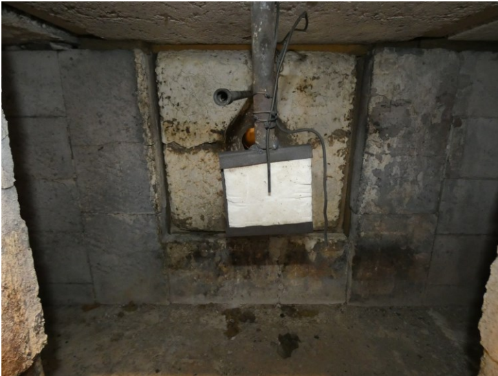
Abbildung 4-44: Anordnung der TE (vor, neben und hinter PL) im Brandraum (Stahlrohr neben PL: Gasmesssonde des Testo 350; MT hinter PL nicht sichtbar)
