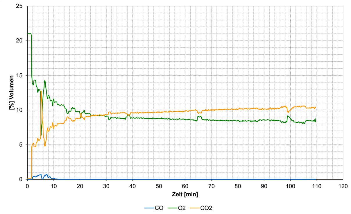
Abbildung 4-38: Gaskonzentration im Brandraum während V3
