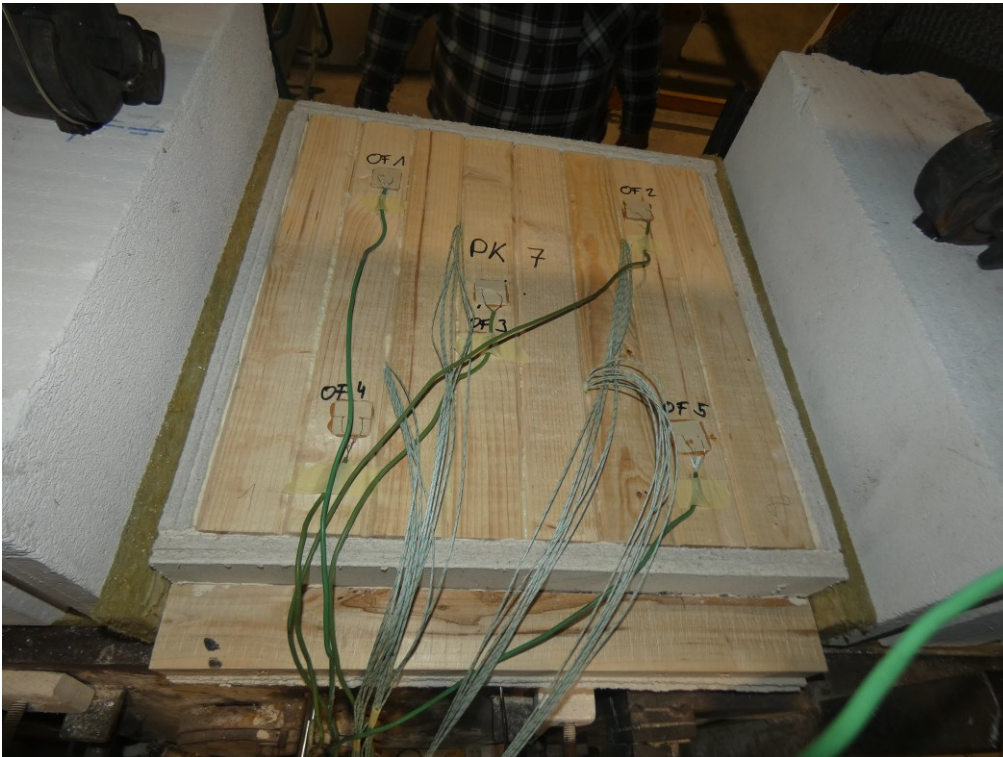
Abbildung 4-54: Horizontaler Einbau von PK 7 (Brenner auf der linken, Abzug auf der rechten Seite)
