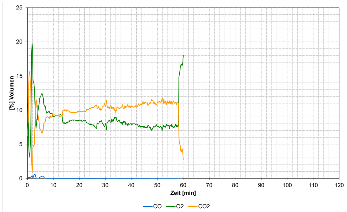
Abbildung 4-43: Gaskonzentration im Brandraum während V4 Allgemeines zu den Versuchen an der MPA Stuttgart
