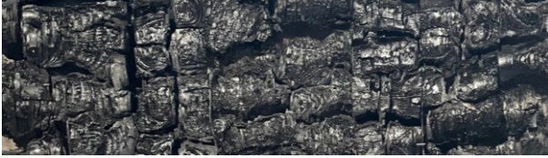
Abbildung 3-7: mit Wasser abgelöschter Probekörper nach dem Brandversuche – Oberfläche der Holzkohle.
