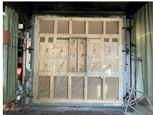
Abbildung 3-2: 3 x 3 m Wandprüfstand der HFM
