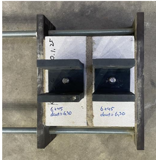
Abbildung 5-3:Steinpaket-Probekörper KS 3DF
