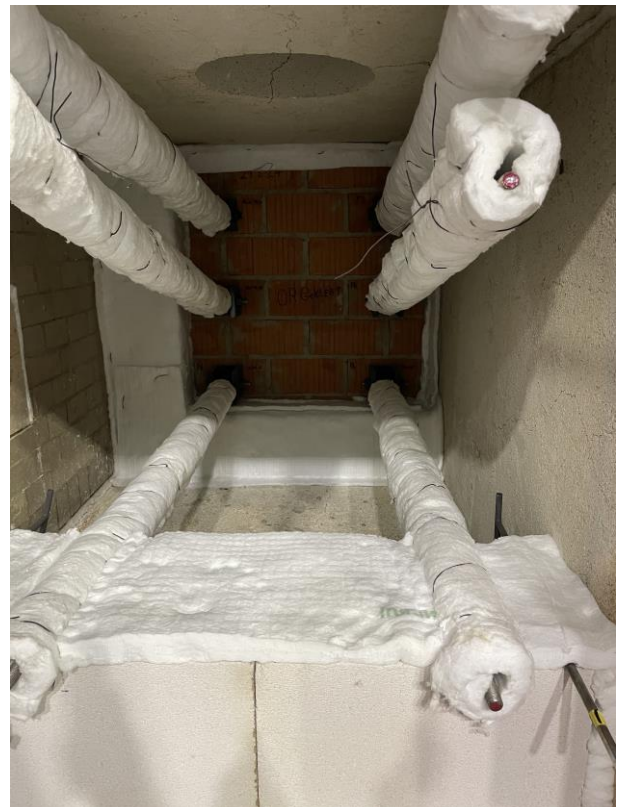
Abbildung 5-8: Eingebauter Wandprobekörper mit installierten und isolierten Zugstangen
