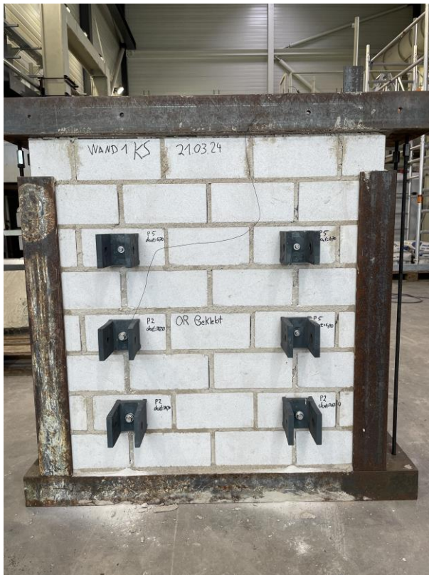
Abbildung 5-7: Wandprobekörper mit installierten Befestigungsmitteln
