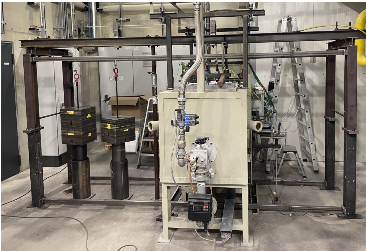
Abbildung 5-6: Konstruktion zur Lastaufbringung mittels Umlenkrollen und Todlasten
