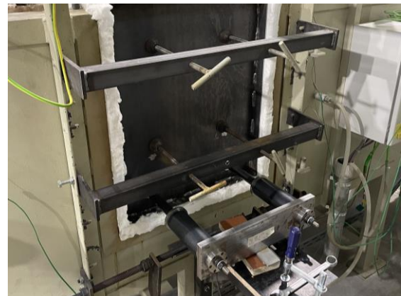
Abbildung 5-5: Seitliche Ofenabdichtung und Konstruktion zur Lastaufbringung
