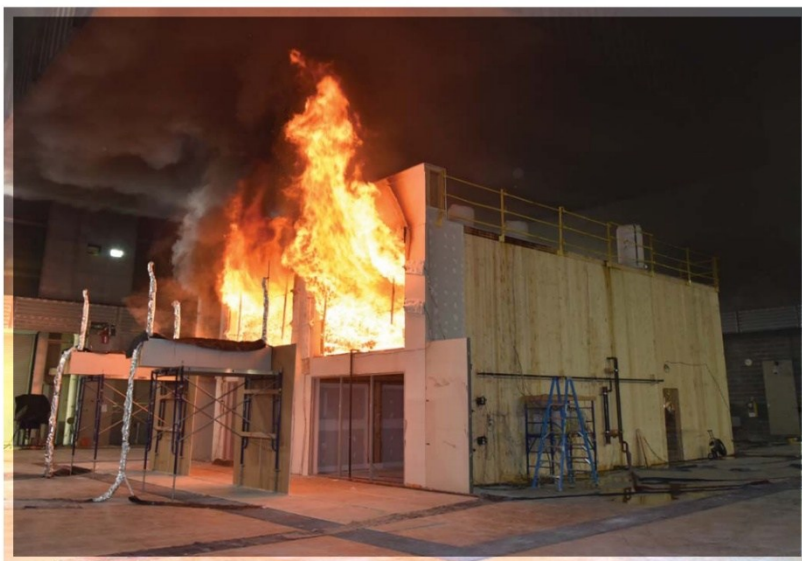
Bild 7 Realbrandversuchsserie von Zelinka [11] zur Untersuchung des Einflusses ungeschützter Holzoberflächen
