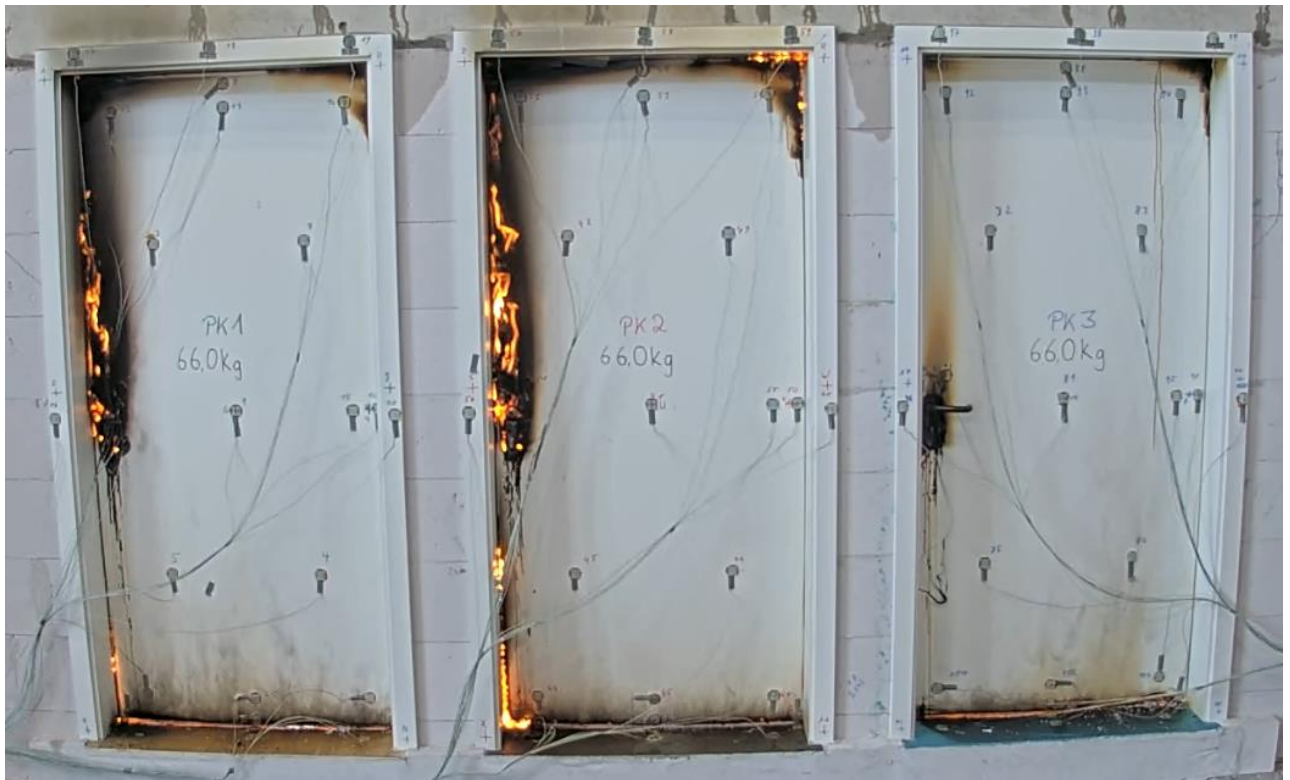
Abbildung 56: V 3 - Prüfelemente nach dem Brandversuch (unbeflammte Seite)
