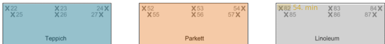
Abbildung 14: V 1 - Temperaturerhöhungen auf den Bodenbelägen (informell)
