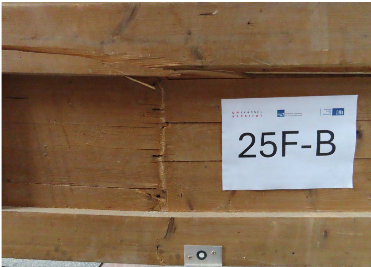
Abbildung A.172: 25F-B Trägerseite a Gurtlammellenversagen
