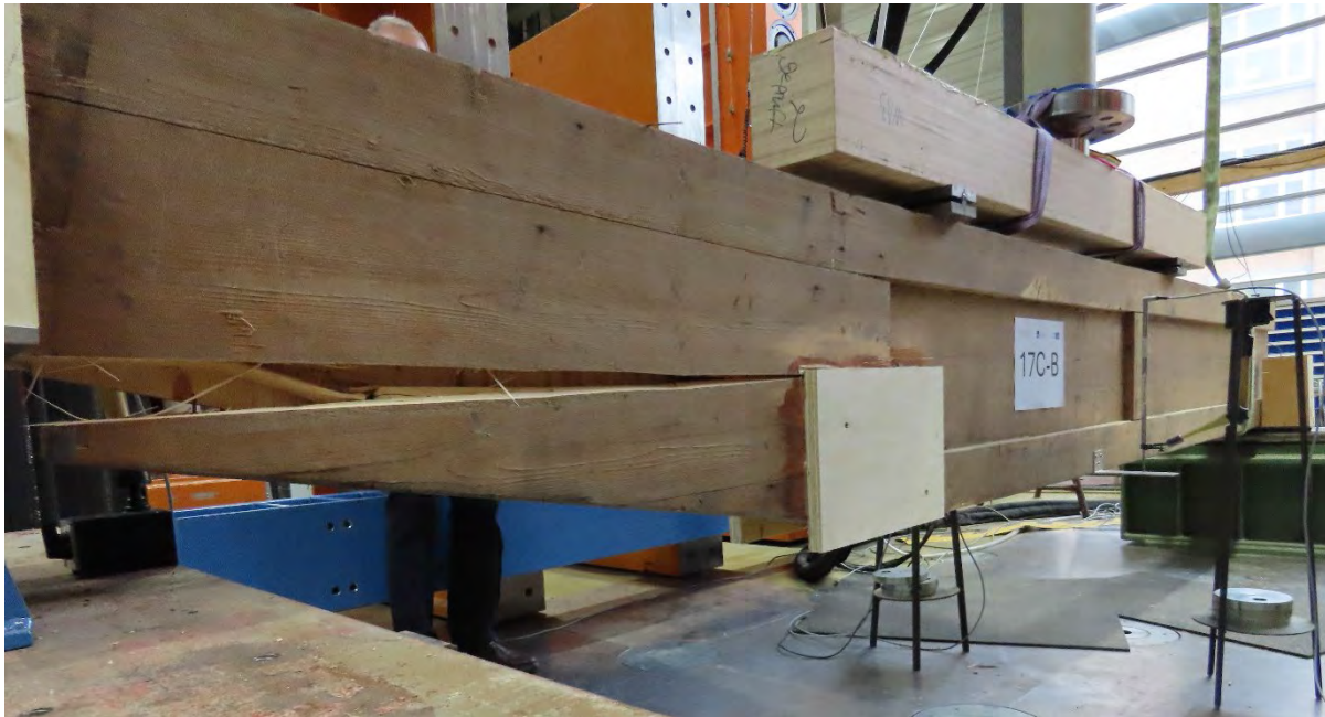
Abbildung A.162: 17C-B Schubversagen Trägerseite a
