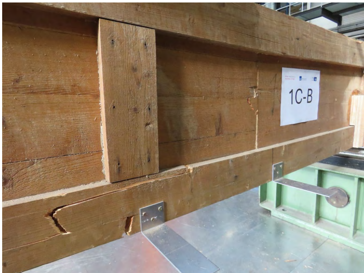
Abbildung A.191: 1C-B Keilzinkung Trägerseite a Biegezugversagen
