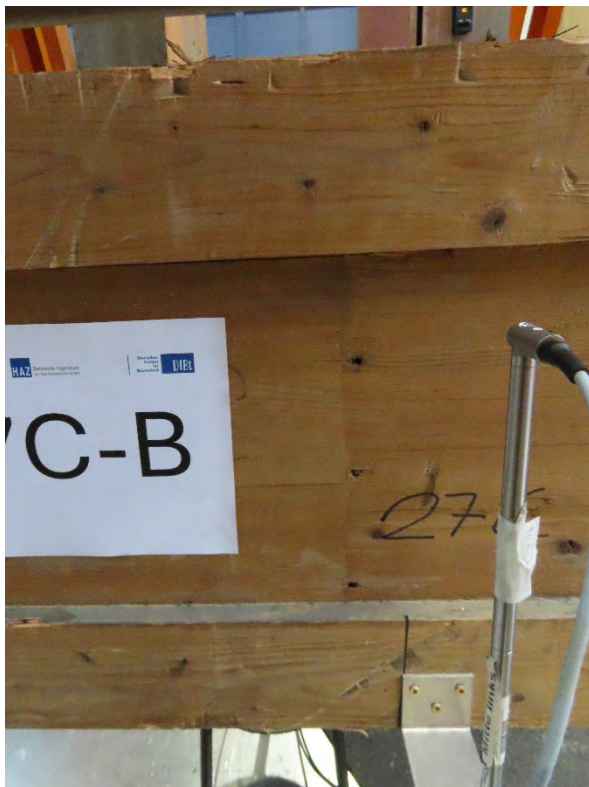
Abbildung A.178: 27C-B Keilzinkung Trägerseite a vor der Prüfung
