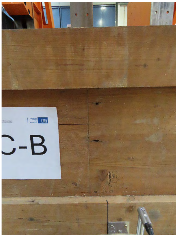
Abbildung A.199: 16C-B Keilzinkung Trägerseite a vor der Prüfung
