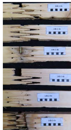
Abbildung A.28: 14B-Z-b nach der Prüfung
