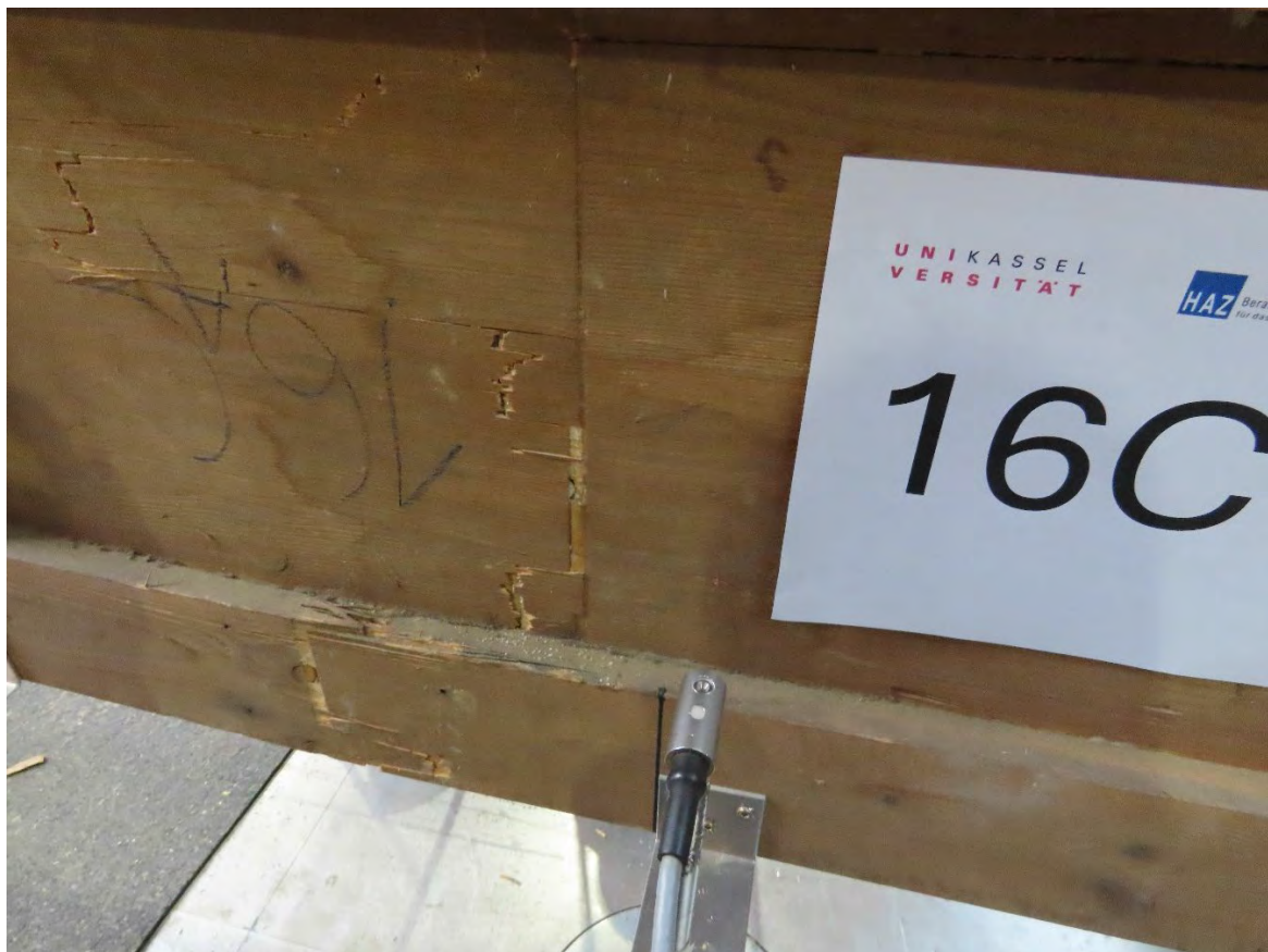
Abbildung A.202: 16C-B Keilzinkung Trägerseite b Biegezugversagen
