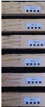
Abbildung A.25: 14B-Z-a vor der Prüfung
