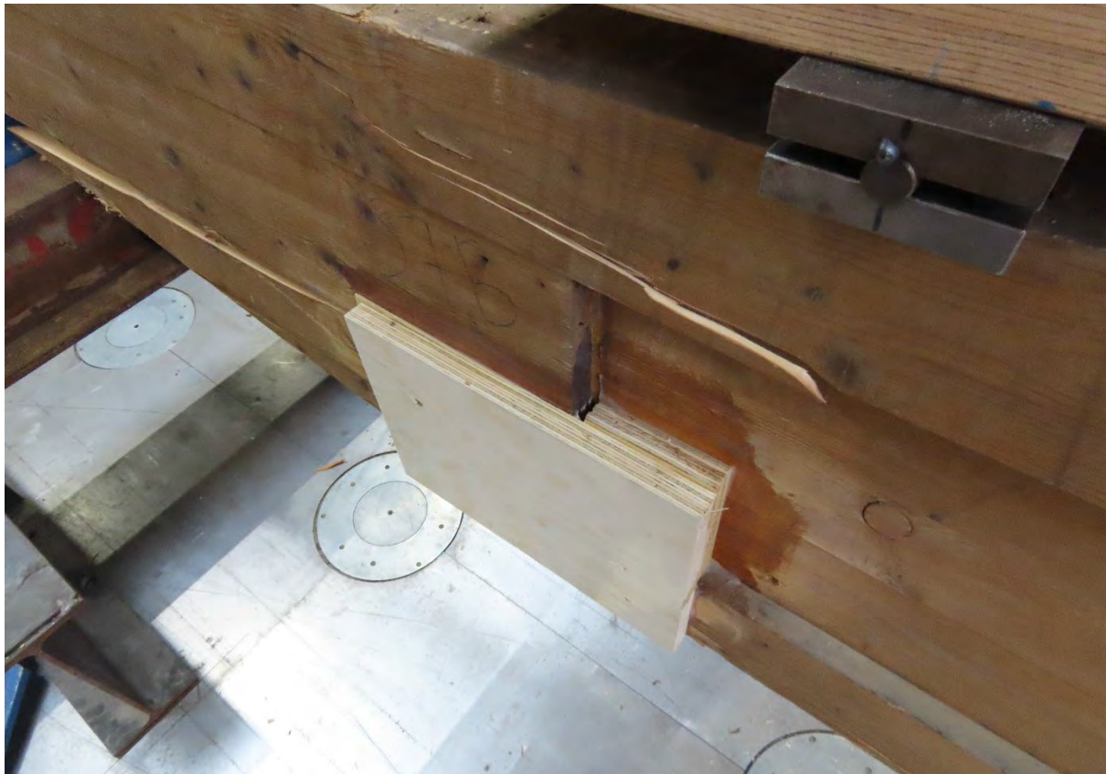
Abbildung A.181: 27C-B Schubversagen Trägerseite b
