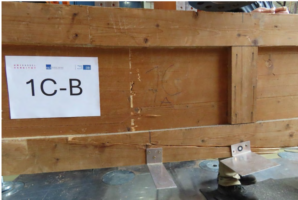
Abbildung A.190: 1C-B Keilzinkung Trägerseite b Biegezugversagen
