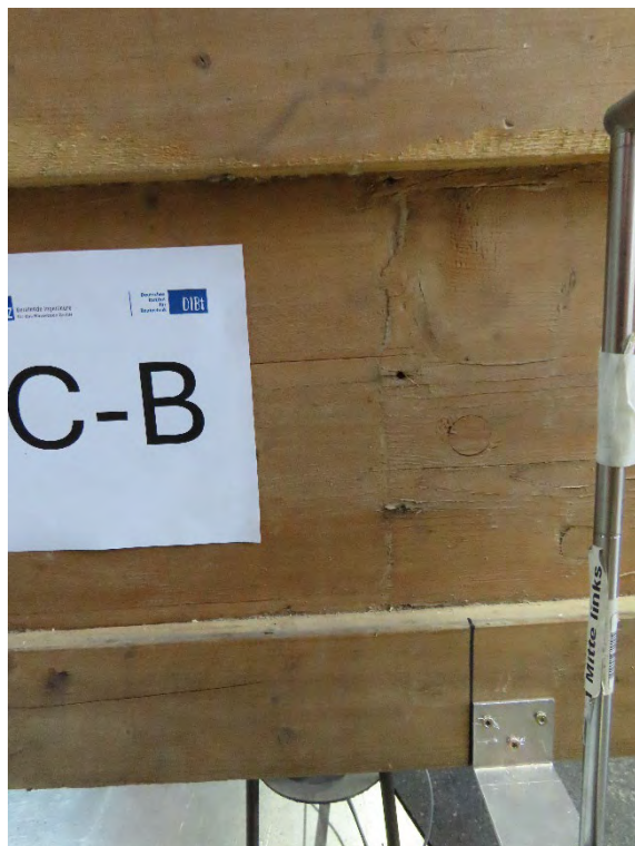
Abbildung A.160: 17C-B Keilzinkung Trägerseite a vor der Prüfung
