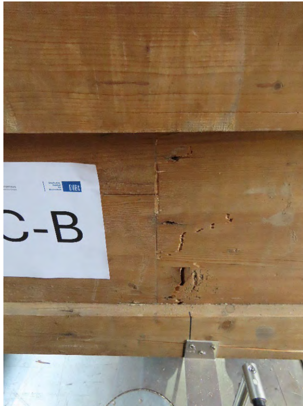
Abbildung A.201: 16C-B Keilzinkung Trägerseite a Biegezugversagen
