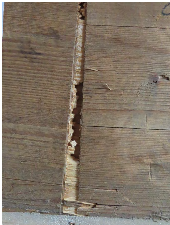
Abbildung A.170: 25F-B Keilzinkung Trägerseite b Biegezugversagen
