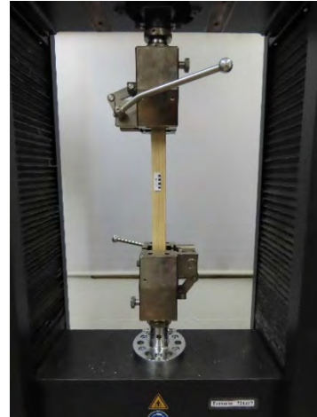
Abbildung 3.7: Zugprüfkörper in der Universalprüfmaschine a) mit Keilzinkung, b) ohne Keilzinkung
