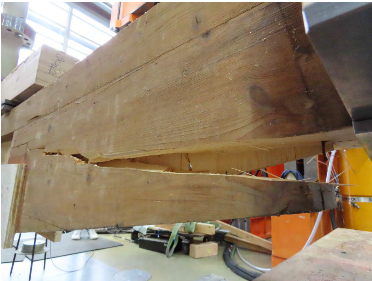
Abbildung A.163: 17C-B Schubversagen Trägerseite b, Ausziehen der Zwischenschicht mit geringerem Klebstoffauftrag
