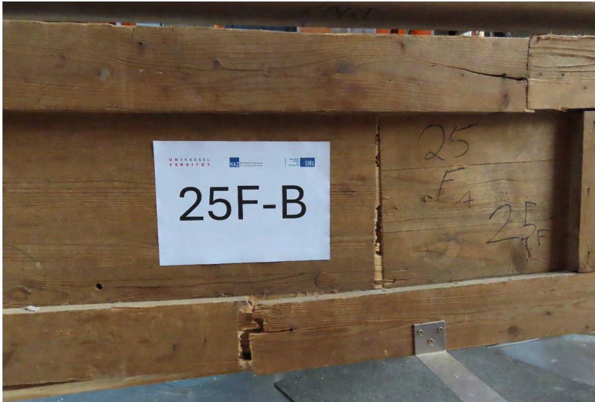
Abbildung A.171: 25F-B Trägerseite b Gurtlammellenversagen
