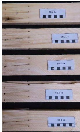
Abbildung A.1: 9B-Z-a vor der Prüfung
