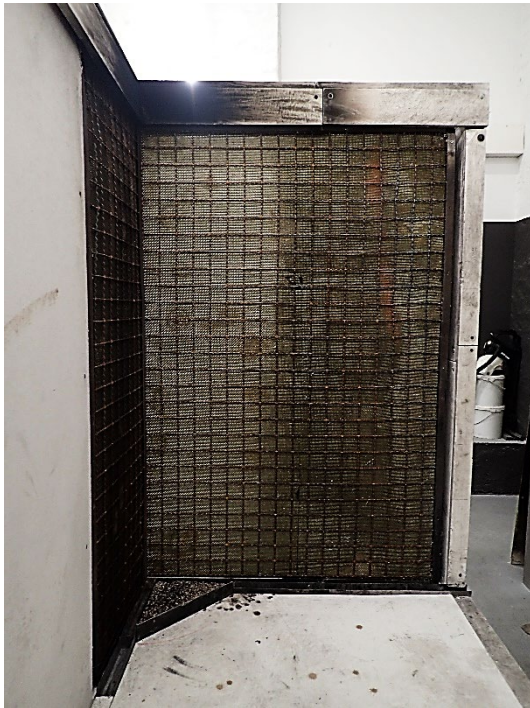
Foto 21: Probekörper MW-EU-EU, Ansicht des großen Flügels vor der Brandprüfung.
