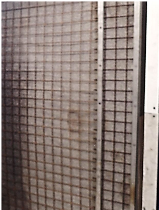
Foto 35: Probekörper Zt-EU-EU, Detailansicht des breiten Probenflügels in Höhe von 500 mm in einem Winkel von ca. 45° vor der Brandprüfung.
