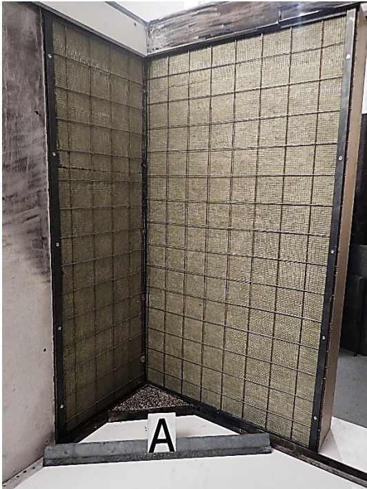
Foto 25: Probekörper MW-Ö-Ö, Ansicht des großen Flügels vor der Brandprüfung.
