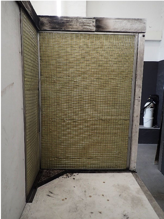
Foto 29: Probekörper MW-L-L, Ansicht des großen Flügels vor der Brandprüfung.
