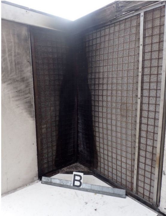
Abbildung 2: Ansicht des mit Zellulose-Einblasdämmstoff gefüllten EU-Korbs im SBI-Probenträgerwagen eingebaut.
