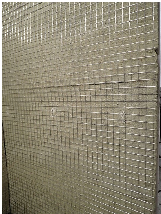
Foto 15: Probekörper MW-L-O, Detailansicht des breiten Probenflügels in Höhe von 500 mm in einem Winkel von ca. 45° vor der Brandprüfung.
