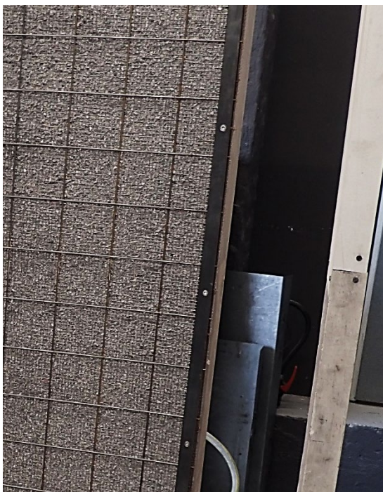
Foto 39: Probekörper Zt-Ö-Ö, Detailansicht des breiten Probenflügels in Höhe von 500 mm in einem Winkel von ca. 45° vor der Brandprüfung.
