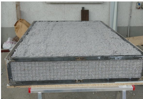
Abbildung 16: Abgewogener Dämmstoff eingeblasen und festgedrückt.
