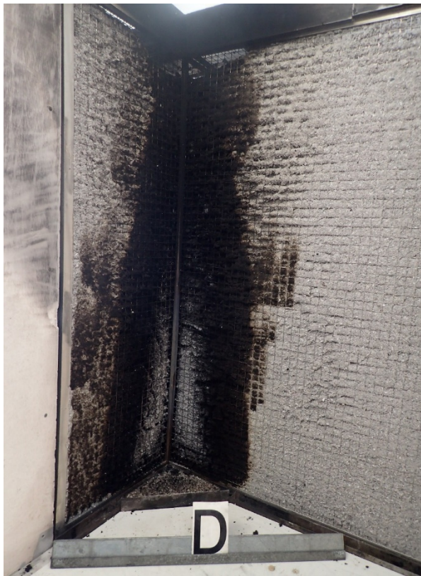
Abbildung 46: Ansicht nach der Prüfung, L-Korb
