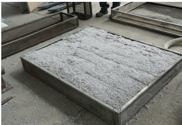
Abbildung 14: Dämmstoff in Probenhalter eingepresst.
