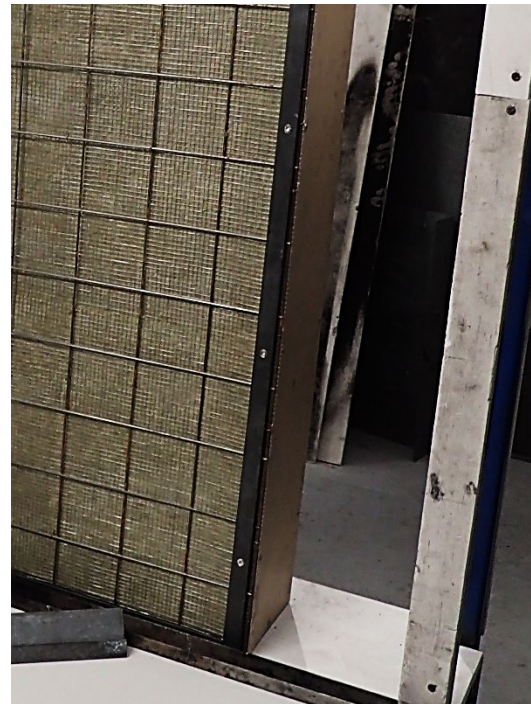
Foto 26: Probekörper MW-Ö-Ö, Detailansicht des Gitters vor der Brandprüfung.
