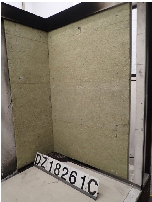
Foto 11: Probekörper MW-O-O, Ansicht des Probekörpers in einem Winkel von ca. 45° vor der Brandprüfung.
