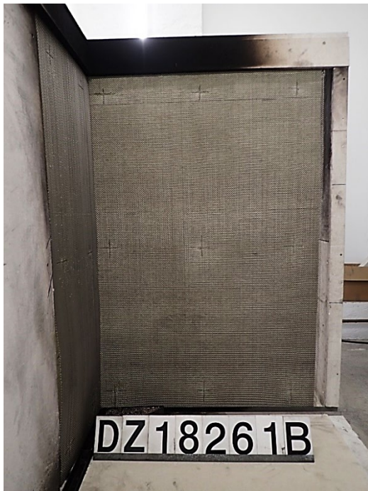
Foto 5: Probekörper MW-EUf-O, Ansicht des großen Flügels vor der Brandprüfung.
