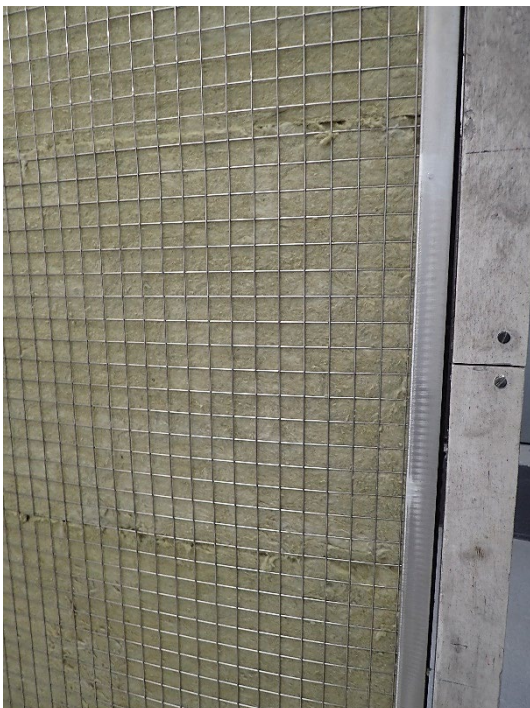
Foto 31: Probekörper MW-L-L, Detailansicht des breiten Probenflügels in Höhe von 500 mm in einem Winkel von ca. 45° vor der Brandprüfung.
