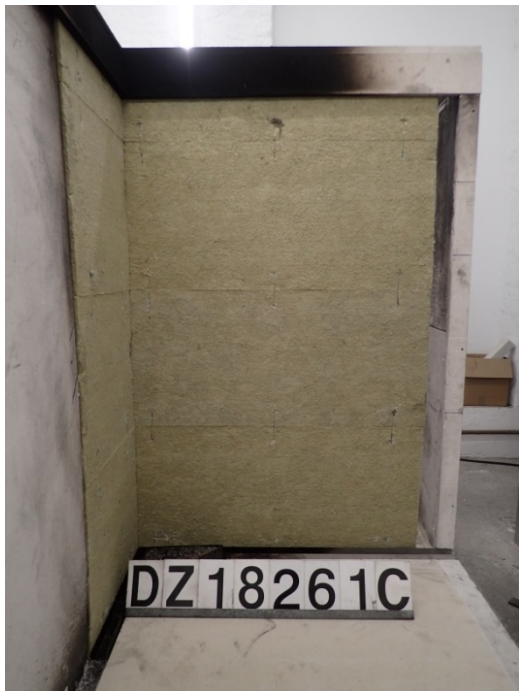
Foto 9: Probekörper MW-O-O, Ansicht des großen Flügels vor der Brandprüfung.
