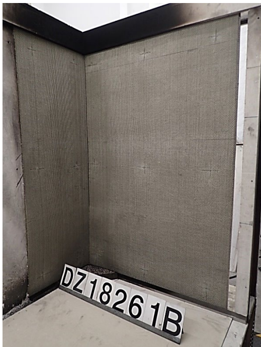
Foto 7: Probekörper MW-EUf-O, Ansicht des Probekörpers in einem Winkel von ca. 45° vor der Brandprüfung.
