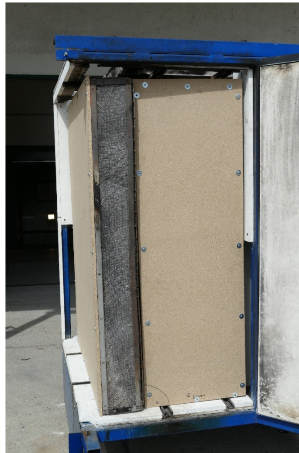
Abbildung 15: Probenhalter mit Trägerplatten (in diesem Fall Holzspanplatten nach DIN EN 13238: 2010-06 [4]) verschlossen.
