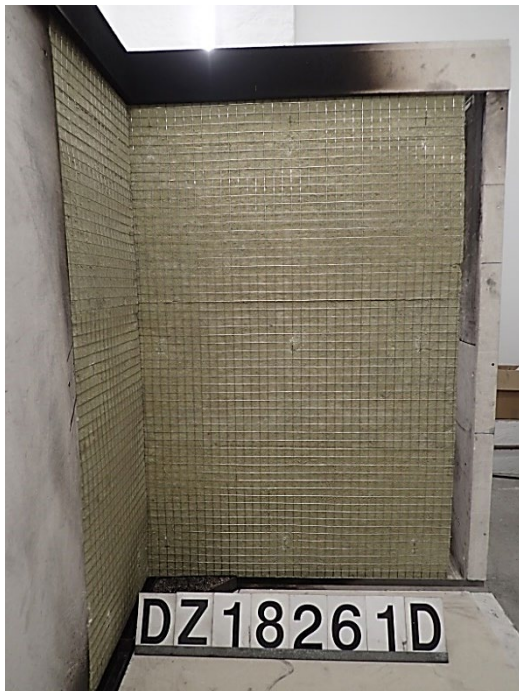
Foto 13: Probekörper MW-L-O, Ansicht des großen Flügels vor der Brandprüfung.
