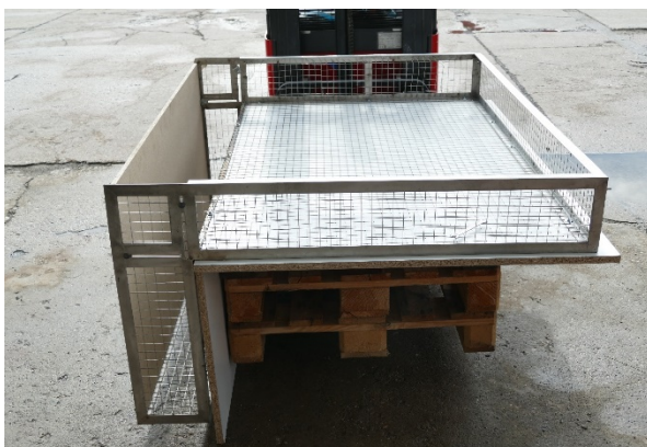
Abbildung 20: Ansicht des für die Verfüllung vorbereiteten L-Korbs.
