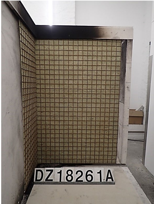
Foto 1: Probekörper MW-EUg-O, Ansicht des großen Flügels vor der Brandprüfung.
