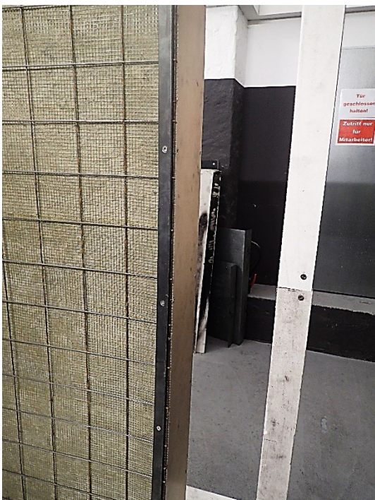
Foto 27: Probekörper MW-Ö-Ö, Detailansicht der Außenkante des breiten Probenflügels in Höhe von 500 mm in einem Winkel von ca. 45° vor der Brandprüfung.
