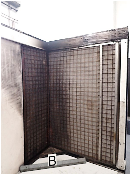
Foto 33: Probekörper Zt-EU-EU, Ansicht des großen Flügels vor der Brandprüfung.
