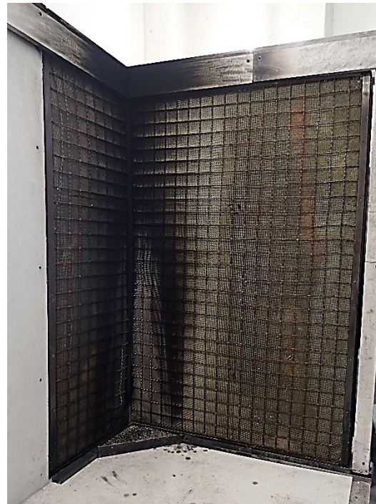
Foto 24: Probekörper MW-EU-EU, Ansicht nach der Prüfung.
