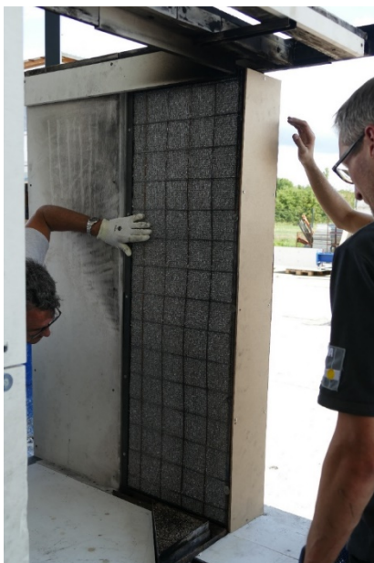
Abbildung 18: Kleinen und großen Flügel nacheinander in SBI-Probenträgerwaagen eingebaut.
