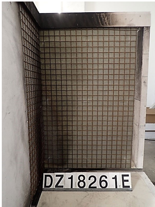
Foto 17: Probekörper MW-EUgf-O, Ansicht des großen Flügels vor der Brandprüfung.
