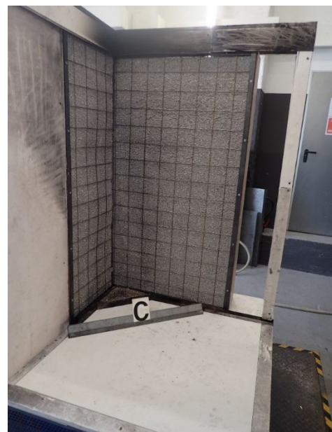
Abbildung 19: Ansicht des fertig eingebauten Ö-Korbs im SBI-Probenträgerwaagen.
