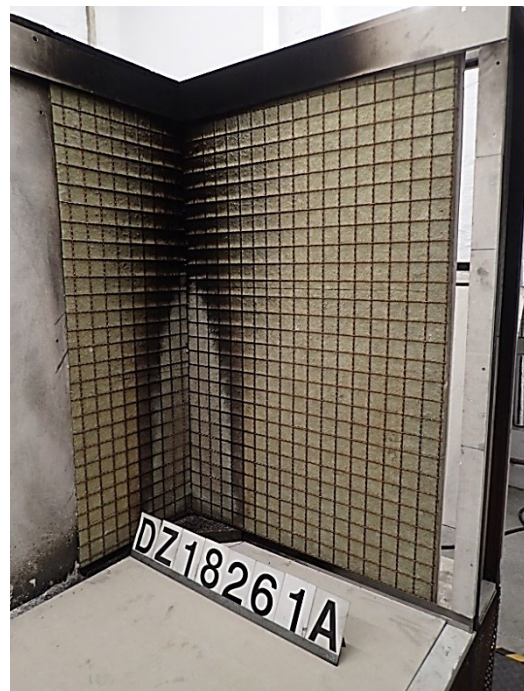
Foto 4: Probekörper MW-EUg-O, Ansicht nach der Prüfung.
