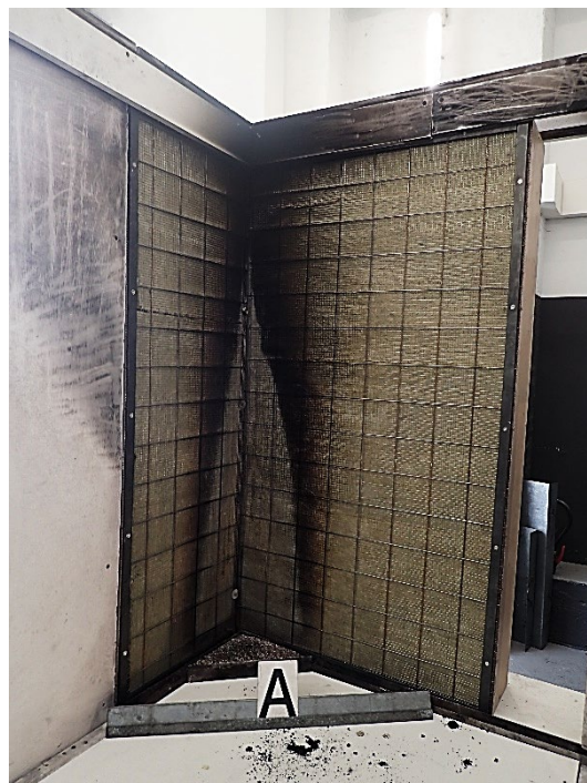
Foto 28: Probekörper MW-Ö-Ö, Ansicht nach der Prüfung.
