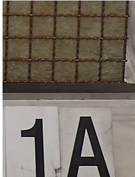
Foto 2: Probekörper MW-EUg-O, Detailansicht des Gitters vor der Brandprüfung.
