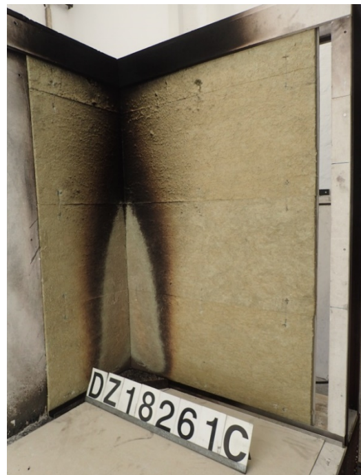
Foto 12: Probekörper MW-O-O, Ansicht nach der Prüfung.
