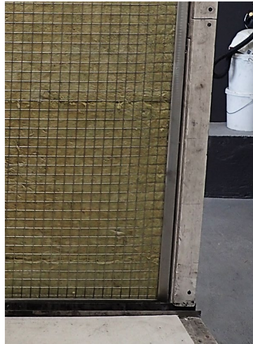
Foto 30: Probekörper MW-L-L, Detailansicht des Gitters vor der Brandprüfung.
