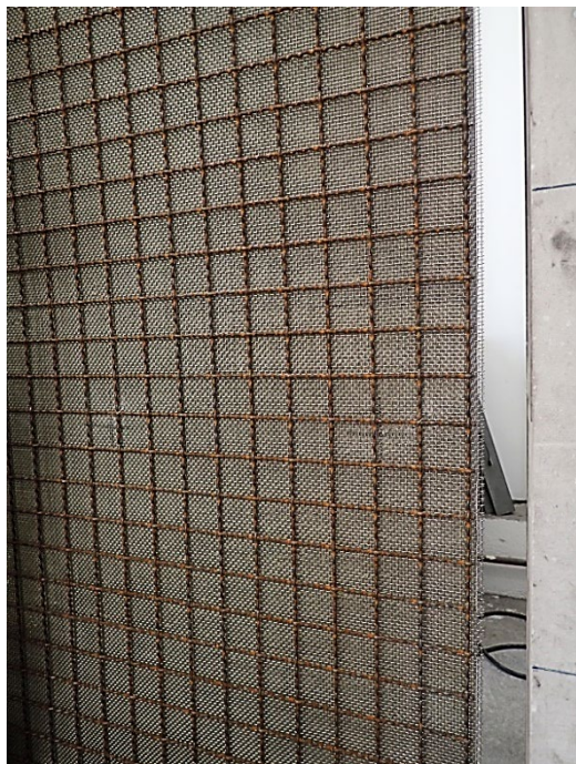
Foto 19: Probekörper MW-EUgf-O, Detailansicht des breiten Probenflügels in Höhe von 500 mm in einem Winkel von ca. 45° vor der Brandprüfung.
