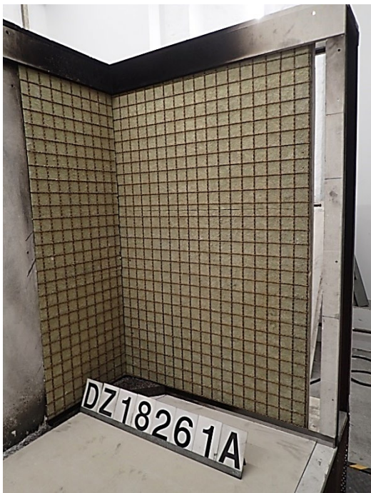
Foto 3: Probekörper MW-EUg-O, Ansicht des Probekörpers in einem Winkel von ca. 45° vor der Brandprüfung.
