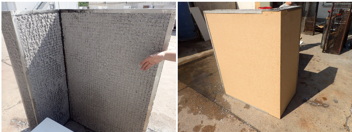
Abbildung 4: Ansicht der beflamten Seite (links) und der Rückseite (rechts) des L-Korbs.
