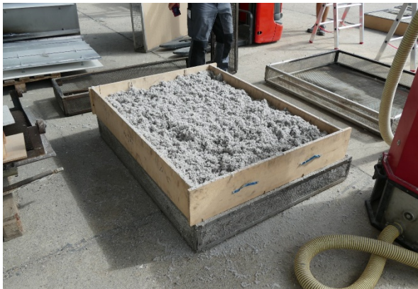
Abbildung 13: Abgewogene Menge Zellulose-Dämmstoff eingeblasen.
