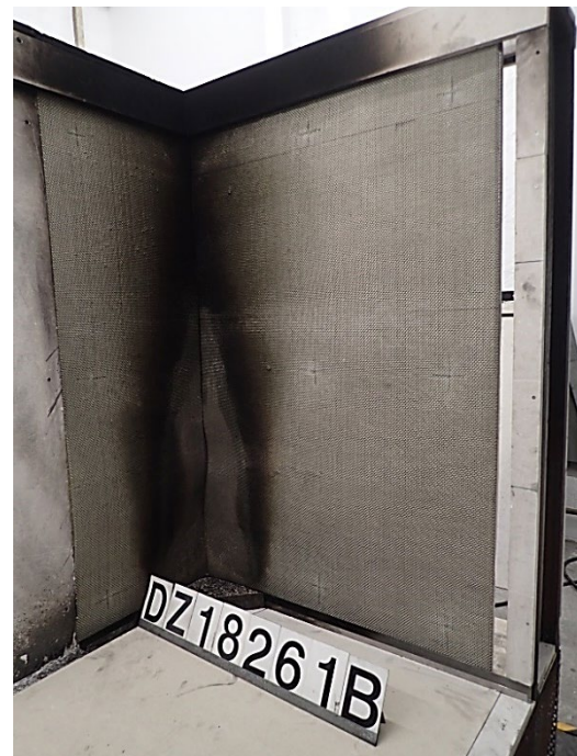
Foto 8: Probekörper MW-EUf-O, Ansicht nach der Prüfung.
