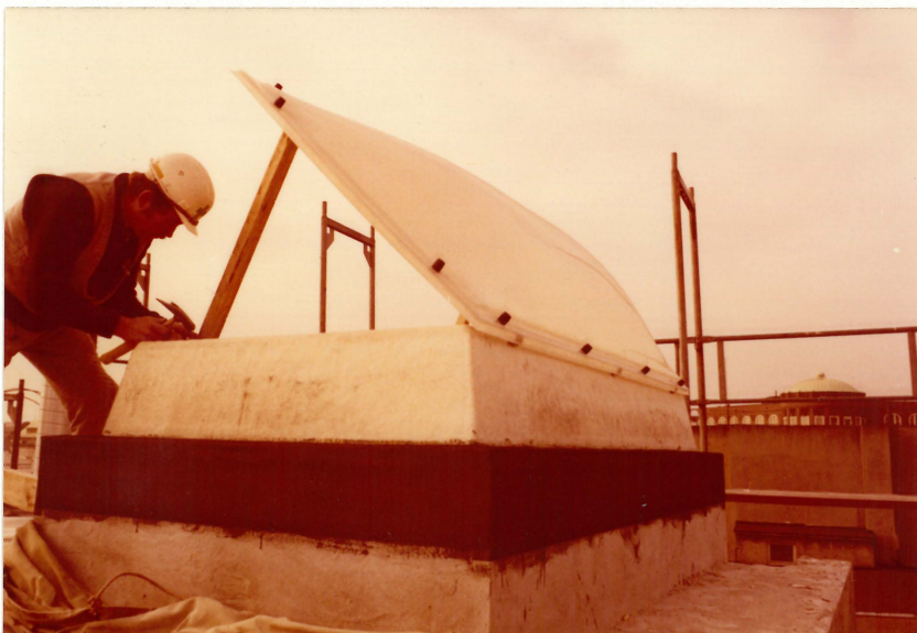
Bild 5 Öffnungswinkel der Lichtkuppel beim Brandversuch
