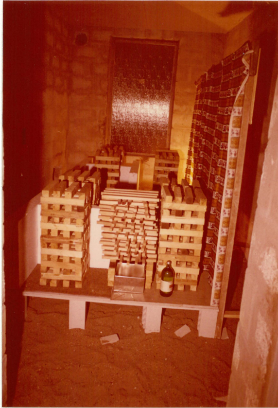
Bild 3 Brandraum mit Brandlastpalette Brandlast ca. 180 kg
