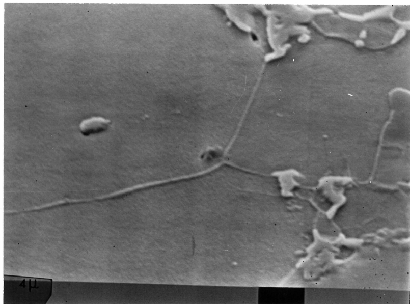
Bild 12. GEFÜGE DES BETONSTAHLS III K, BELEGUNG DER KÖRNER MIT ZEMENTIT
