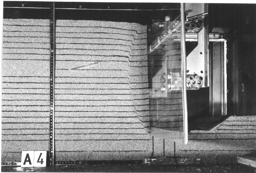
Abb. 3.12: Versuch A4: Starrkörperbruch
