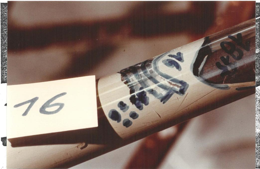
Bild 5.8 Mit Macflow verpreßter Spannkanal am Hochpunkt
