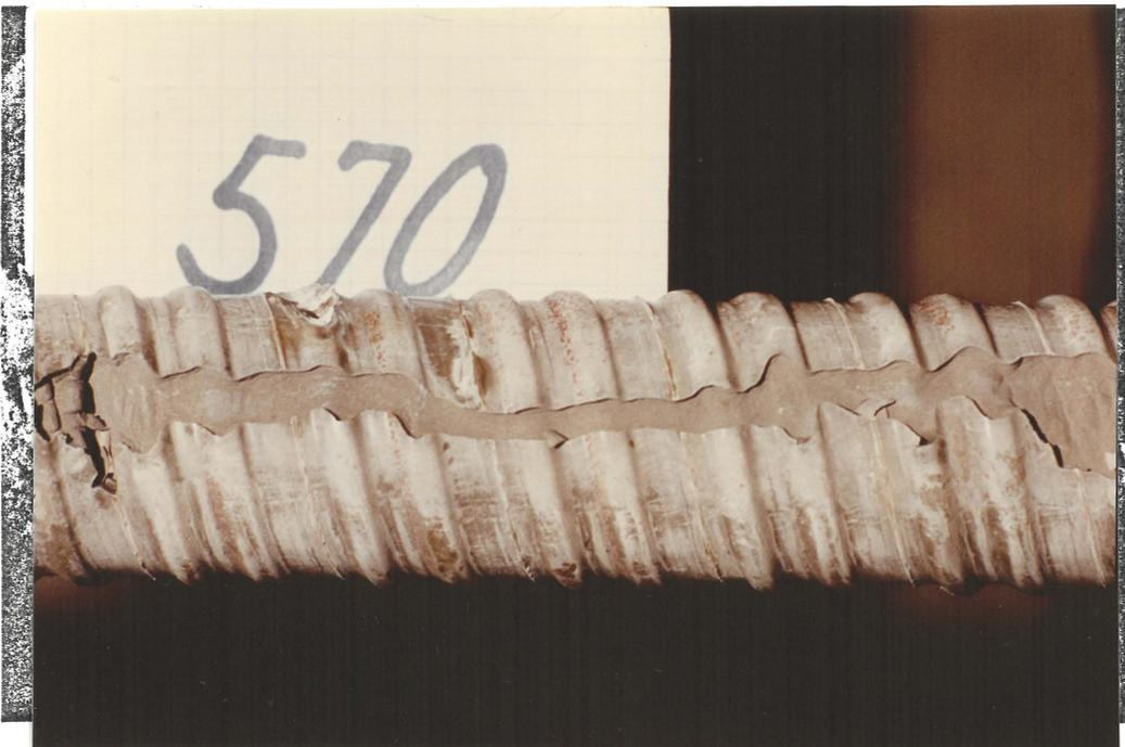
Bild 4.8 und 4.9 Kanal oben vor, unten nach dem Entfernen der Zementhaut
