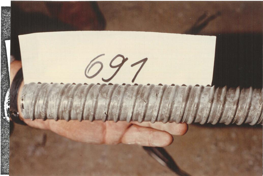
Bild 4.6 Mit MacFlow verpreßter Spannkanal
