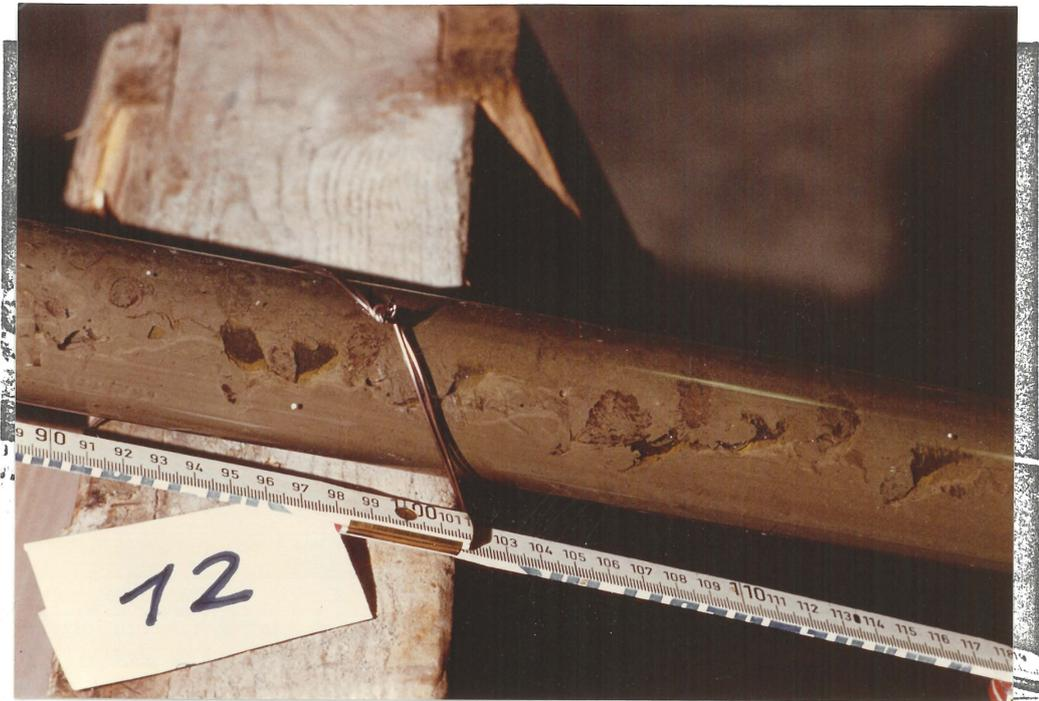
Bild 5.9 Örtliche Wasseransammlungen bei normal verpreßtem, ohne Druck verschlossenem Spannkanal
