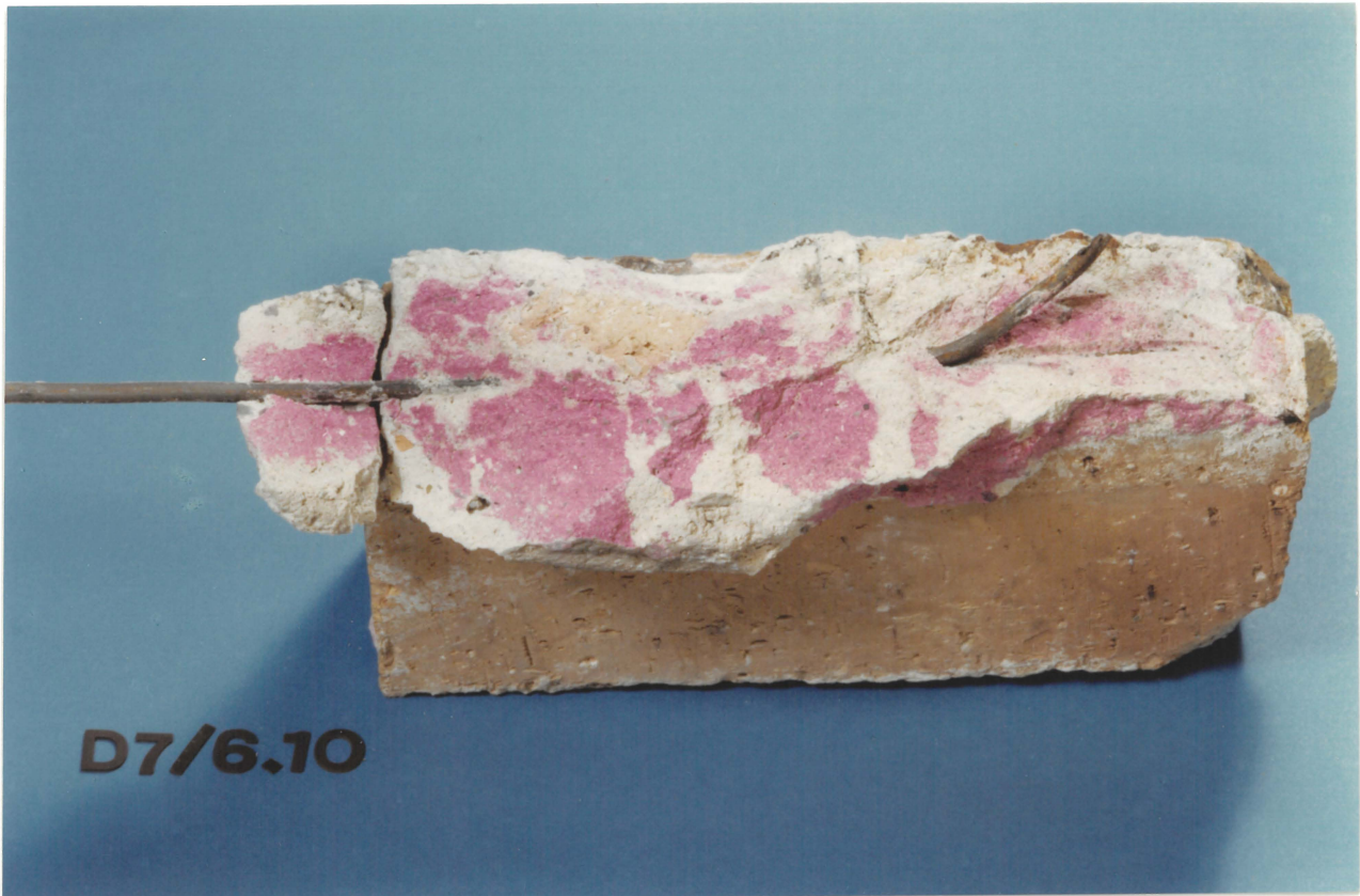
Bild 8. Ziegelprobe mit Mörtel und eingebetteter Bewehrung BAM-Proben-Nr. 8
